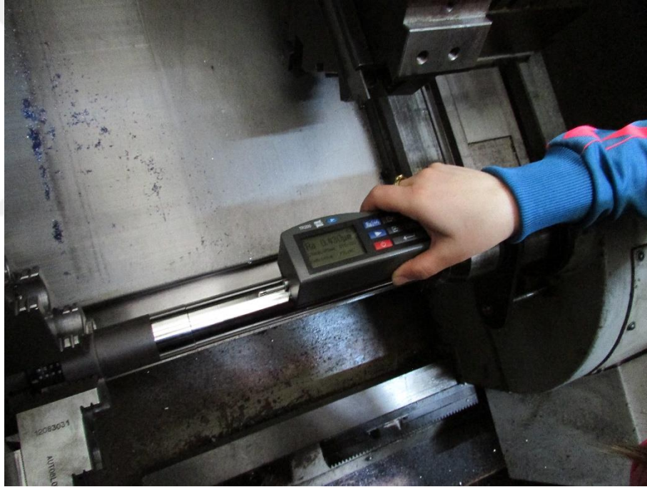
Şekil 4.4. Tornalama deneyi sonrasında pürüzlülük ölçümü.
