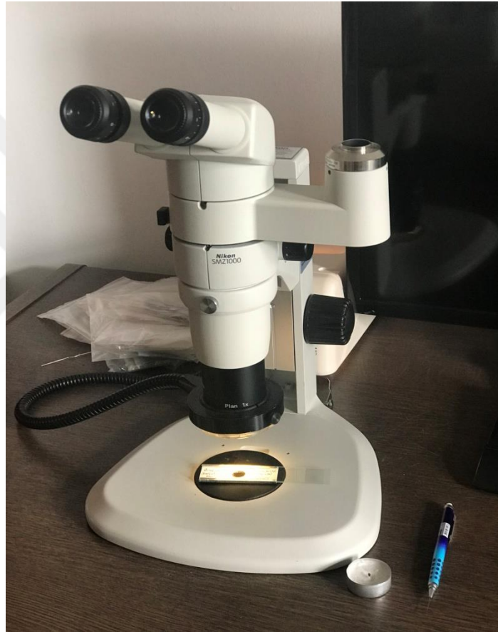
Şekil 1.6. SMZ-1000 marka mikroskop altında, tablaya dökülen örneklerin iğne yardımıyla planktonik foraminifer ve ostrakod içeriğinin tanımlanması.
