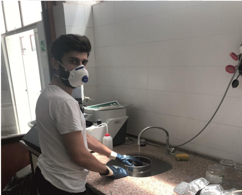
Şekil 1.4. Kimyasal işlemler ile hazırlanan örneklerin bol suyla yıkanması.
