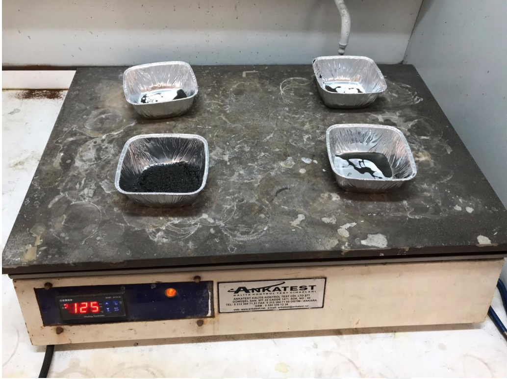
Şekil 1.5. Tazyikli suyla yıkanan örneklerin çeker ocak yardımıyla kurutulması.
