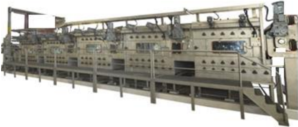
Şekil 5.7. Isı geri kazanımda ısıtılan suyun kullanıldıęı beř kabinli kontiner yıkama makinesi.
