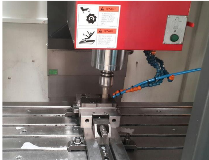
Şekil 6.3. Frezeleme deneyi sırasında MMY püskürtme konumu.
