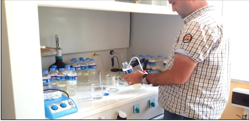
Şekil 3.4. Kullanılan çözeltilerin pH değerlerinin belirlenmesi.
