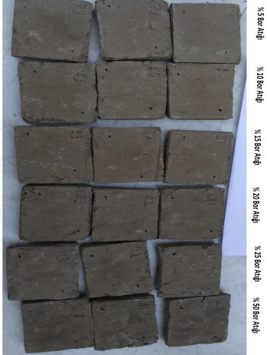
Ek 5.2. 106 °C de etüvde 4 saat bekletilen kiremit çamurunun kuruduktan sonraki hali
