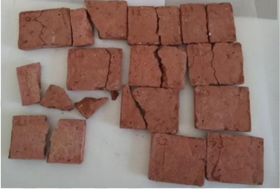
Ek 5.3. 820 C’de pişen numunelerin mukavemet testinden geçtikten sonraki durumları
