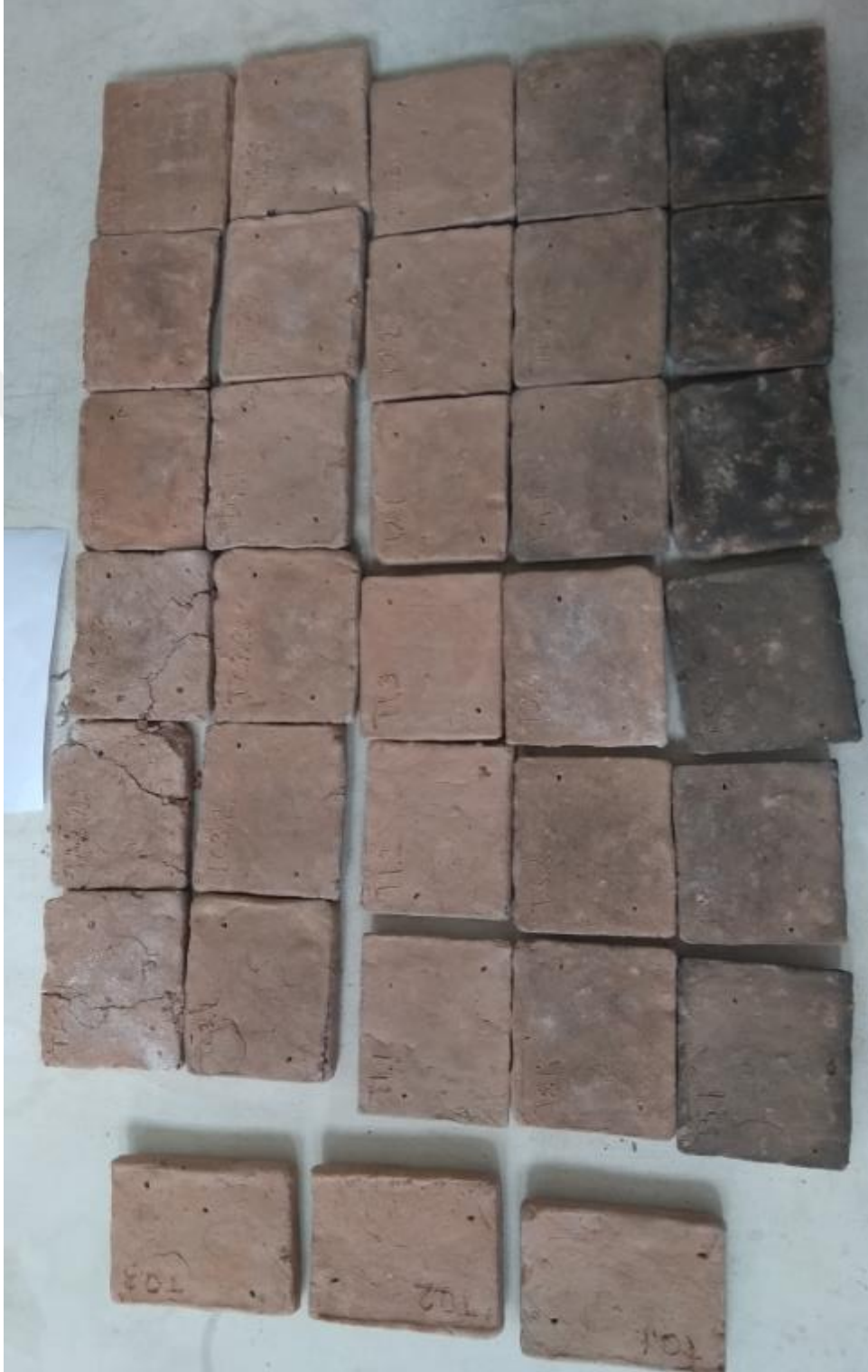
Ek 6.3. 530 °C'de pişen nihai atık katkı ve dekrepite olmayan bor atığı katkı numunelerin görüntüleri
