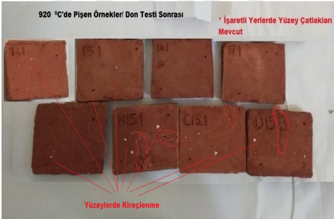
Şekil 6.3. 920 °C'de pişen nihai atık katkıli ve dekrepite olmayan bor atığı katkıli numunelerin don testinden geçtikten sonraki görüntüleri.
