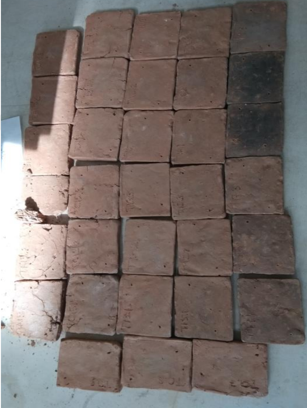
Ek 6.5. 630 °C'de pişen nihai atık katkı ve dekrepite olmayan bor atığı katkı numunelerin görüntüleri
