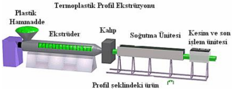
Şekil 2.9. Ekstrüzyon üretim yöntemi (Ekşi, 2007).
