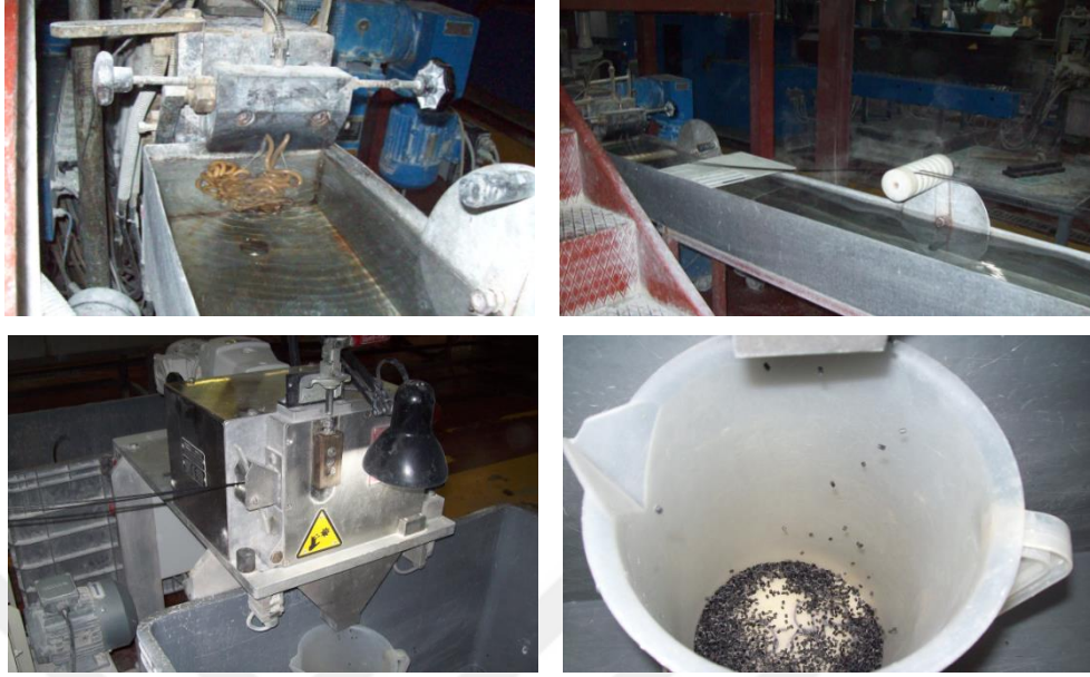
Şekil 3.7. Ekstruder uç kalıbından çıkan malzemenin soğutulması ve ardından kırıcıda tekrar granül haline getirilmesi.
