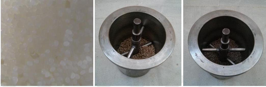
Şekil 3.5. PA6 ve kırık KE'nin karıştırılması.
