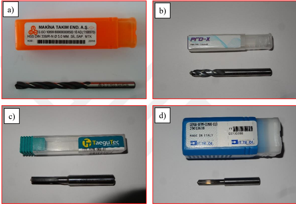
Şekil 3.13. a) HSS matkap, b) karbür matkap, c) kaplamalı karbür matkap, d) PCD matkap.
