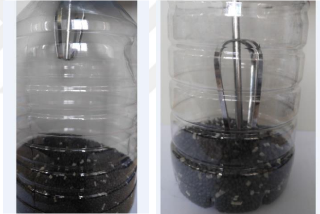
Şekil 3.6. Alkol solüsyonlu ÇDKNT'ün ve PA6 ile karıştırılması.
