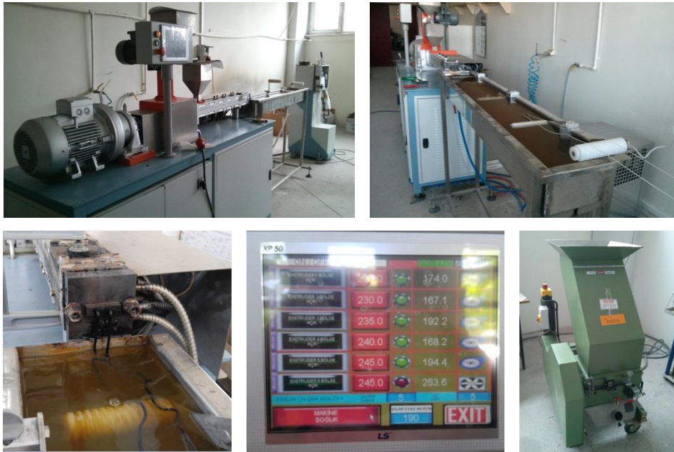
Şekil 3.8. ÇDKNT ve PA6 polimerinin kompozit olarak hazırlandığı ekstruder üretim süreci.
