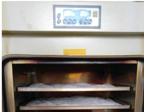
Şekil 3.4. PA6 malzemesinin etüv fırınında kurutulması.
