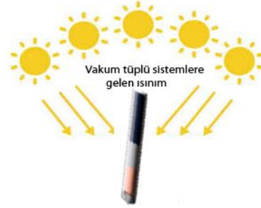
Şekil 3.5. Vakum tüpe gün içinde çeşitli zamanlarda gelen güneş ışınımı.
