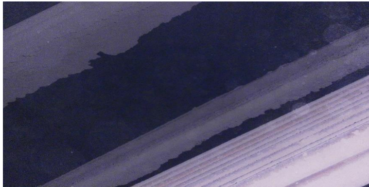
Şekil 5.7. Kazan kızdırcıların da meydana gelen cüruf.
