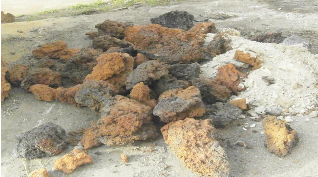
Şekil 5.3. Kazan içerisinde meydana gelen cüruf.
