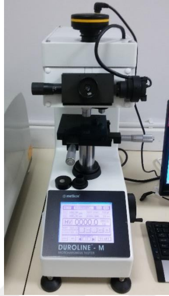
Şekil 6.13. Sertlik ölçümlerinde kullanılan cihaz.
