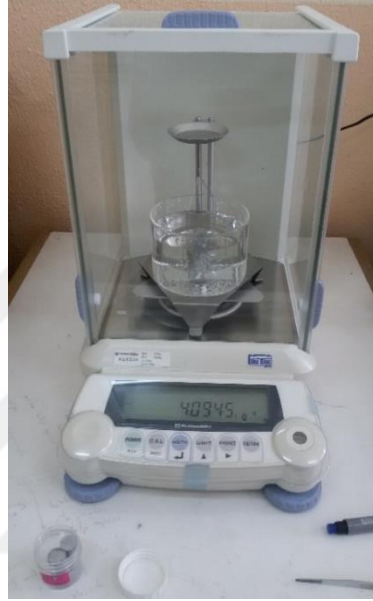
Şekil 6.12. Yoğunluk ölçümlerinde kullanılan hassas terazi ve yoğunluk ölçüm kiti.
