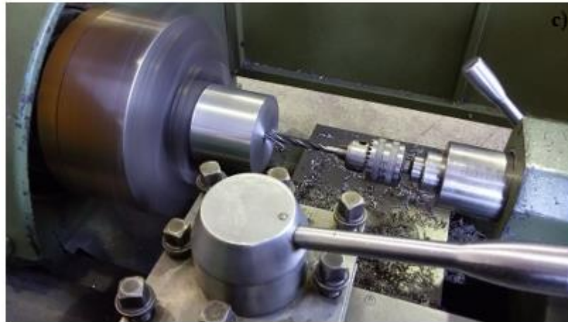
Şekil 6.7. Kalıp üretimi; a) İşlenmek üzere torna aynasına bağlanmış olan kalıp malzemesi. b) ve c) Kalıp malzemesinde kalıp boşluğunun oluşturulması.
