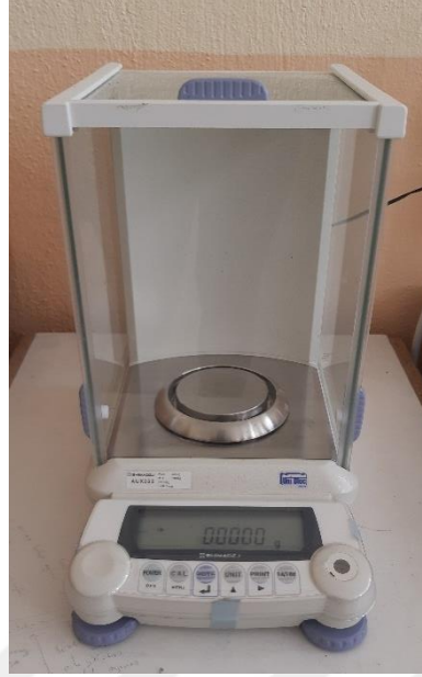
Şekil 6.5. Toz karışımların hazırlanmasında kullanılan hassas terazi.
