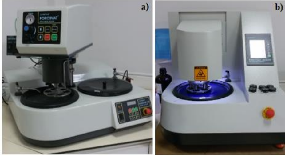
Şekil 6.16. a) zımparalama ve b) parlatma işlemlerinin gerçekleştirildiği cihazlar.
