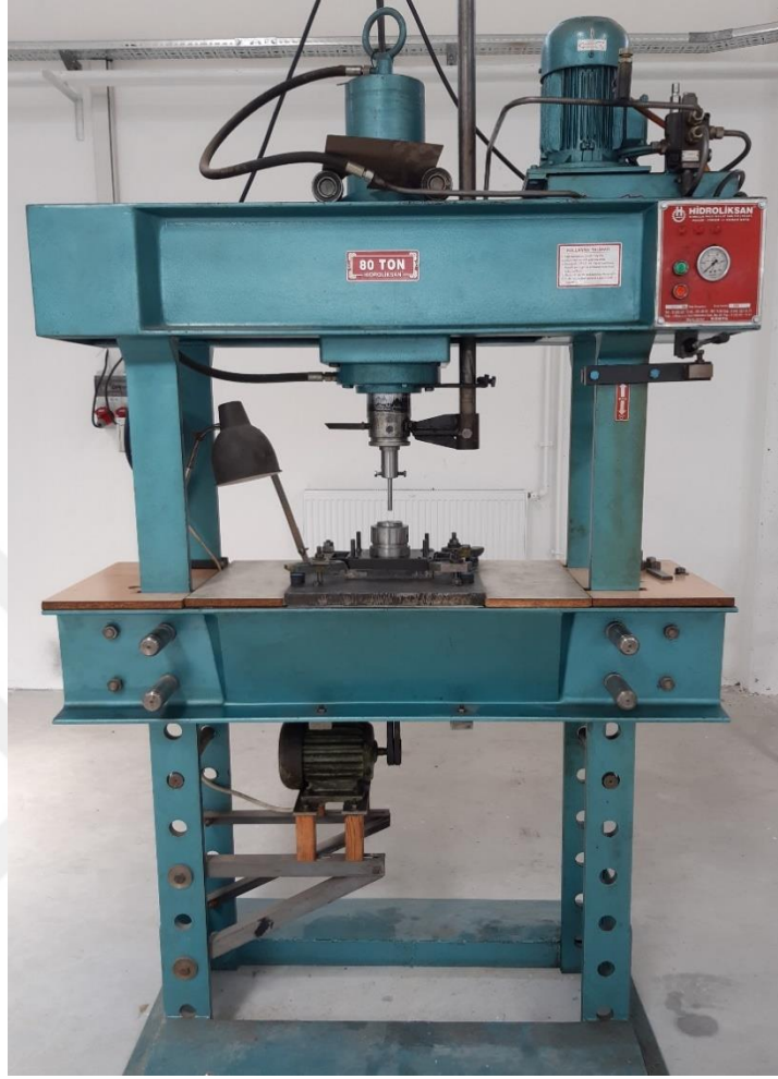
Şekil 6.9. Tozların preslenmesinde kullanılan hidrolik pres.
