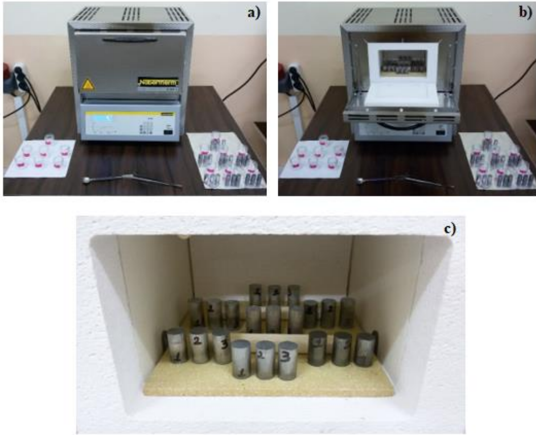
Şekil 6.11. Sinterleme işleminde; a) Kullanılan fırın. b) ve c) Sinterlenmek üzere fırın içerisine yerleştirilmiş olan numuneler.
