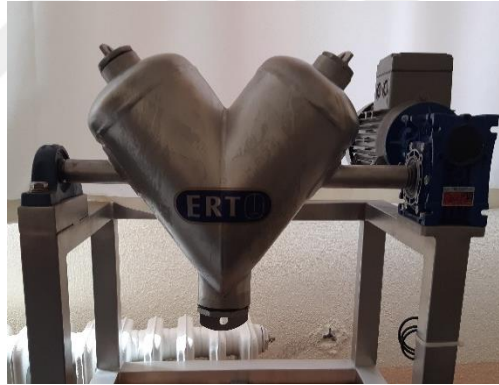
Şekil 6.6. Toz karışımların karıştırılmasında kullanılan karıştırıcı.
