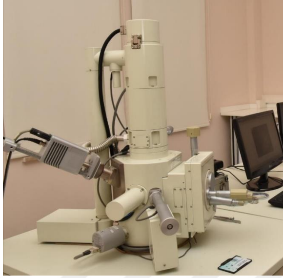
Şekil 6.18. Mikroyapı görüntüleri ve EDX analizlerinin elde edilmesinde kullanılan taramalı elektron mikroskobu (SEM).
