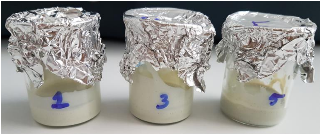
Şekil 4.12. Ağırlıkça %1,%3,%5 oranlarında üretilen vanadyum pentaoksit tozun pastaya eklenmesi.
