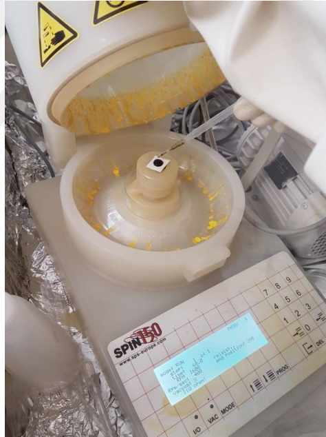
Şekil 4.20. Üretilen V_2O_5 tozunun süspansiyon çözeltisinin kaplama işlemi.
