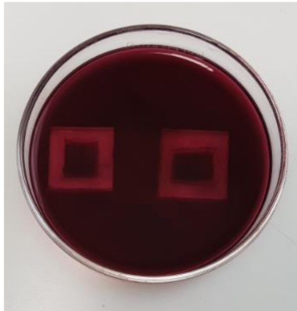
Şekil 5.2. Boya çözeltisi içerisinde bekletilen ince film kaplı anot altlıklar.
