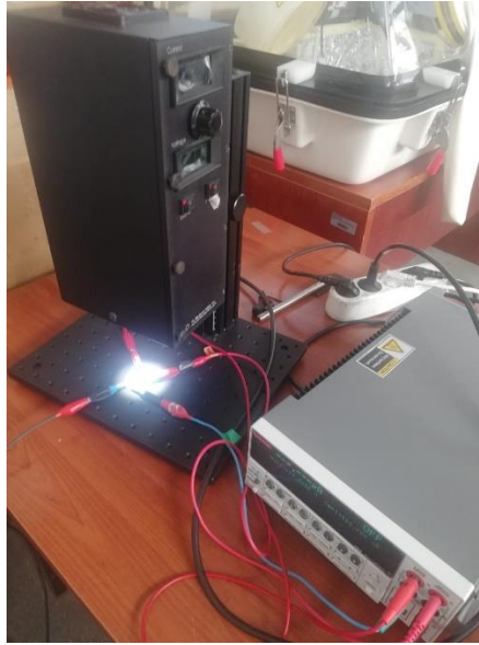
Şekil 5.7. Güneş simülatörü ve Keithley 2400 kaynak ölçer cihazı.
