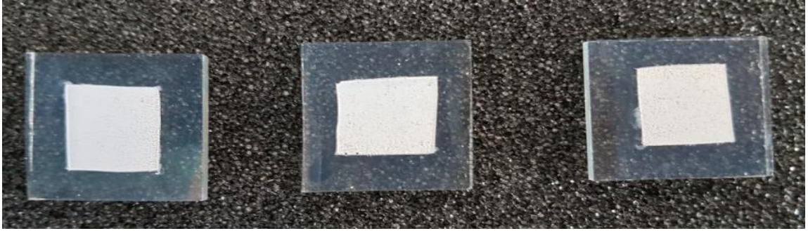
Şekil 4.13. Ağırlıkça %1,%3,%5 oranlarında pastaya eklenen vanadyum pentaoksitli numuneler.
