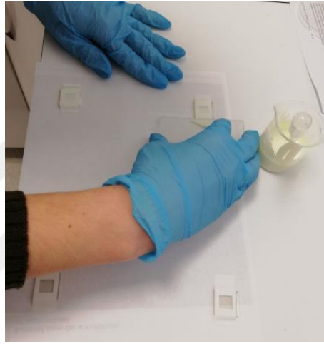
Şekil 4.2. Pastanın sıyırma yöntemiyle FTO anot cam altlığına kaplanması.
