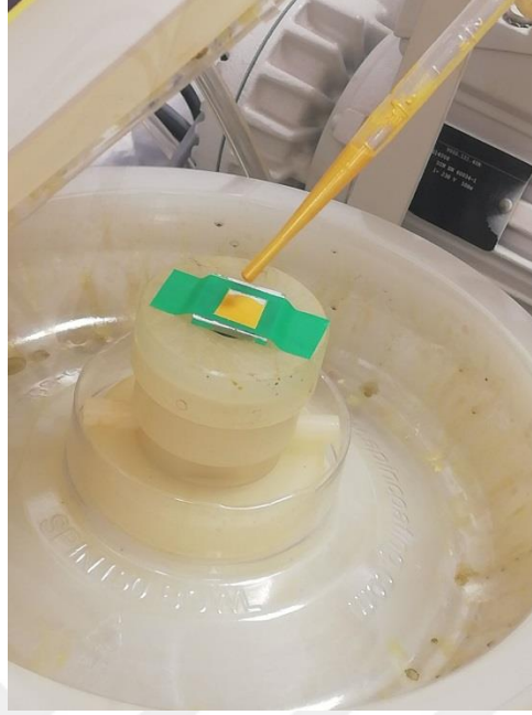
Şekil 4.17. Ticari V_2O_5 tozunun süspansiyon çözeltisinin kaplama işlemi.
