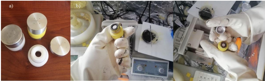
Şekil 5.8. Pilin Argon ortamında glove box içerisinde kapatılması: a) değişik delik çaplarıyla hazırlanan deşarj modülleri; b) glove box içinde VB 2 anot elektrot, KOH elektrolit ve PTFE/O 2 seçici membranın modül içine konulması; c) Pilin deşarj deneylerinde ölçüm almak üzere kapatılması.
