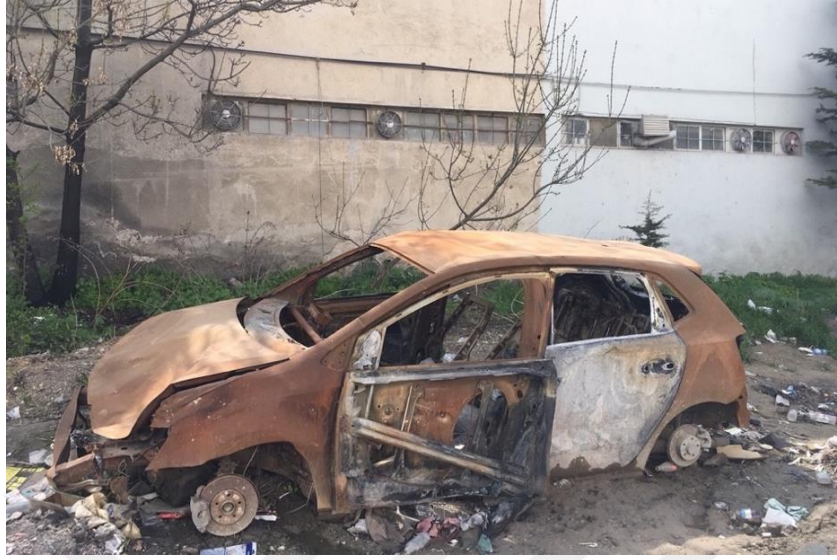
Şekil 2.6. Kaportası yanma sonucu tamamen korozyona uğramış bir otomobil.
