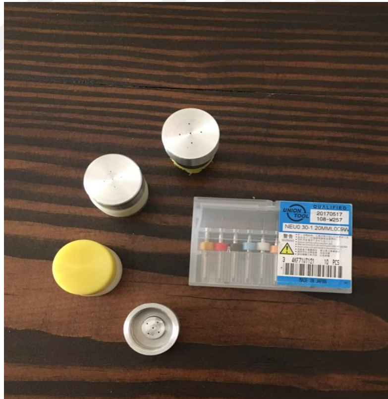
Şekil 5.7. Değişik hava deliği çaplarıyla hazırlanan deşarj modülleri.
