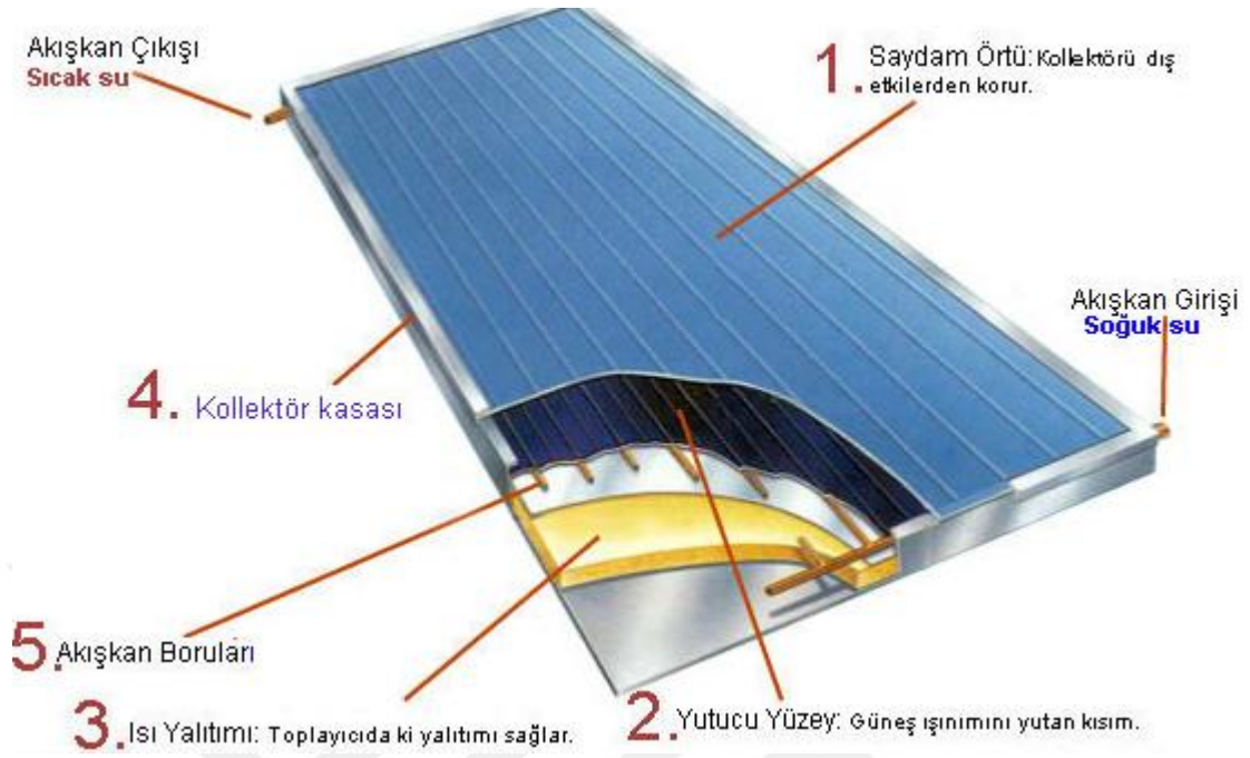
Şekil 4.11. PV/T Su kolektörlerinin yapısı.
