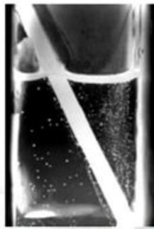
Şekil 9.5. AZS ve alfa beta yüksek alümina refrakterlerin gözenekten sızıntı testi görüntüleri.
