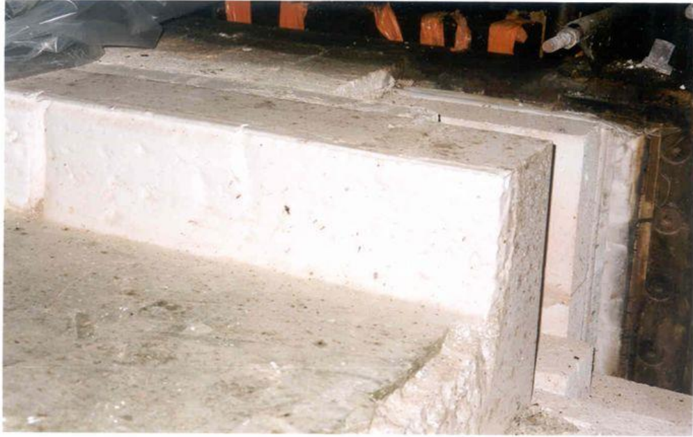
Şekil 12.3. Alfa beta yüksek alumina kullanılmış bir fırının kanal taşlarının kampanya ömrü sonrası görünümü, tekrar kullanılabilir durumda olduğu görülüyor.
