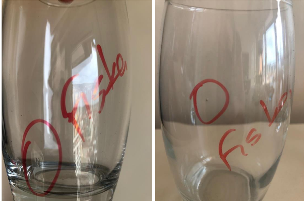
Şekil 9.3. Fıska hatalarına sahip cam bardak ürünler.
