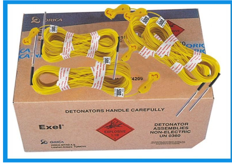
Şekil 2.10. Nonel kapsüller (www.órica.com).
