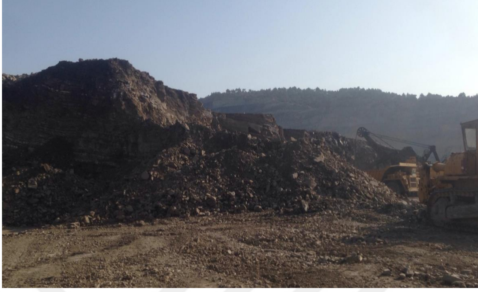
Şekil 5.2. Verimsiz patlatma sonucu oluşan tırnak görüntüsü.
