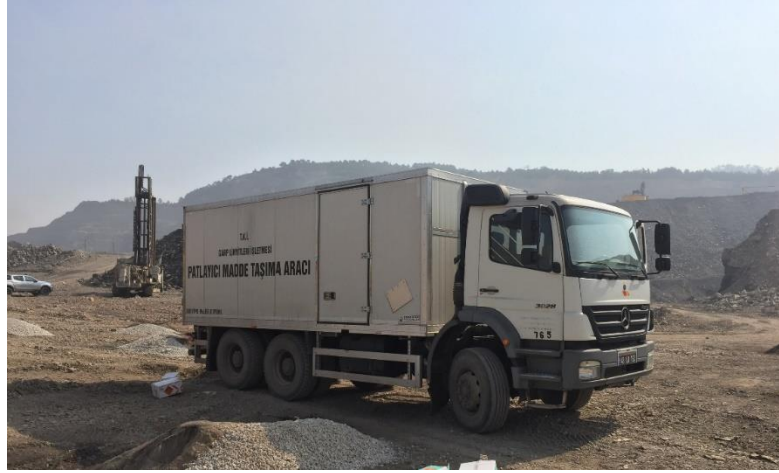
Şekil 4.5. ADR standartlarına uygun, patlayıcı taşıma aracı.
