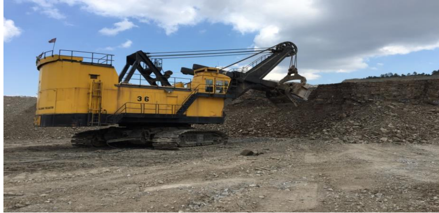
Şekil 4.2. PH 2300 elektrikli shovel.
