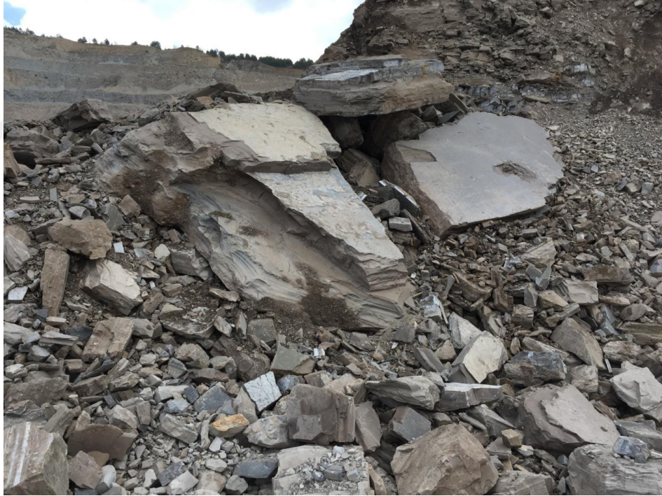
Şekil 5.3. Verimsiz patlatma sonucu oluşan iri bloklar.
