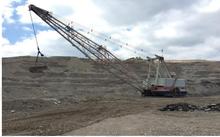
Şekil 4.1. Marion marka dragline.
