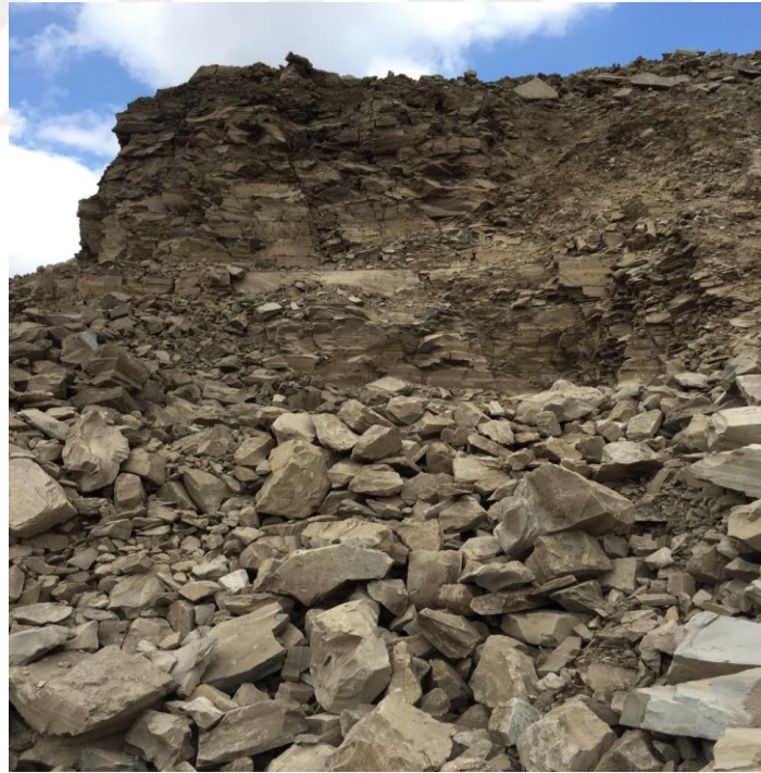
Şekil 5.1. Verimsiz patlatma sonrası sert çıkan ayna görüntüsü.
