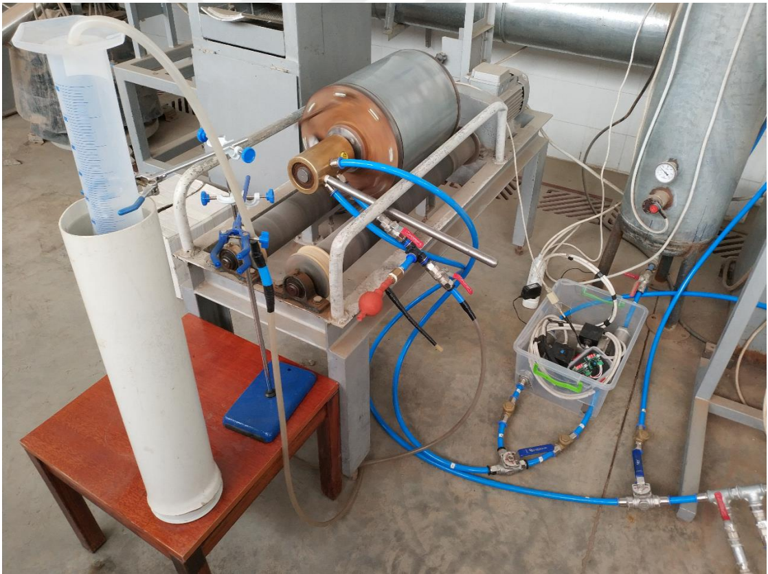
Şekil 6.4. Kalıntı gaz miktarının belirlenmesi.
