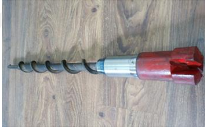
Şekil 5.11. Spiral burguya kaynak ile birleştirilmiş 65 mm çaplı 3 kanatlı delici uç.
