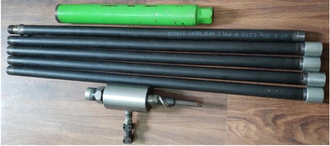
Şekil 5.12. Sulu sondajda kullanılan aparat, tijler ve karotiyer.
