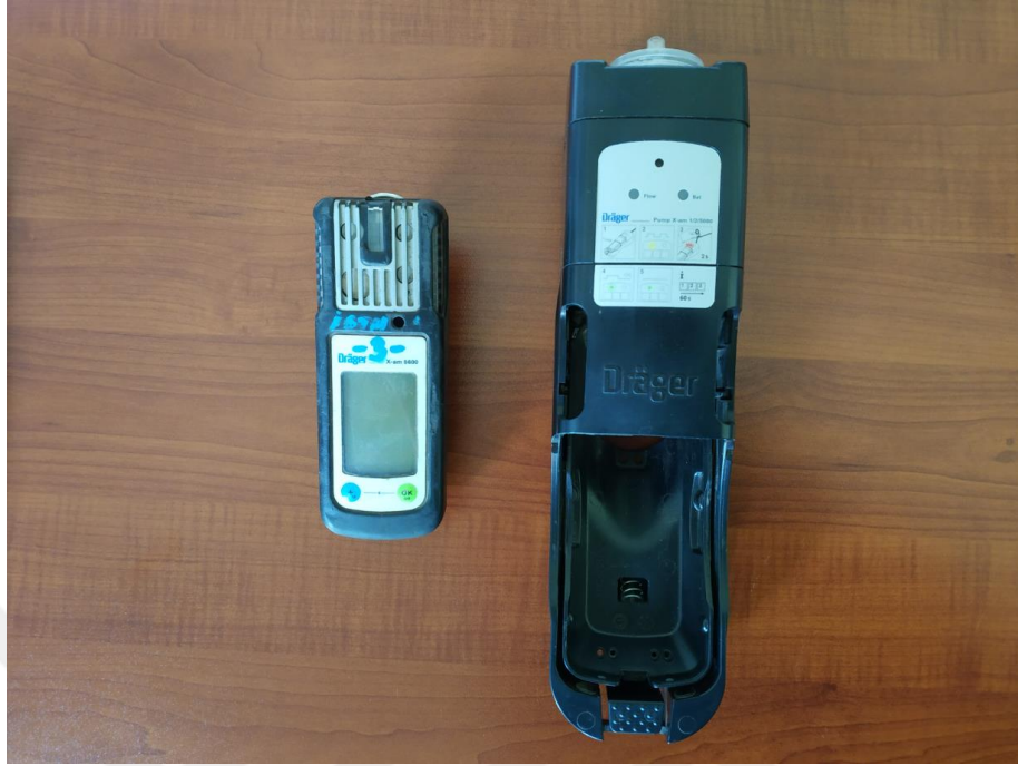
Şekil 5.15. Dräger X-am 5600 mobil gaz ölçüm dedektörü ve opsiyonel harici pompası.
