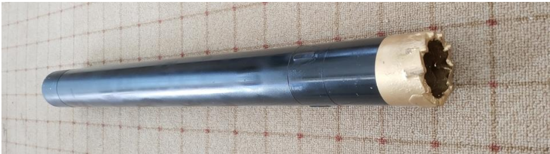
Şekil 5.13. Yumuşak zeminde kullanıma uygun özel imal edilen karotiyer.
