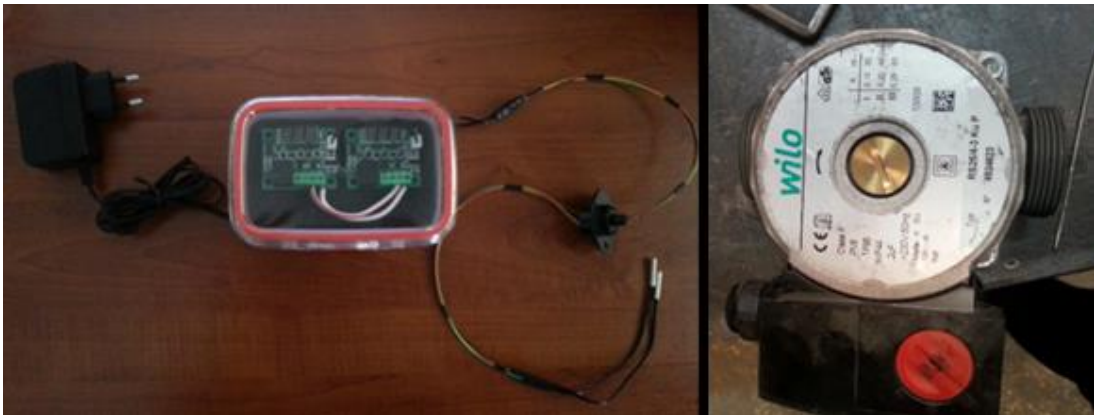
Şekil 5.7. Isı kontrol devreleri ve sirkülasyon pompası.
