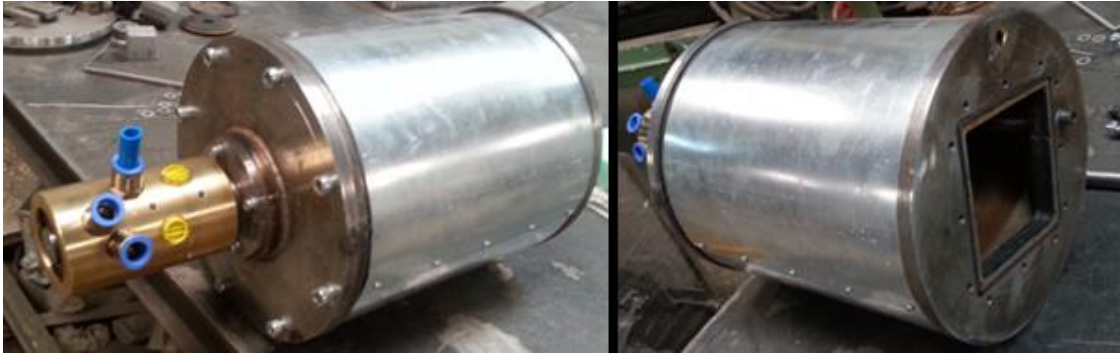
Şekil 5.3. Sızdırmaz kap imalatının son aşamaları.
