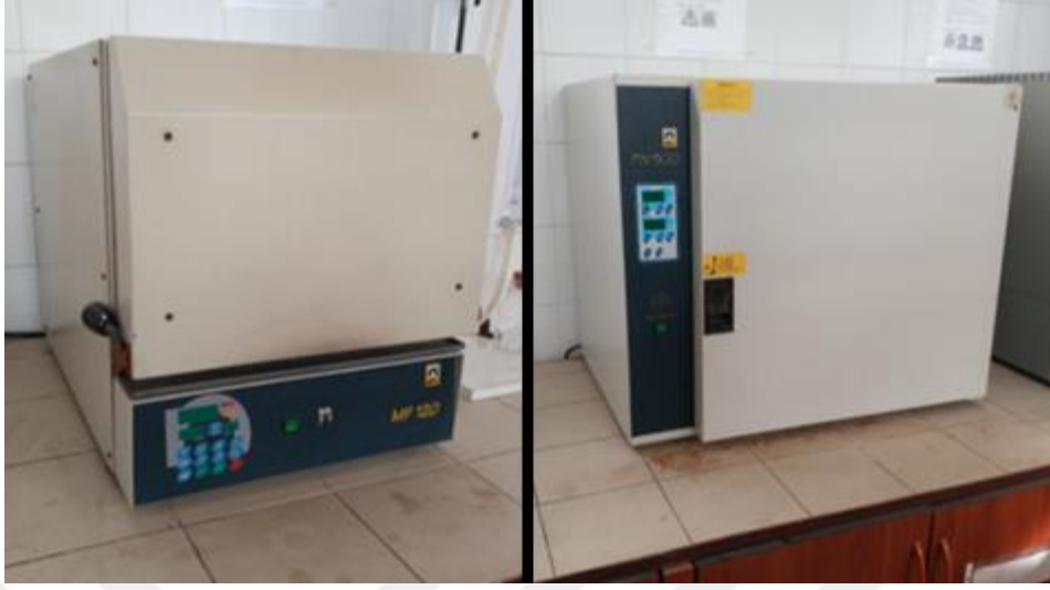
Şekil 5.16. Kömürlerin kısa analizlerinde kullanılan kül fırını ve etüv.
