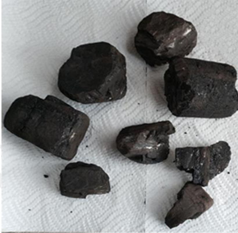
Şekil 6.3. Kömür damarından karotiyer aracılığıyla elde edilen kömür numuneleri.
