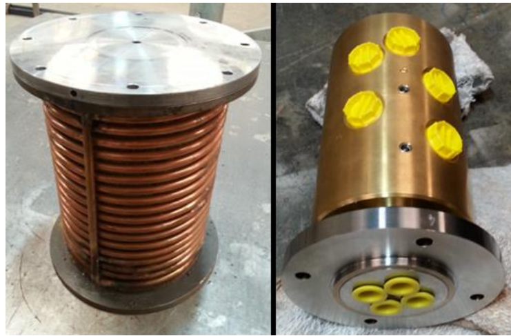
Şekil 5.2. Bakır serpantin borular ve 4 geçişli döner akışkan iletim elemanı.
