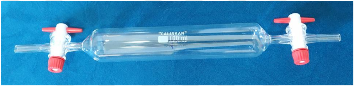
Şekil 5.14. 100 ml hacimli teflon musluklu gaz numune alma pipeti.
