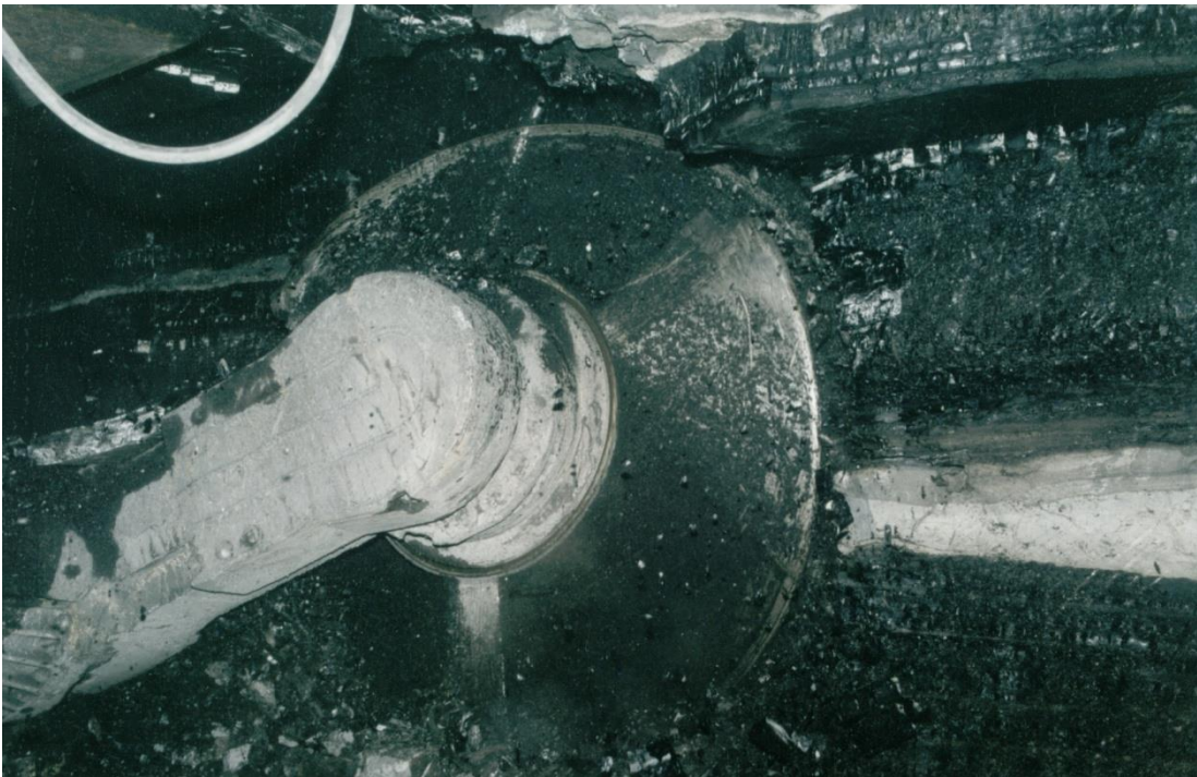
Şekil 5.4. Tek tambur kullanılarak kesici makine ile ayna kesimi (Destanoğlu vd., 2000).
