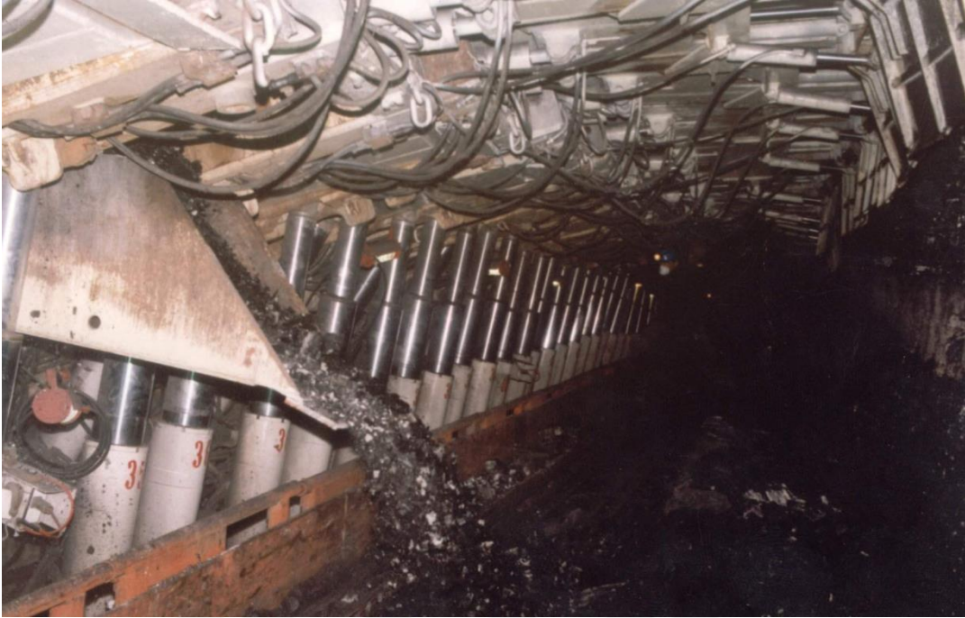
Şekil 5.8. Pencereleli tahkimat sistemi tavan kömürü alınması (Destanoğlu vd., 2000).
