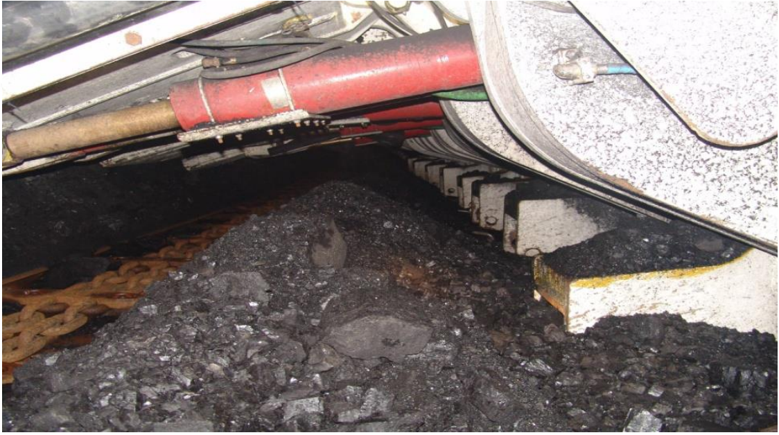
Şekil 5.14. Çift konveyörlü tahkimat sisteminde arka konveyör (GLİ, 2013).
