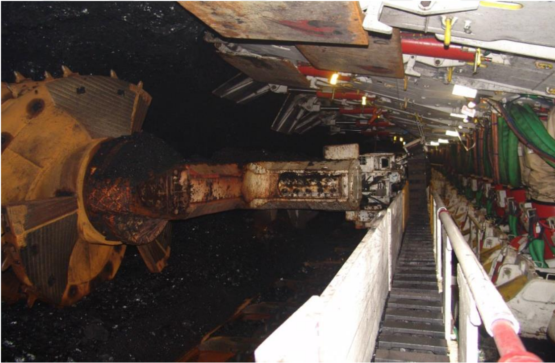
Şekil 5.13. Çift konveyörlü tahkimat sisteminde kesici makine (GLİ, 2013).
