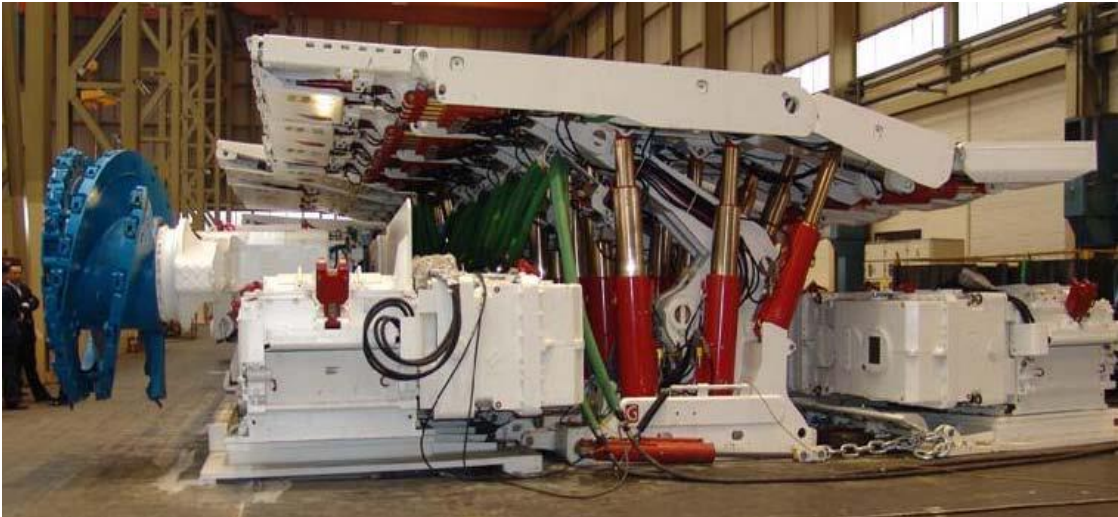
Şekil 5.9. Çift konveyörlü tahkimat sistemi (GLİ, 2013).
