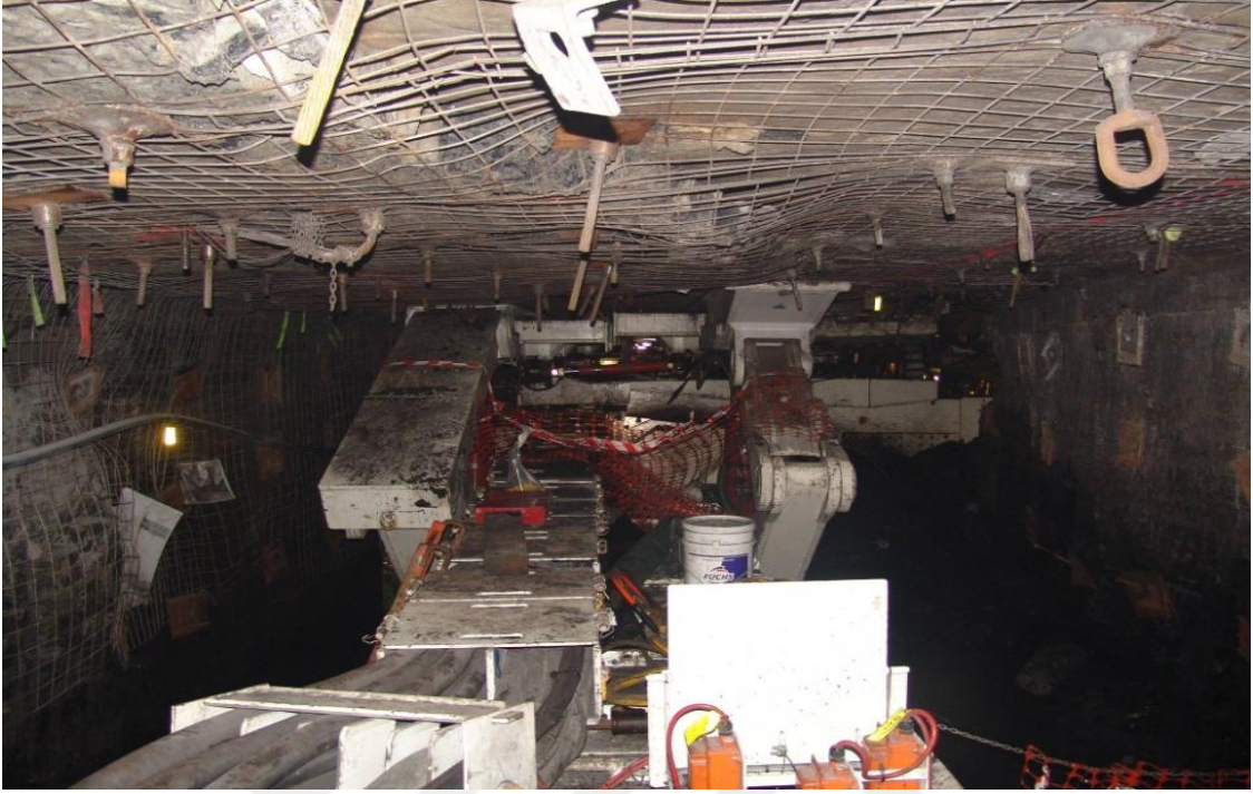
Şekil 5.12. Çift konveyörlü tahkimat sisteminde anayol ve sabit konveyör ötelenmesi (GLİ, 2013).
