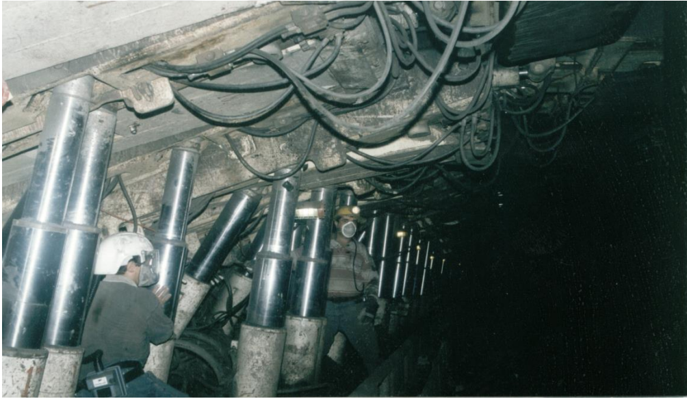
Şekil 5.6. Tahkimat ayna tutucuları ve sarma pistonları (Destanoğlu vd., 2000).
