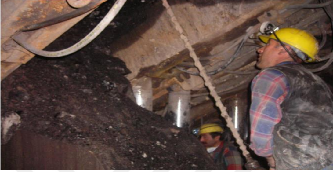
Şekil 6.1. Tahkimat penceresi içinden delik delme işlemi (GLİ Arşiv).
