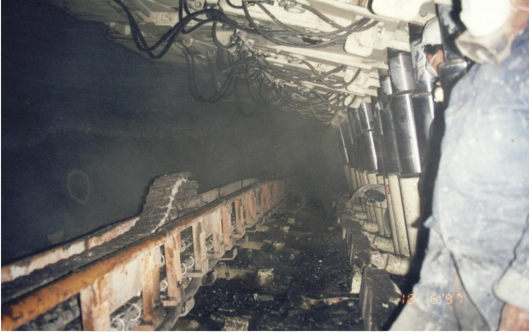
Şekil 5.7. Ayak içi ön konveyör oluğun ötelenmesi (Destanoğlu vd., 2000).
