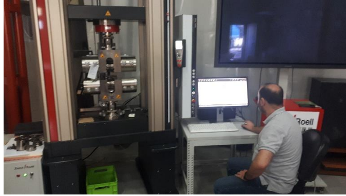
Şekil 5.6. Zwick/Roell marka AllroundLine Z250 SrR test cihazı.
