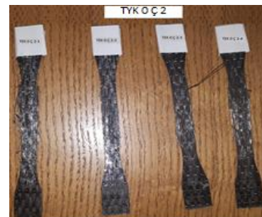
b) Testten sonra numune durumu
