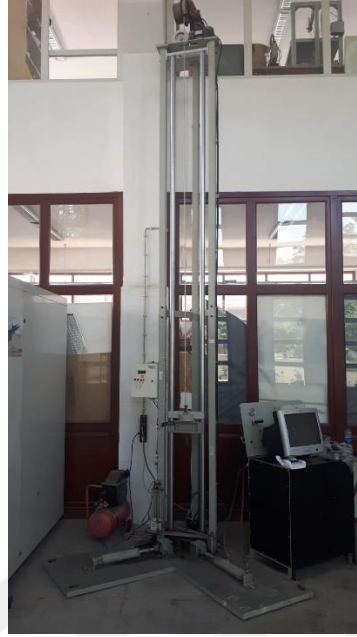
Şekil 5.10. Düşen ağırlık düşük hızlı çarpma test cihazı.
