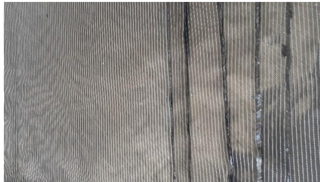
Şekil 5.3. Çift eksenli karbon elyaf kumaş.
