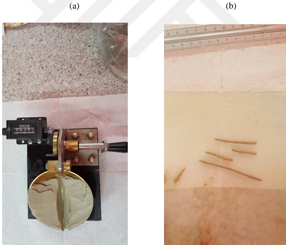
Şekil 5.4. Örneklerin Atterberg deneylerinden alınan görüntüler: (a) likit limit ve (b) plastik limit.
