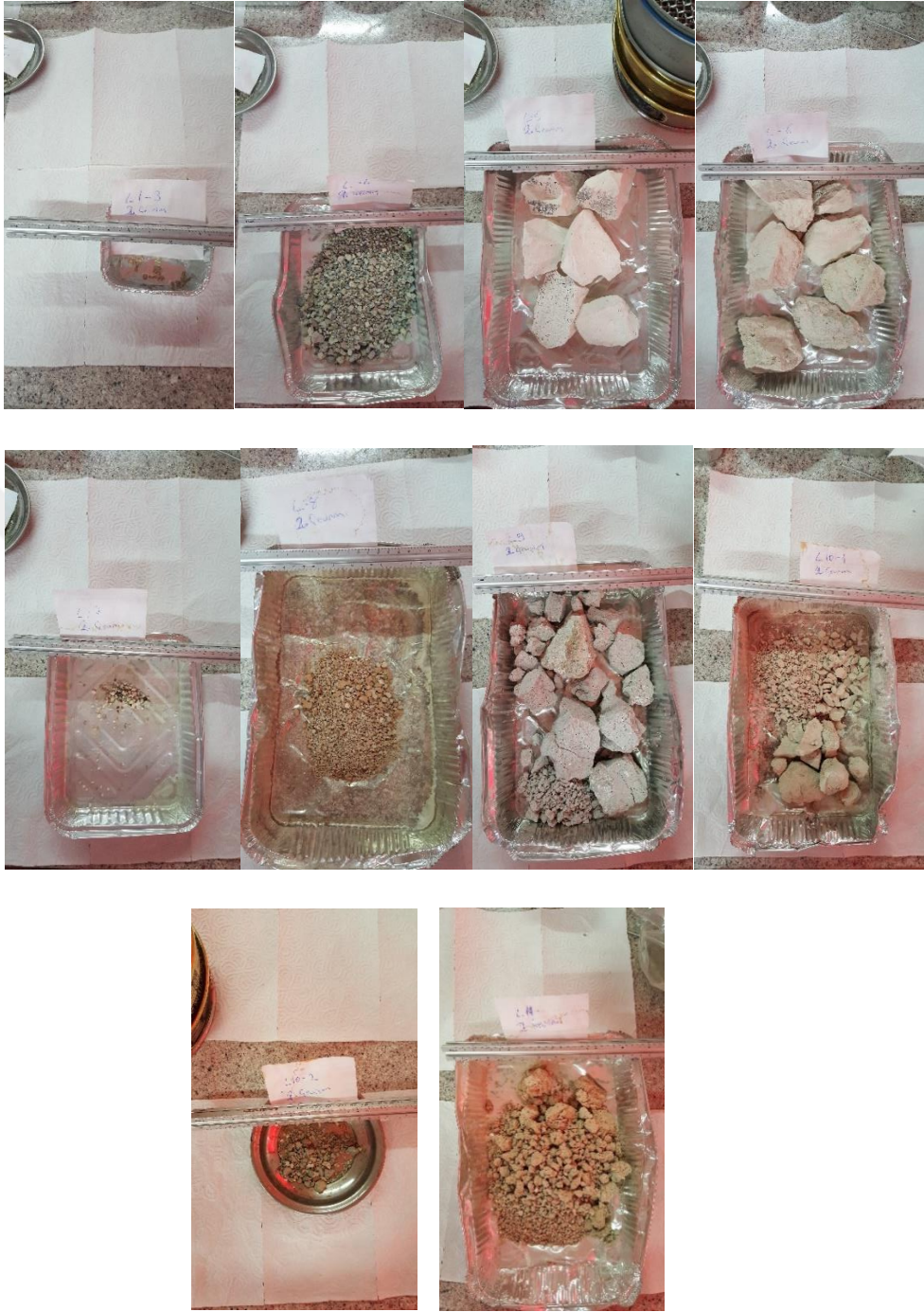
Şekil 5.8. Suda dağılma indeksi deneyinde ıslanma-kurumaya maruz kalmış örneklerin 2. çevrim sonrası genel görünüşleri.
