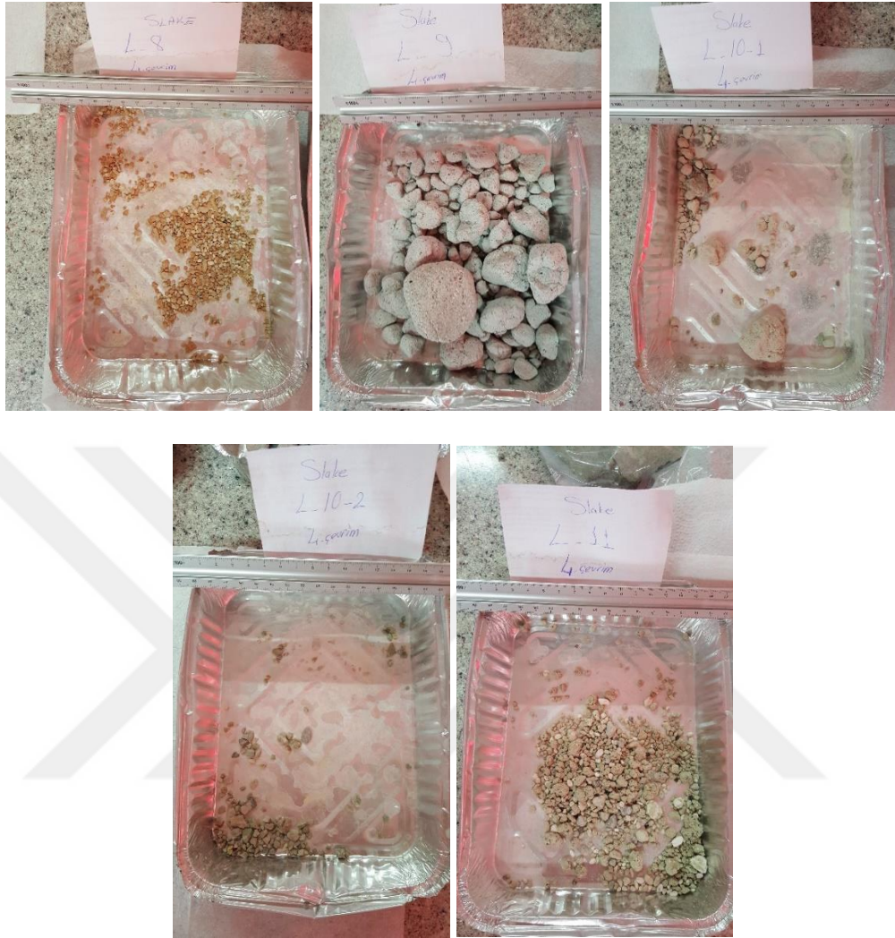
Şekil 5.16. Suda dağılmaya karşı duraylılık indeksi deneyinde örneklerin 4. çevrim sonrasındaki görüntüleri.
