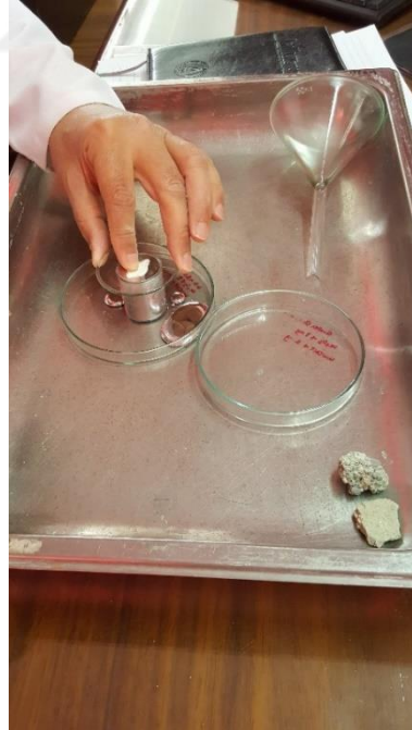
Şekil 5.1. Civa taşıma yöntemiyle kuru birim hacim ağırlık deneyi.
