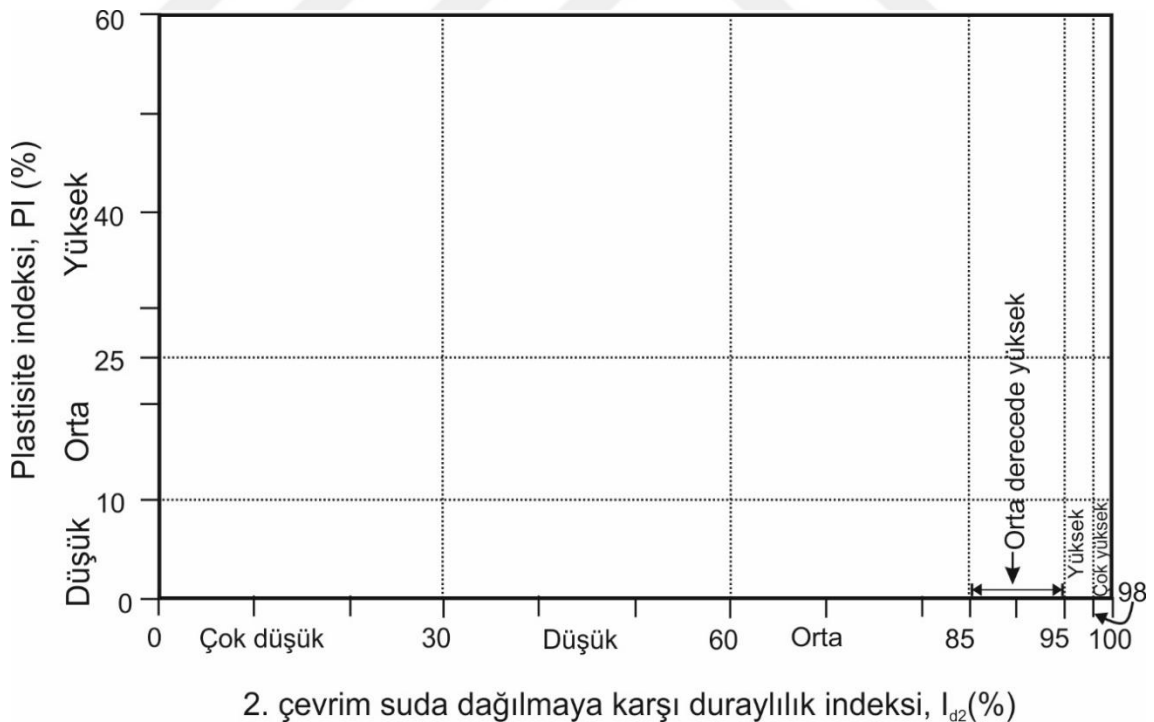
Şekil 2.2. Gamble (1971) tarafından önerilen kil içeren kayaların duraylılık sınıflaması.
