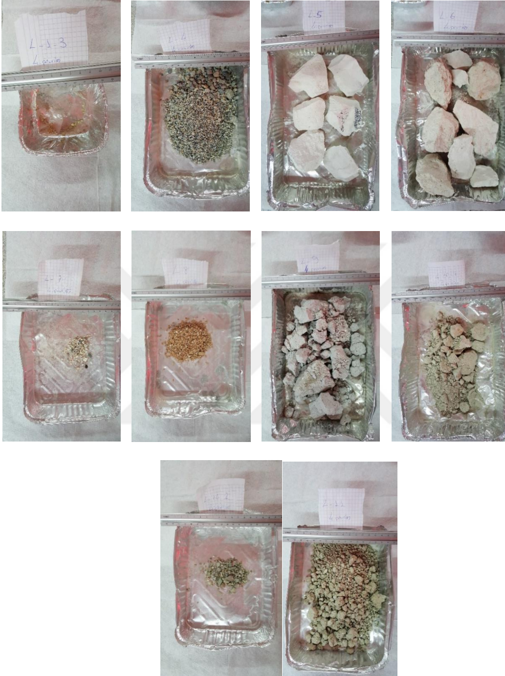
Şekil 5.9. Suda dağılma indeksi deneyinde ıslanma-kurumaya maruz kalmış örneklerin 4. çevrim sonrası genel görünüşleri.
