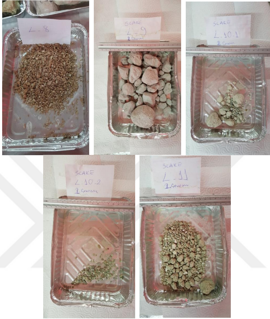
Şekil 5.15. Suda dağılmaya karşı duraylılık indeksi deneyinde örneklerin 2. çevrim sonrasındaki görüntüleri.
