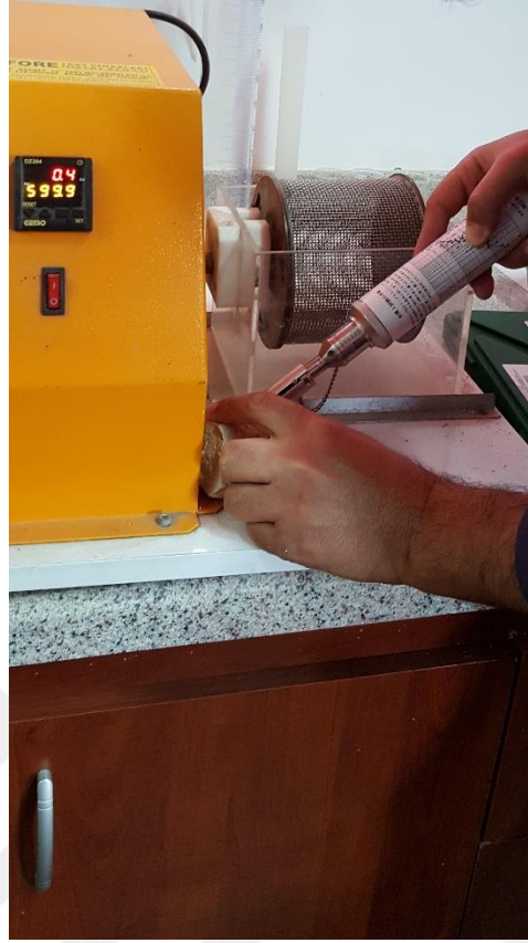
Şekil 5.3. İğne penetrometresi deneyinin laboratuvar koşullarında gerçekleştirilmesi.
