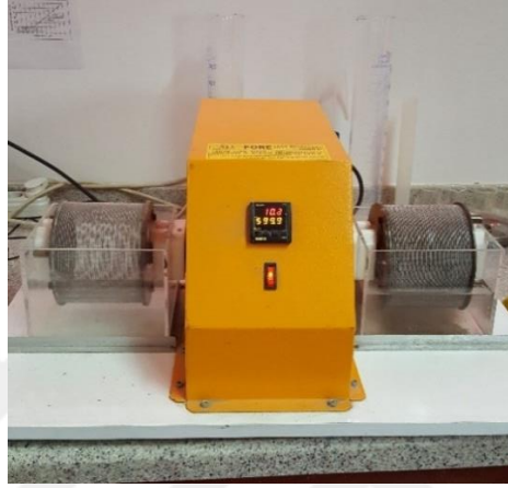
Şekil 5.13. Suda dağılmaya karşı duraylılık indeksi deneyinde kullanılan cihazdan bir görünüm.
