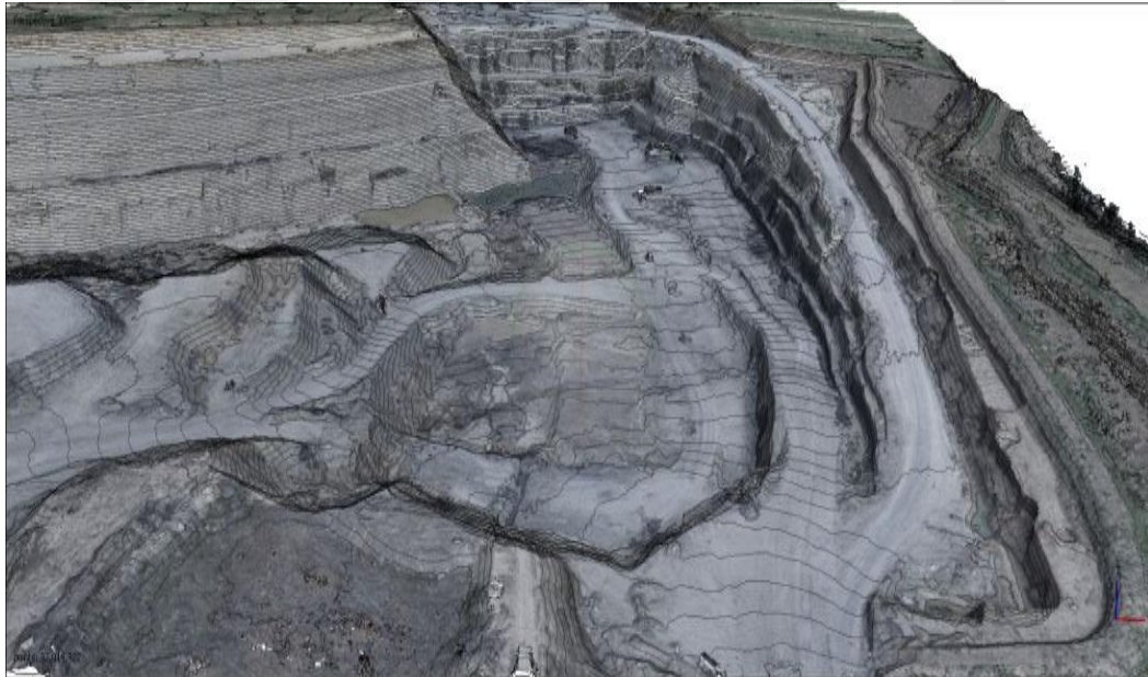
Şekil 5.5. Karma Madencilik açık ocak sahası drone ile ölçüm yapılarak hazırlanmış topografik görüntü.
