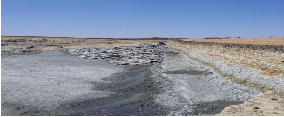
Şekil 5.12. Açık ocak şev ve basamak oluşturma çalışmaları.
