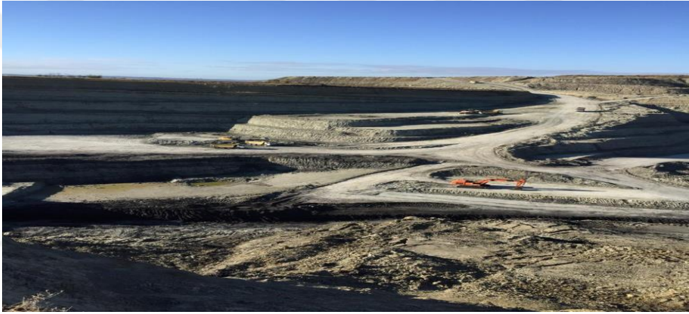
Şekil 5.13. Açık ocak şev ve basamak oluşturma çalışmaları.
