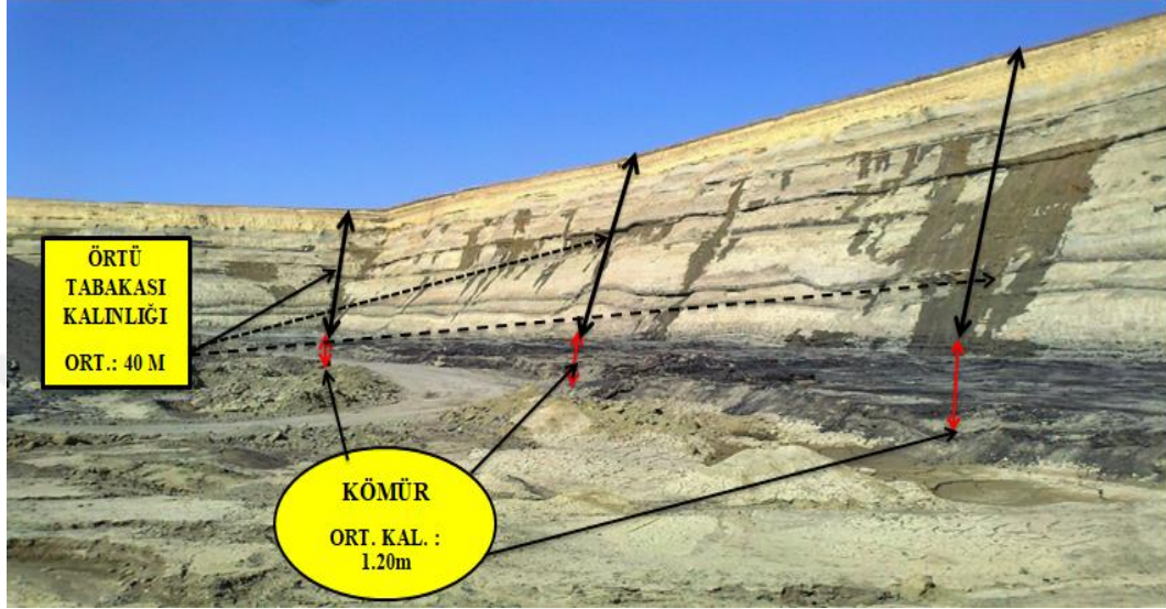
Şekil 5.4. Karma Madencilik açık ocak sahası örtü tabakası ve kömür kalınlığı.
