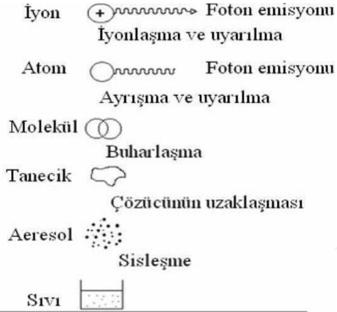
Şekil 3.7. Uyarılma ve atomlaşmanın şematik gösterimi.
