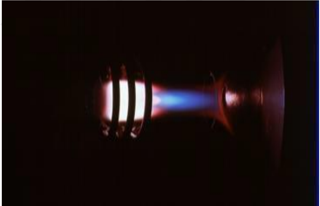
Şekil 3.4. ICP-OES cihazında plazmanın görünümü (Terra analiz eğitim notları).
