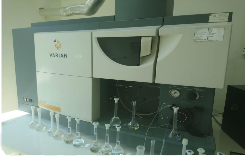
Şekil 4.6. Element analizinde kullanılan ICP-OES cihazı (VARIAN 710-ESModel).
