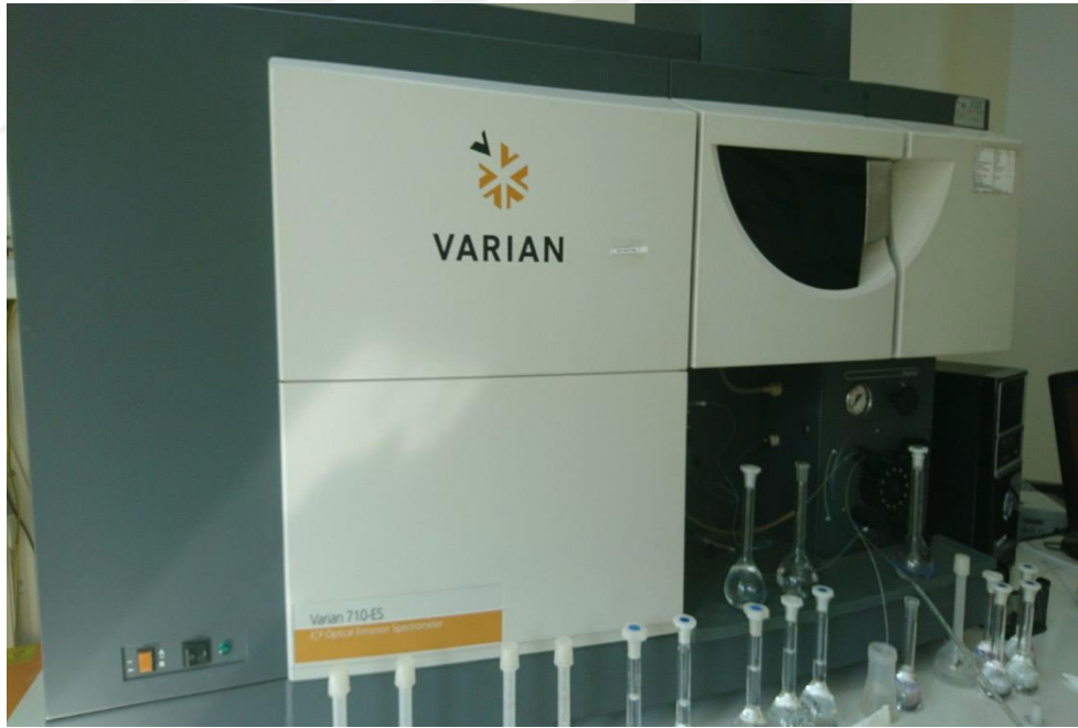
Şekil 4.7. Element analizinde kullanılan ICP-OES cihazı (VARIAN 710-ESModel).
