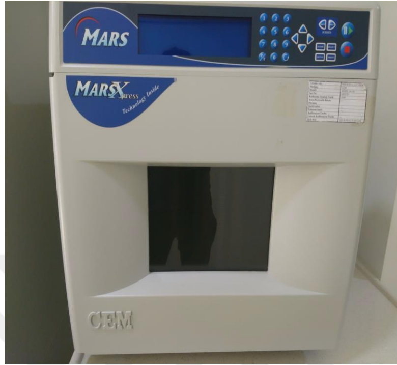
Şekil 4.4. Numuneleri yakmak için deneyde kullanılan mikrodalga cihazı.
