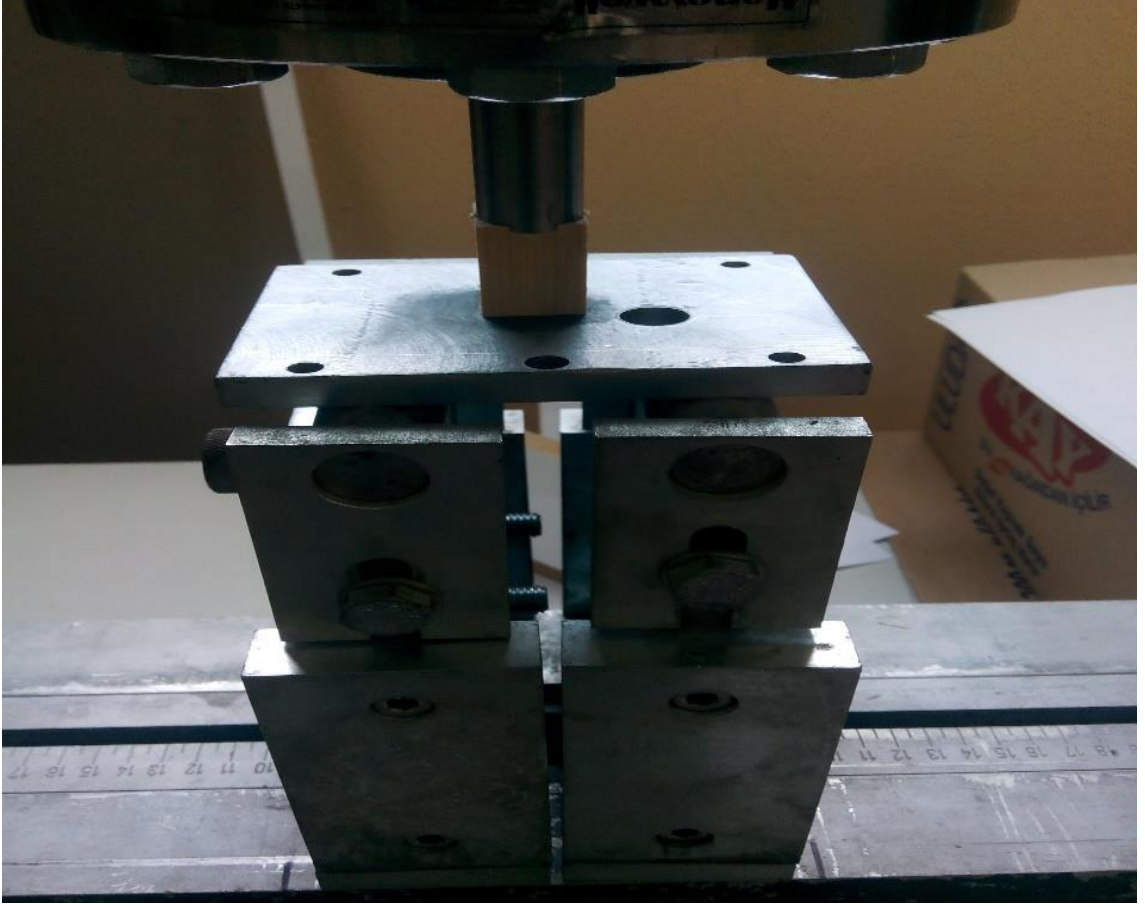
EK-6. Basınç direnci deney düzeneđi.
