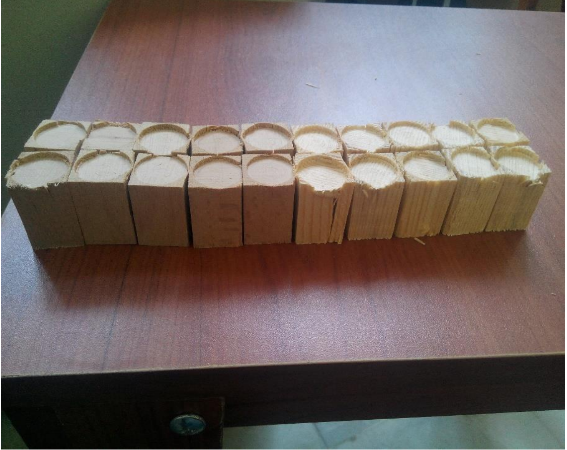
EK-7. Basınç direnci deney sonrası örneklerin kırılma şekilleri.
