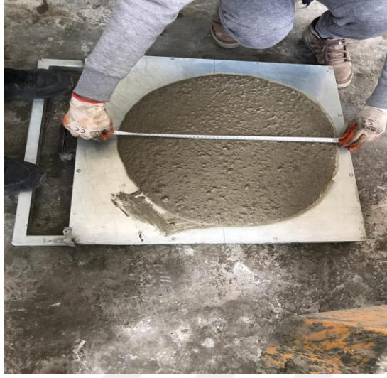
Şekil 4.5. Çökme yayılma deneyi uygulaması.
