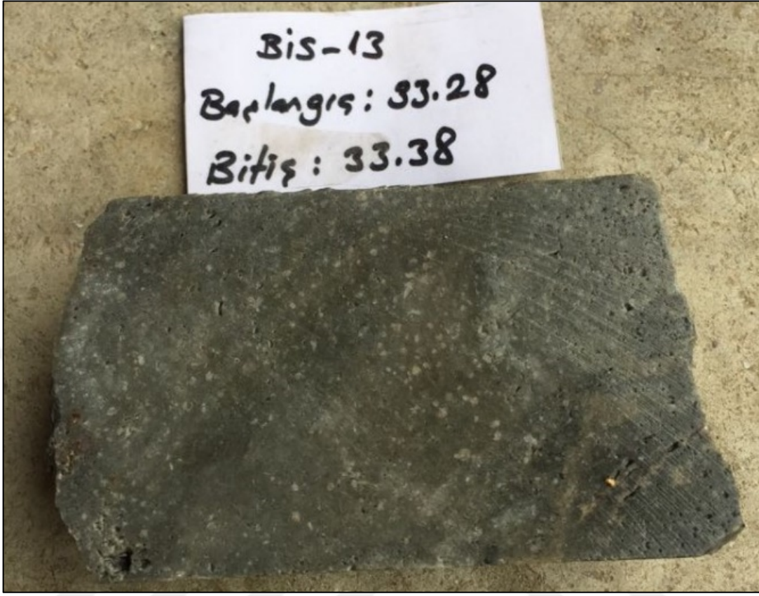
Şekil 3.27. İnceleme alanındaki Küçüktaş zuhurunda yapılan BIS-13 sondajından alınan 79965 nolu numunede zayıf gözenekli silika oluşumları.
