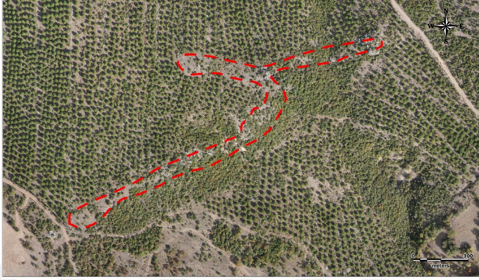
Şekil 3.15. Kocataş Tepe mevkisinde KD/GB uzanımlı silika zonunun hava fotoğrafı.
