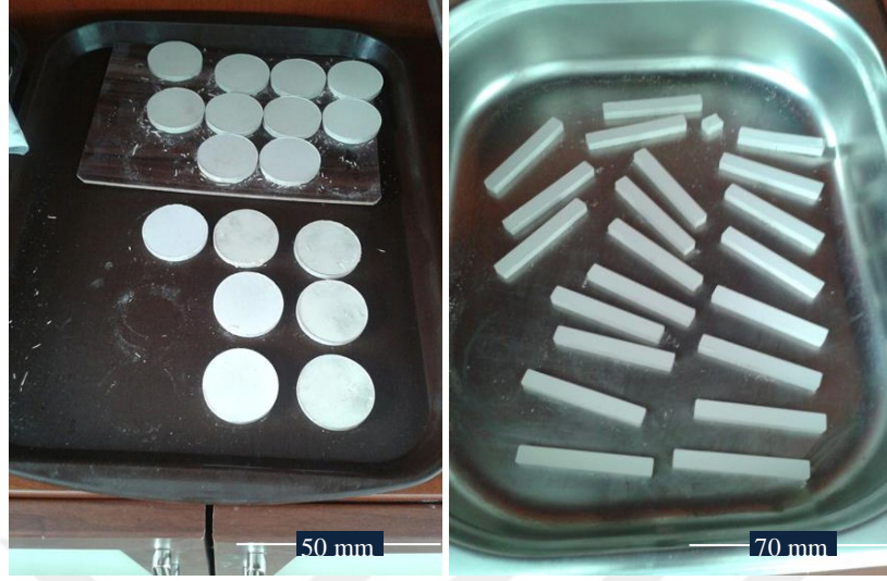
Şekil 6.16. KP 13 örneğinden fiziksel analizler için hazırlanan numuneler.
