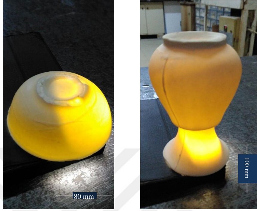
Şekil 6.14. Üretim denemelerinde yapılan ışık geçirgenliğini gösteren kemik porselen örnekleri.
