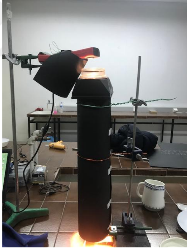
Şekil 5.3. Işık geçirgenliği ölçümü için hazırlanmış düzenek.
