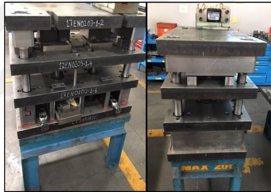
Şekil 5.7. Sıvama kalıbının montaj sonrası görüntüsü.
