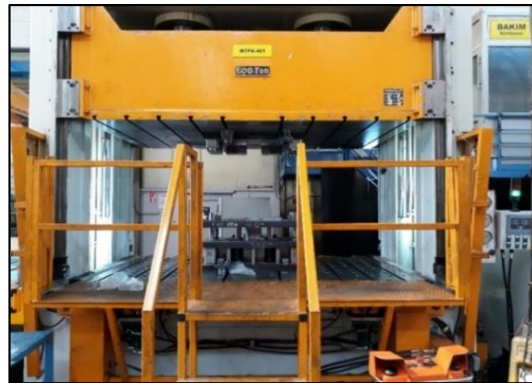
Şekil 5.8. MTP401 nolu 600 Tonluk pres ve kalıbın görüntüsü.
