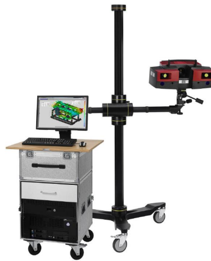
Şekil 5.10. Atos ölçüm cihazı.
