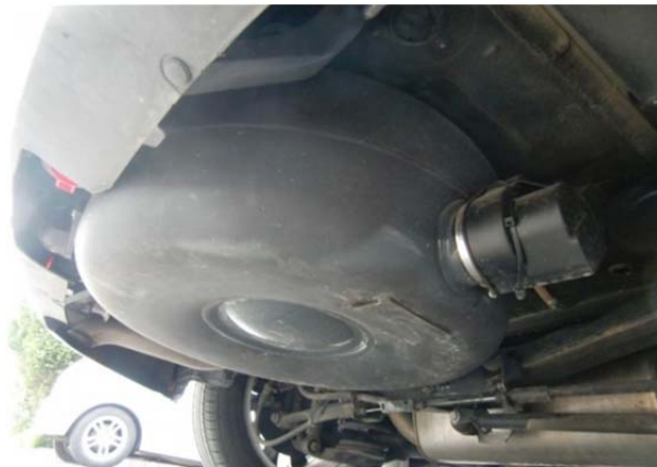
Şekil 4.48. Araç altına yapılmış simit tank montajı örneği.
