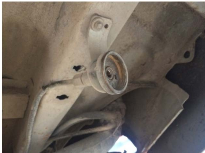
Şekil 4.90. Kapağı olmadığı için kire ve suya karşı dirençsiz dolum ağızı örneği.
