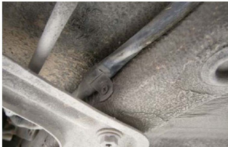
Şekil 4.103. LPG borusu ile kroşe arasında izolasyon yapılmış uygun montaj örneği.
