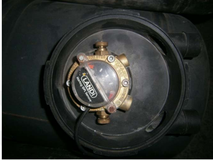
Őekil 4.32. Tank tipi ile uyumsuz multivalf montajı örneęi (MMO, 2017).
