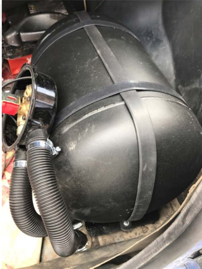
Şekil 4.52. Uygun şekilde üçüncü kuşak geçirilmiş montaj örneği.
