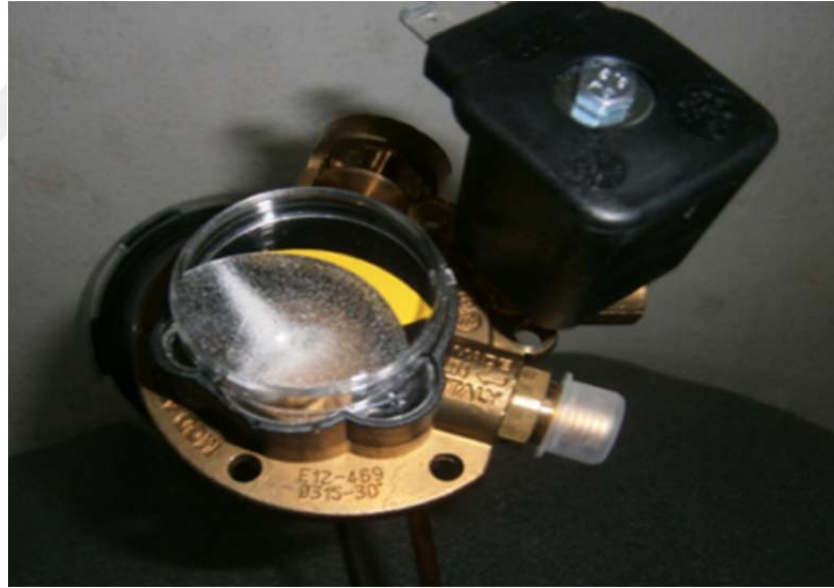
Şekil 4.25. 315 mm çapındaki silindirik tanka uygun multivalf örneği (MMO, 2017).
