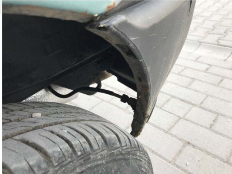
Şekil 4.7. Tampona monte edilip, kire ve suya karşı korunmamış dolum ağzı örneği.
