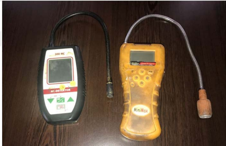
Şekil 4.1. LPG gaz kaçağ dedektörü örnekleri.
