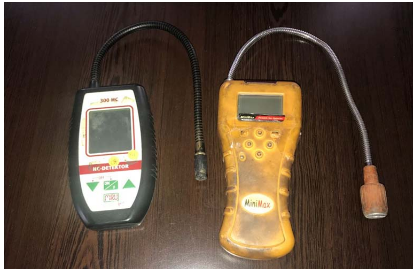
Şekil 5.3. Kontrollerde kullanılan gaz kaçak dedektörleri.
