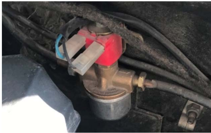
Şekil 4.10. LPG valfi montajı örneği.
