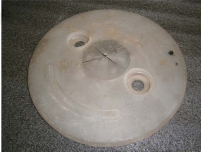
Şekil 4.74. Simit tank kırık sızdırmaz odacık kapağı örneği (MMO, 2017).
