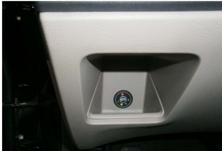
Şekil 4.126. Seçici anahtar montajı örneği (MMO, 2017).
