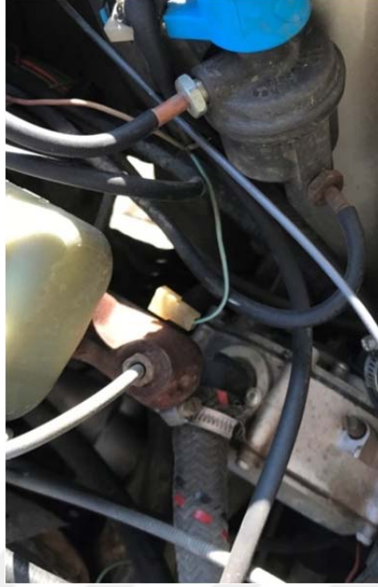
Şekil 4.9. Valf üzeri bakır boru ve regülatör üzeri hortum bağlantısı örnekleri.
