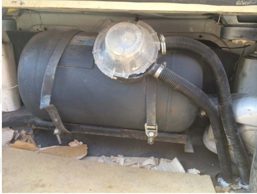
Şekil 4.59. Kırık kapak kullanılan uygunsuz tank montajı örneği.
