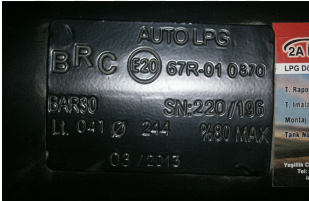
Şekil 4.20. “E” işaretli silindirik tank etiketi örneği (MMO, 2017).
