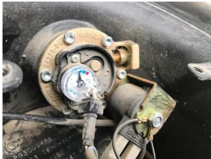
Şekil 4.64. Multivalf seviye göstergesi montaj örneği.
