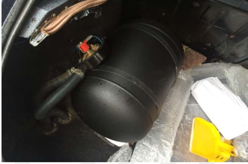
Şekil 4.22. Hatalı montaj yönü sebebiyle etiket bilgileri okunamayan tank örneği.
