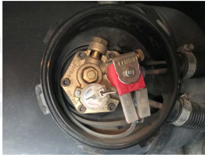
Şekil 4.30. Montaj açısı 30° olarak belirtilen multivalf örneği.
