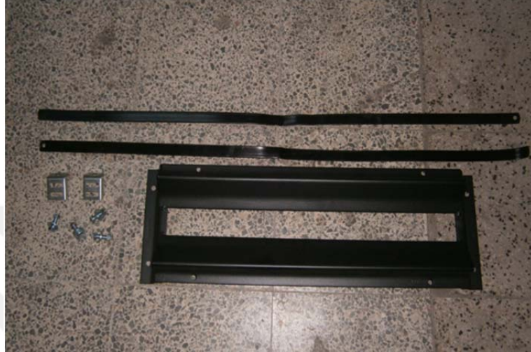
Şekil 4.45. Silindirik tank montajında kullanılan malzemeler (MMO, 2017).
