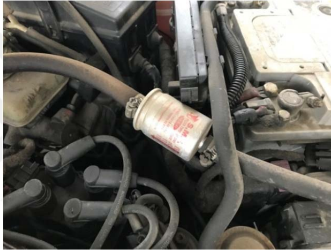
Şekil 4.13. Gaz filtresi bağlantısı örneği.
