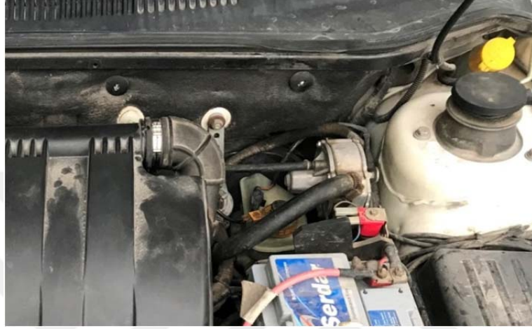
Şekil 4.121. Regülatör selenoid bobini montaj örneği.
