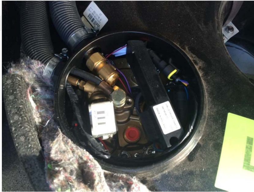
Şekil 4.68. Likit LPG dönüşüm sistemi multivalf selenoid bobini montajı örneği.
