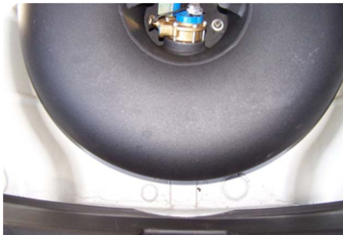
Şekil 4.54. Arka panele değmeyen, uygun simit tank montajı örneği (MMO, 2017).
