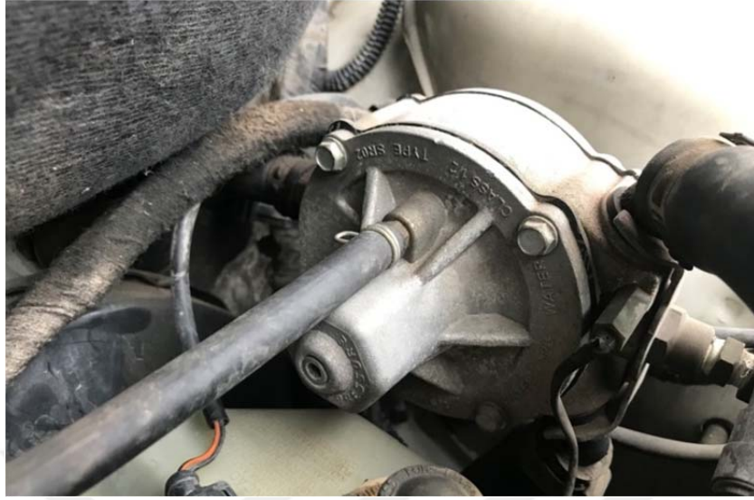
Şekil 4.117. Regülatör montajı örneği (MMO, 2017).
