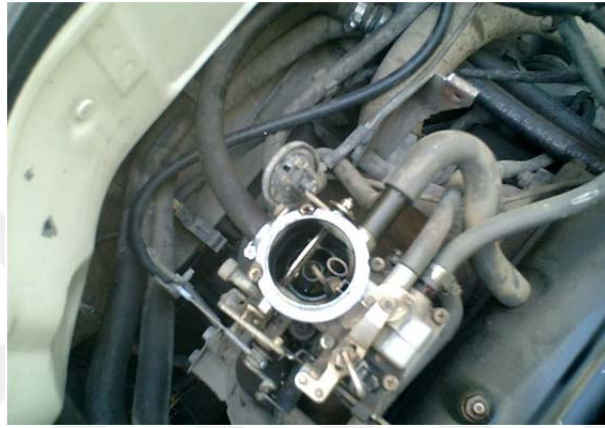
Şekil 4.15. LPG karbüratör girişi bağlantı örneği (MMO, 2017).
