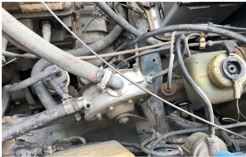
Şekil 4.118. Aracın gidiş yönüne paralel monte edilmiş mekanik regülatör montajı.
