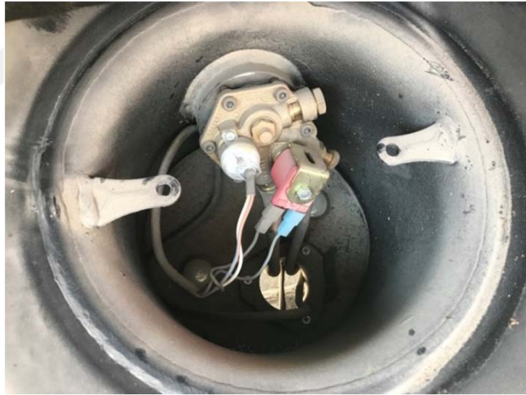
Şekil 4.5. Simit tanka monte edilmiş multivalf örneği.
