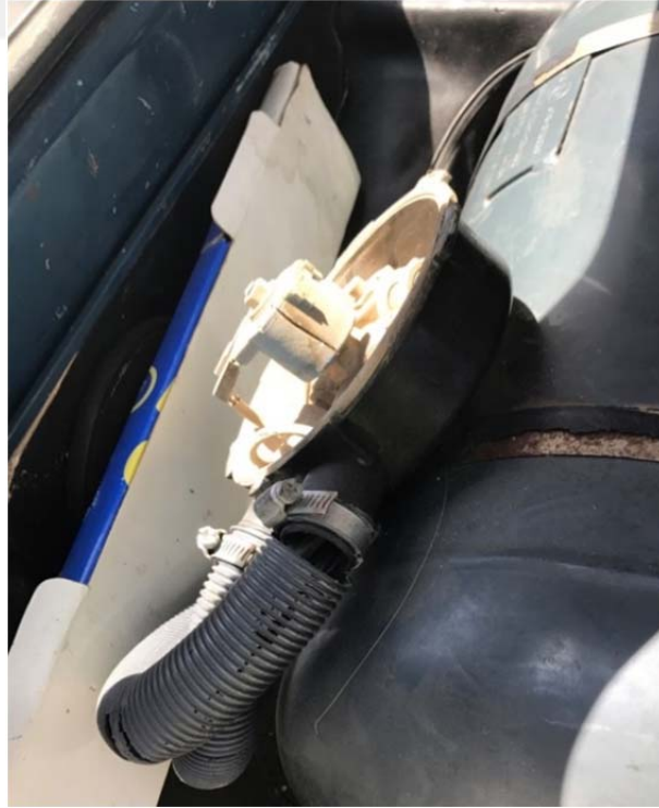
Şekil 4.76. Silindirik tank uygunsuz kırık havalandırma hortumu örneği.
