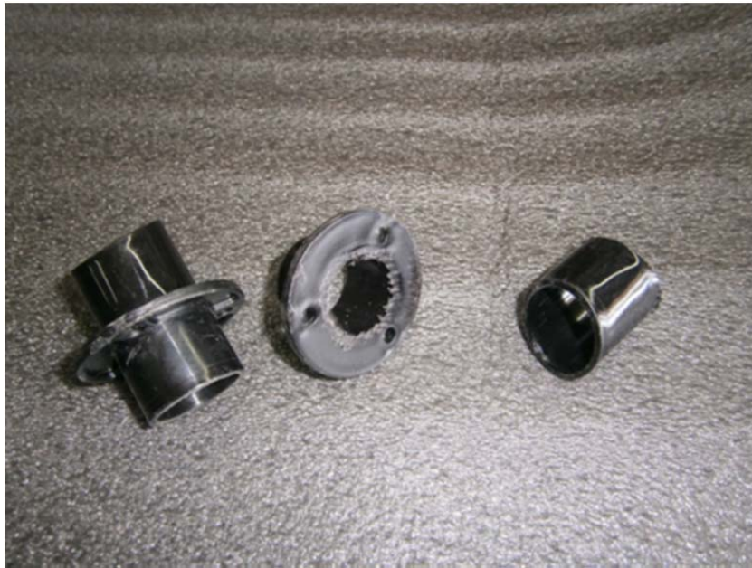
Şekil 4.88. Kırık havalandırma bacası örneği (MMO, 2017).
