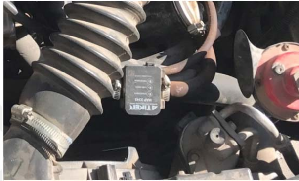
Şekil 4.17. Mutlak basınç sensörü (MAP sensörü) örneği.
