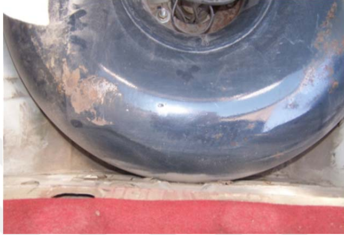
Şekil 4.55. Arka panele değen, uygunsuz simit tank montajı örneği (MMO, 2017).
