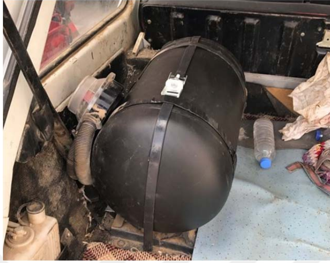
Şekil 4.53. Üçüncü kuşağa ek yapılmış, uygunsuz montaj örneği.
