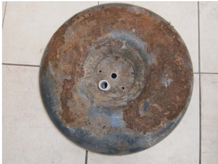
Şekil 4.58. Korozyona uğramış uygunsuz simit tank örneği (MMO, 2017).
