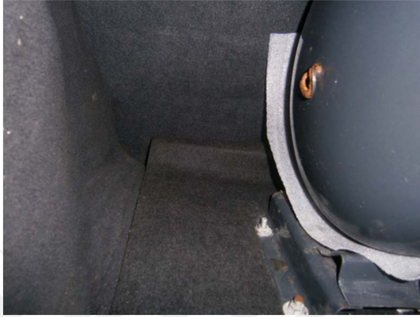
Şekil 4.41. Metalle teması kesilmiş uygun silindirik tank montajı örneği (MMO, 2017).
