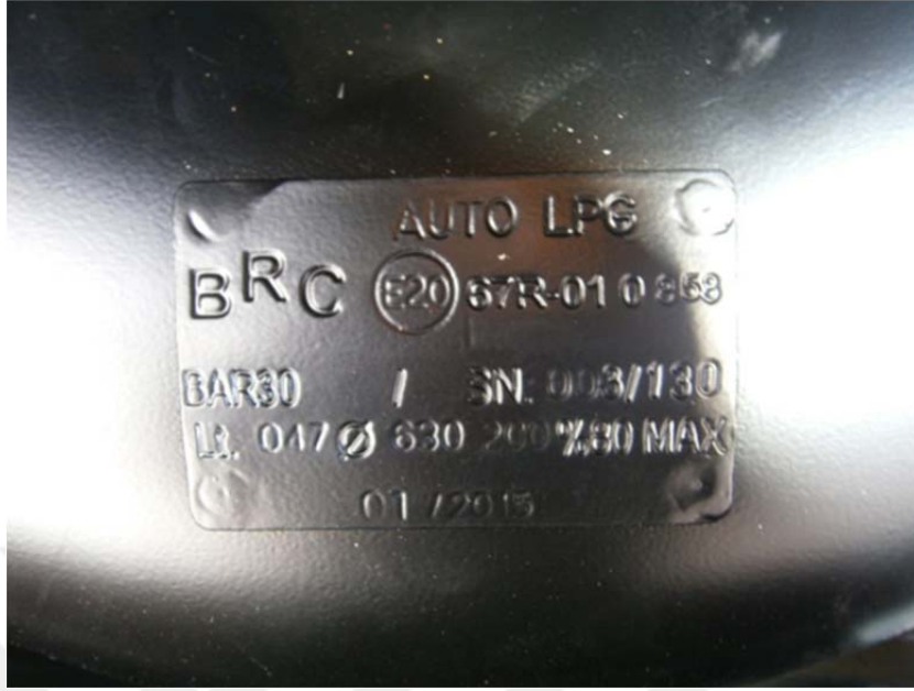
Şekil 4.26. 200 mm yüksekliğinde simit tank örneği (MMO, 2017).
