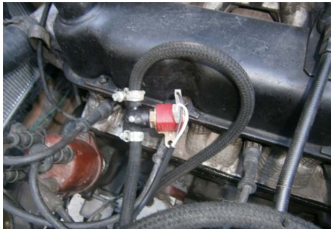
Şekil 4.114. Benzin valfi motor üzerine monte edilmiş uygunsuz montaj (MMO, 2017).
