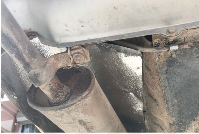
Şekil 4.95. LPG boruları ve egzoz arasına yalıtım yapılmış uygun montaj örneği.
