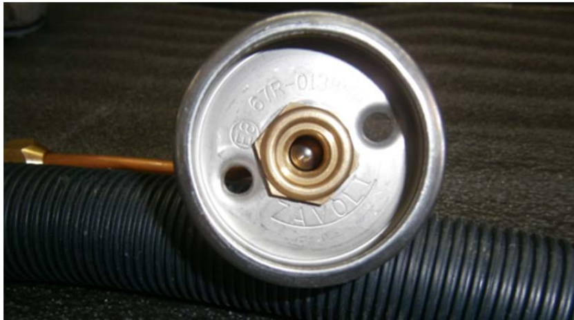
Şekil 4.96. Çekvalf bilyası mevcut dolum ağzı örneği (MMO, 2017).
