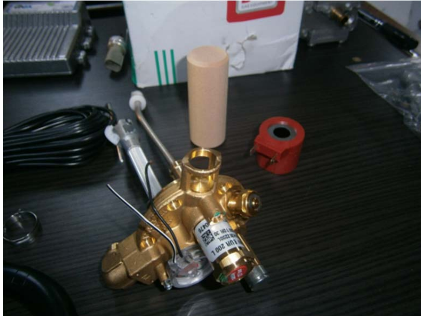
Şekil 4.27. 200 mm yüksekliğinde simit tanka uygun multivalf örneği (MMO, 2017).
