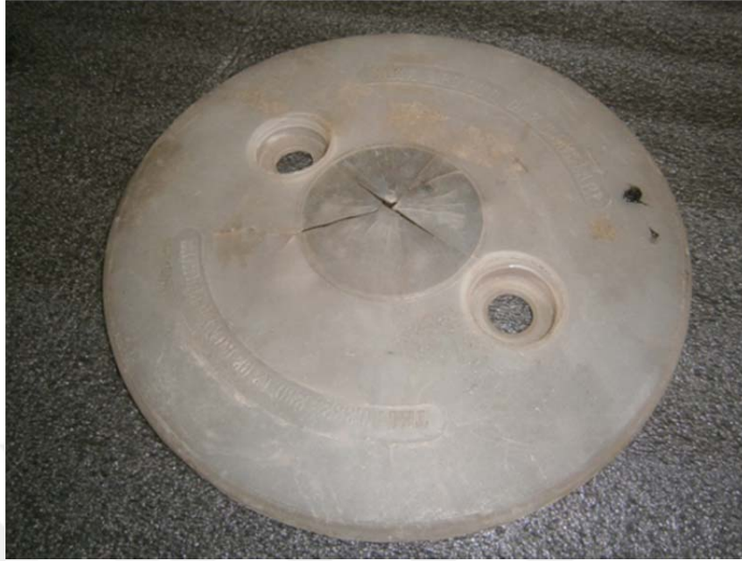
Şekil 4.61. Kırık olduğu için kullanılmaması gereken simit tank kapağı (MMO, 2017).
