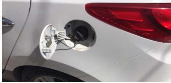
Şekil 4.99. Dolum ağzı benzin kapağı içerisinde bulunan uygun montaj örneği.
