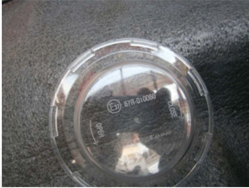
Şekil 4.73. Silindirik tank kırık sızdırmaz odacık kapağı örneği (MMO, 2017).
