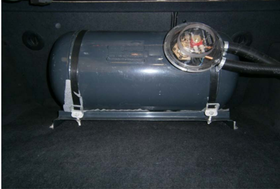
Şekil 4.35. Cıvatalar ve sehpayla uygun bir şekilde montajı yapılmış tank örneği.
