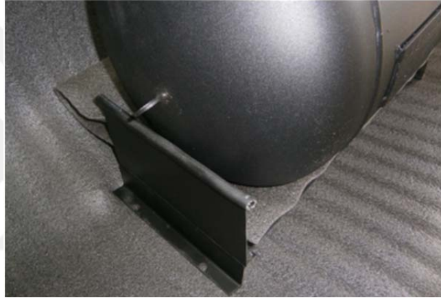
Şekil 4.49. Silindirik tank koruma sacı örneği (MMO, 2017).
