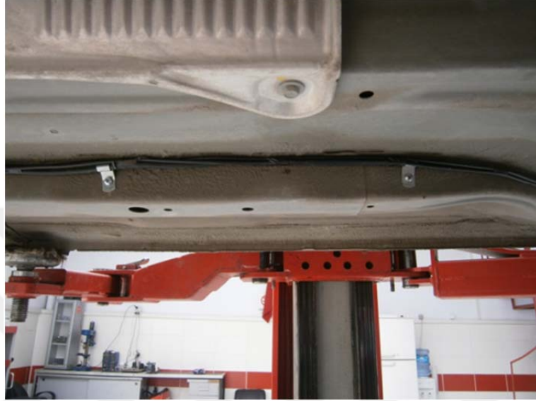
Şekil 4.104. LPG boru ve hortumları kriko yerinden geçmeyen uygun montaj örneği.
