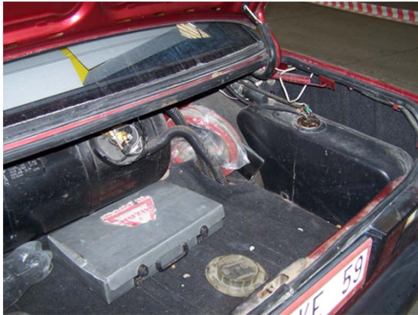
Şekil 4.62. Benzin deposu tadilatı yapılmış uygunsuz araç örneği (MMO, 2017).
