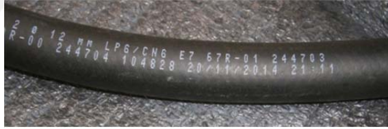
Şekil 4.100. BM/AEK R-67 regülasyonuna uygun LPG hortumu örneği (MMO, 2017).
