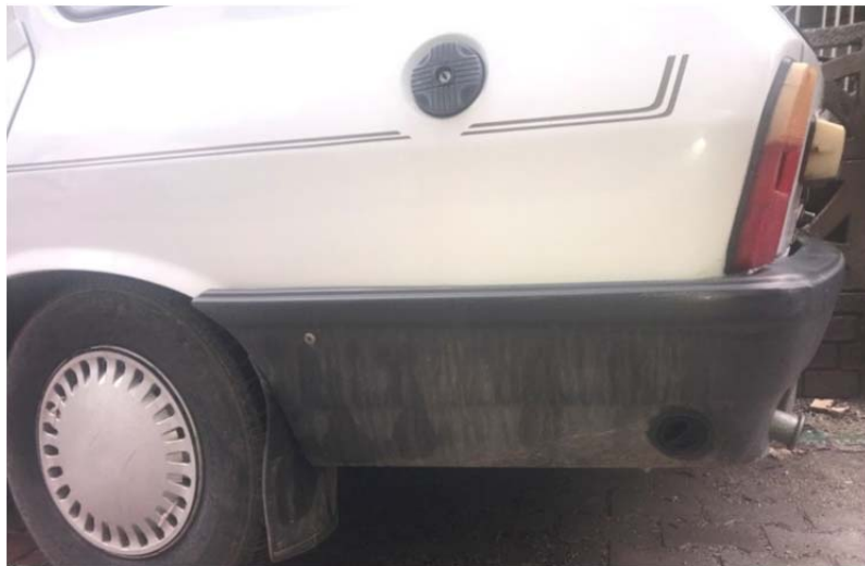
Şekil 4.98. Dolun ağızı tampon üzerinde bulunan uygun montaj örneđi.
