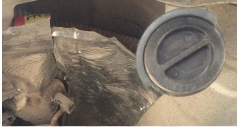
Şekil 4.93. Dolun ağız egzozla yakın olduğu için araya yalıtım yapılmış montaj örneğı.
