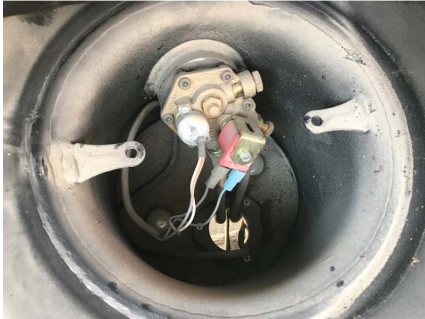
Şekil 4.80. Simit tank uygun havalandırma hortum bacası örneği.
