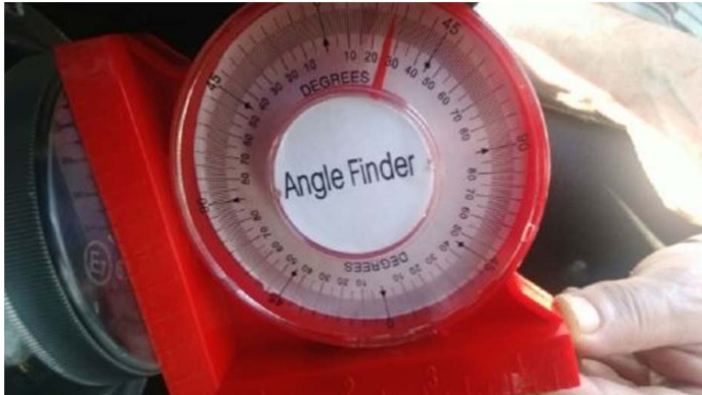
Şekil 4.29. Multivalf montaj açısı kontrol örneği (MMO, 2017).
