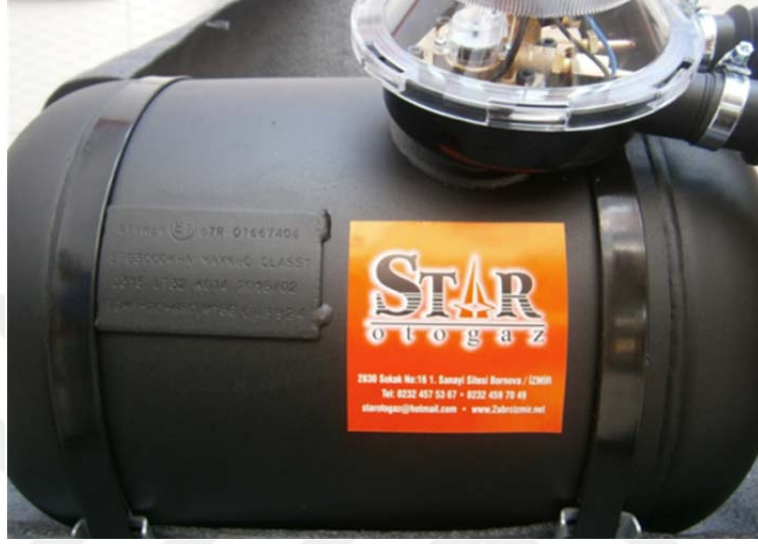
Şekil 4.3. Üzerinde montaj firması bilgileri etiketi bulunan silindirik tank örneği.
