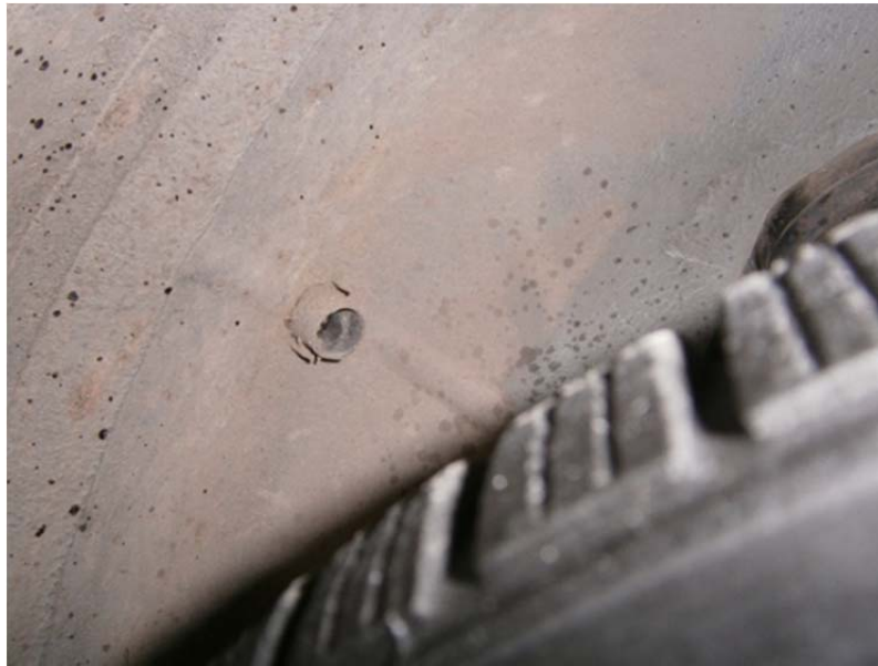
Şekil 4.84. Tekerlek boşluğuna açılmış uygunsuz havalandırma örneği (MMO, 2017).
