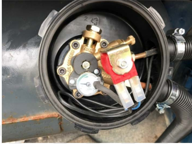
Şekil 4.4. Silindirik tanka monte edilmiş multivalf örneği.
