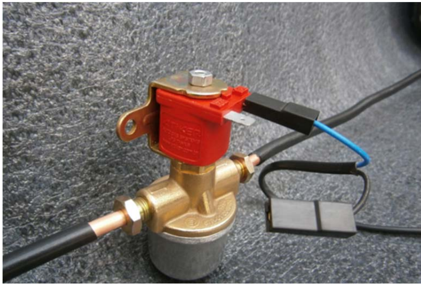
Şekil 4.112. Bobin soketi sökülebilir olan LPG valfi örneği (MMO, 2017).
