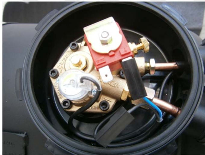
Şekil 4.66. Multivalf selenoid bobini montajı örneği (MMO, 2017).
