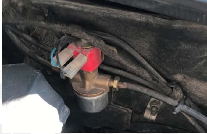
Şekil 4.113. Bobin soketi sökülebilir olan uygun LPG valfi montajı örneği.
