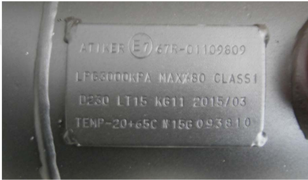
Şekil 4.19. BM/AEK R-67 regülasyonuna uygun tank etiketi örneği.
