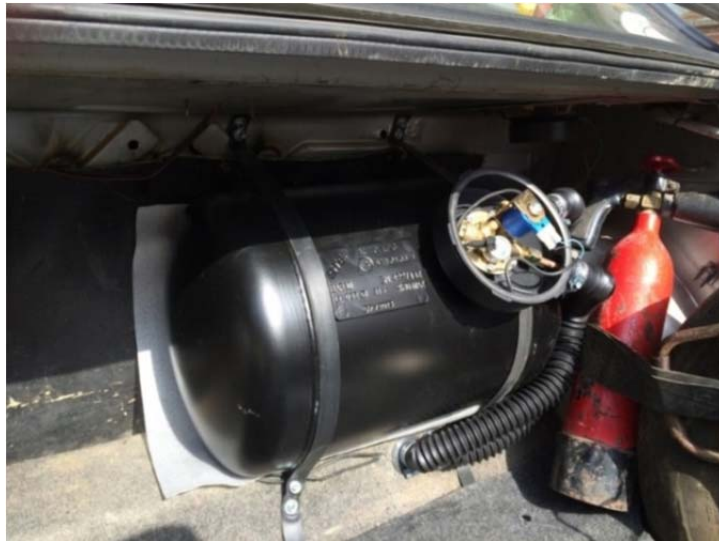
Őekil 4.33. Sehpa / kalıcı sabitleme yerine saęlam monte edilmiř, uygunsuz silindirik tank montajı örneęi.
