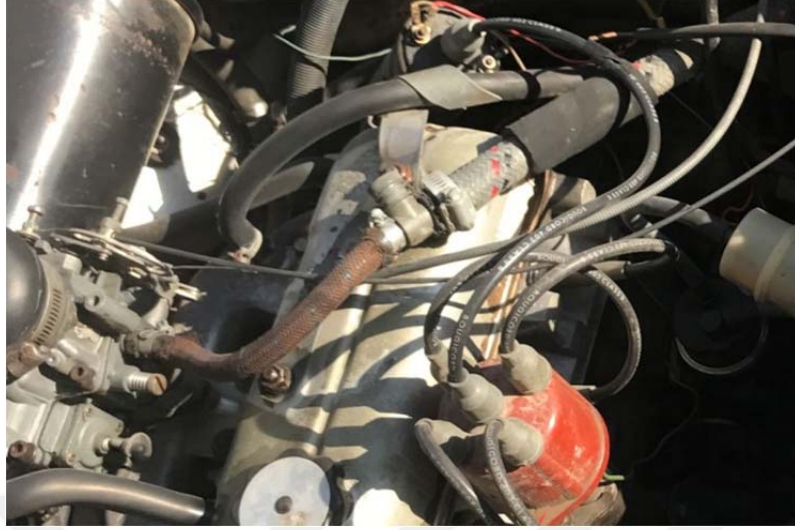
Şekil 4.123. Gaz ayar vidası ve hortumu montaj örneği (MMO, 2017).
