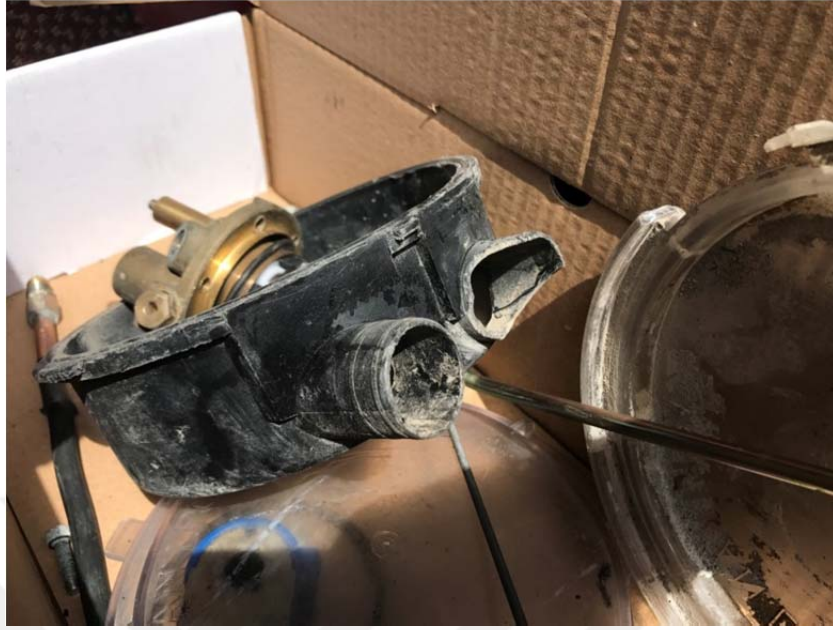
Şekil 4.71. Silindirik tank kırık sızdırmaz odacık örneği.
