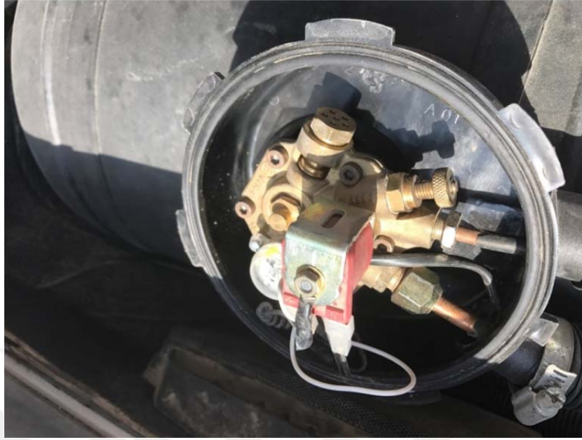
Şekil 4.67. Enjeksiyonlu araç multivalf selenoid bobini montajı örneği.
