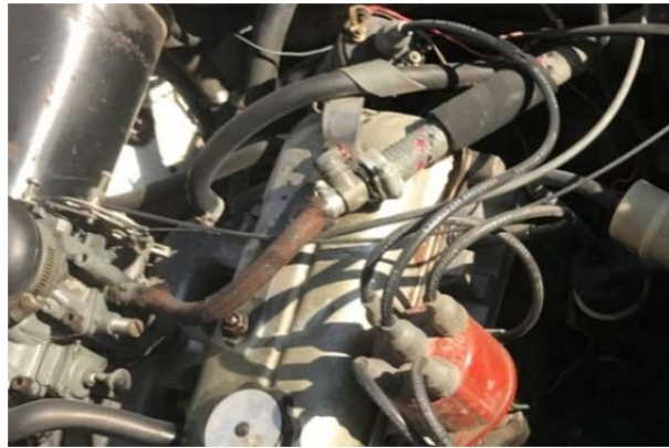
Şekil 4.12. Gaz ayar vidası bağlantısı örneği.
