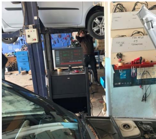
Şekil 4.18. Sıralı sistem bilgisayarlı gaz ayarı örneği.
