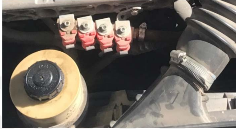
Şekil 4.125. Sabit ve kontrol edilebilir, uygun gaz enjeksiyon cihazı montajı örneği.
