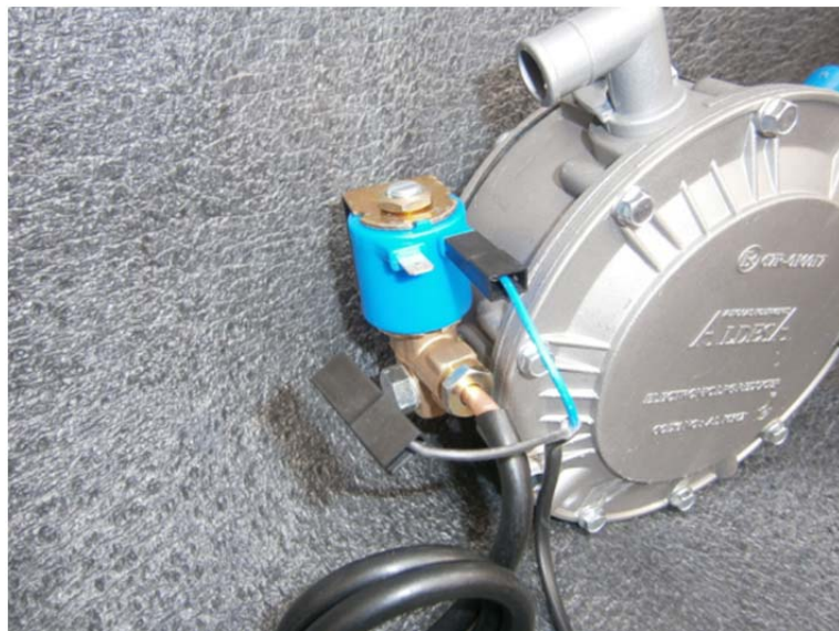
Şekil 4.120. Regülatör selenoid bobini örneği (MMO, 2017).
