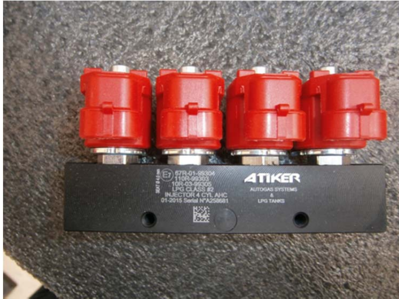
Şekil 4.124. BM/AEK R-67 regülasyonuna uygun gaz enjeksiyon cihazı (MMO, 2017).
