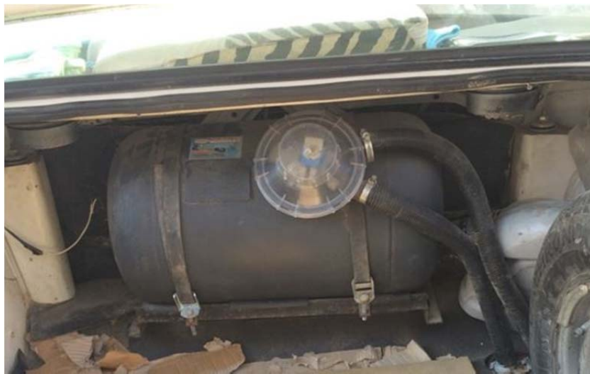
Şekil 4.60. Sağlam kapak takılan uygun tank montajı örneği.
