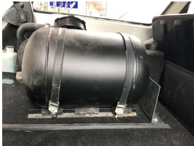
Şekil 4.50. Silindirik tank koruma sacı montajı örneği (MMO, 2017).
