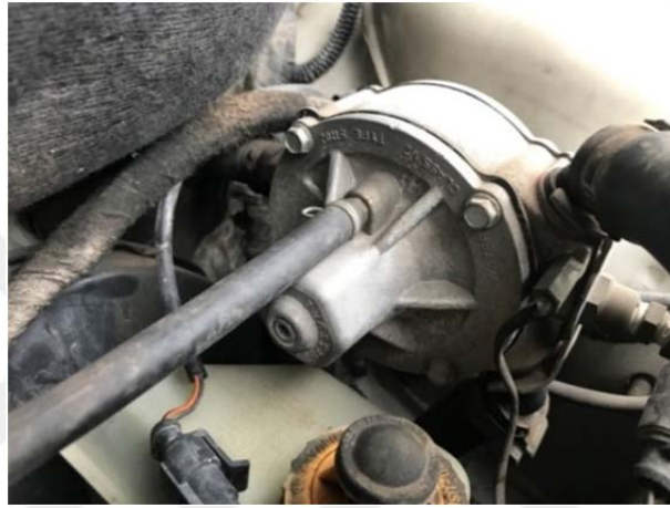
Şekil 4.11. Regülatör bağlantısı örneği.
