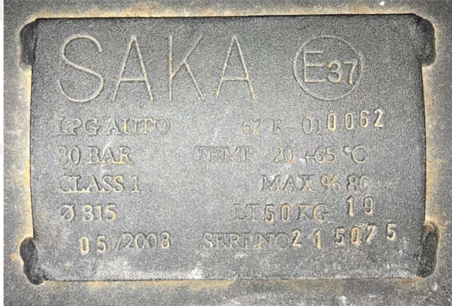
Şekil 4.21. 2019 yılı itibariyle 10 yıllık kullanım ömrünü doldurmuş tank örneği.
