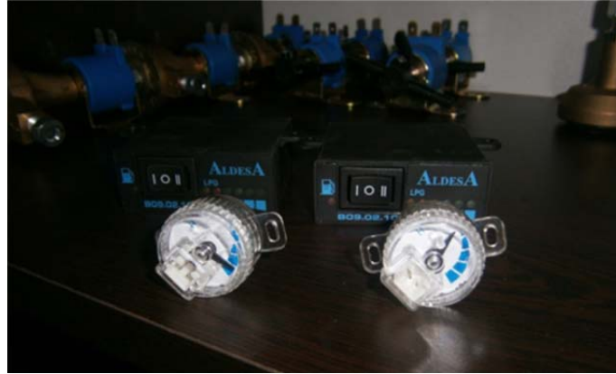
Şekil 4.65. Multivalf seviye göstergesi örnekleri (MMO, 2017).
