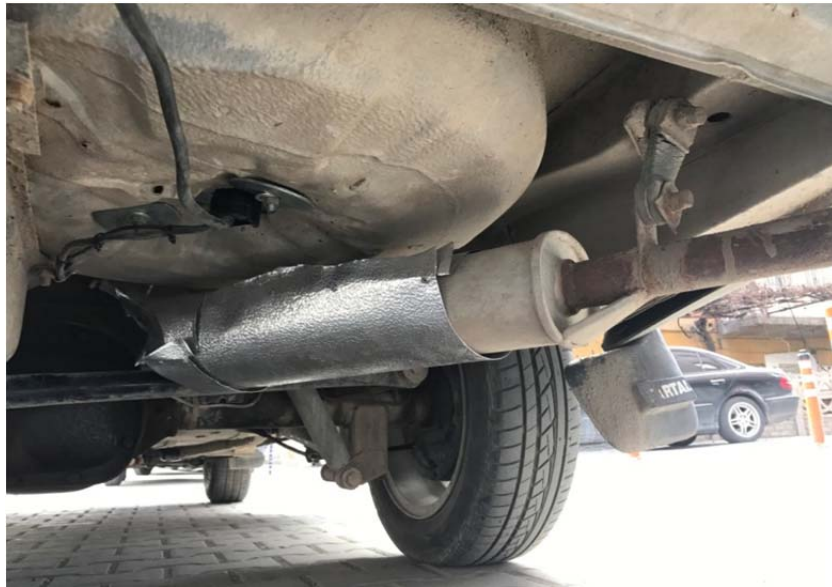
Şekil 4.94. LPG boruları yakın olduğu için egzoz yalıtılmış uygunsuz montaj örneğı.
