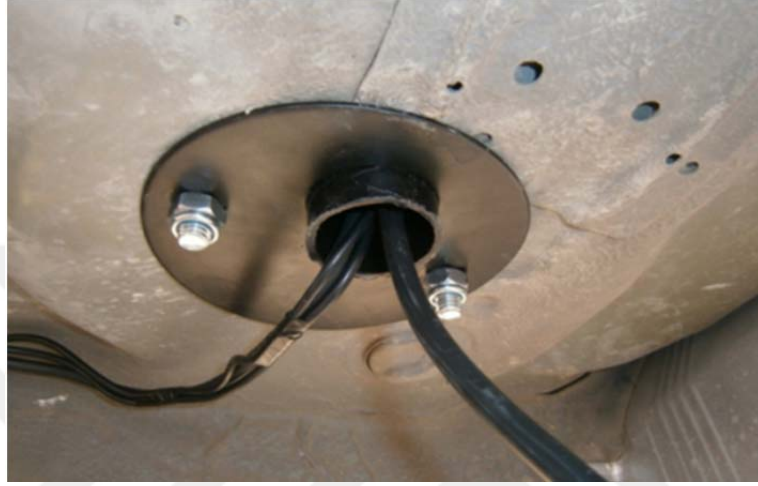
Şekil 4.106. LPG borusu geçen deliğe plastik halka koyulmuş uygun montaj örneği.
