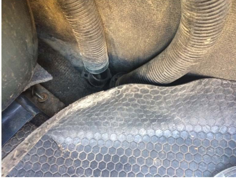
Şekil 4.77. Silindirik tank uygunsuz kelepçe takılmamış havalandırma hortumu örneği.
