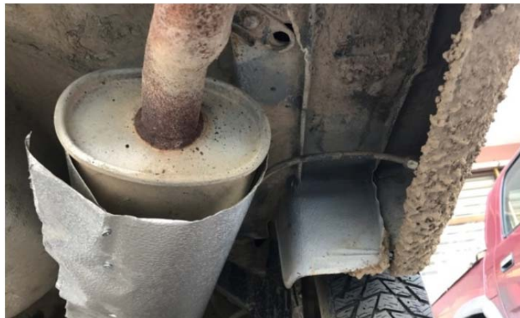
Şekil 4.92. Egzoz yalıtım malzemesiyle kapatıldığı için uygunsuz montaj örneği.
