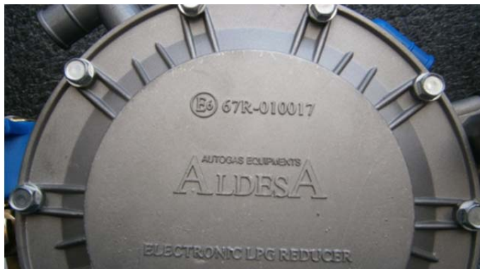
Şekil 4.116. BM/AEK R-67 regülasyonuna uygun regülatör örneği (MMO, 2017).
