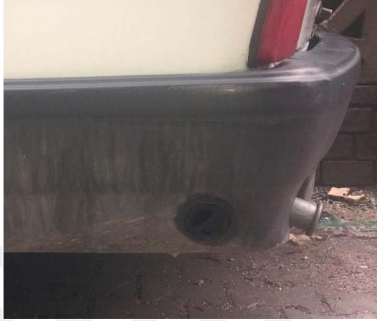
Şekil 4.6. Tampona monte edilmiş dolum ağzı örneği.
