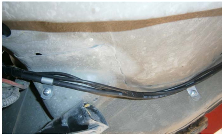
Şekil 4.105. LPG boruları taşıtın ana yapısına sağlam bağlanmış uygun montaj örneği.
