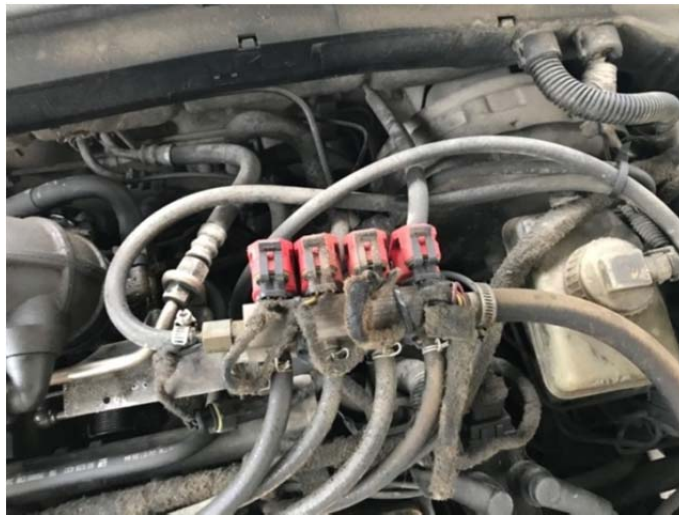
Şekil 4.14. Gaz enjeksiyon cihazı (rail) bağlantısı örneği.
