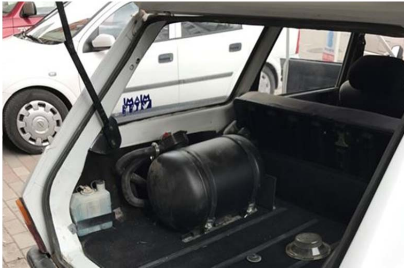
Şekil 4.44. Koltuk ile tank arası mesafenin uygunsuz olduğu tank montajı örneği.
