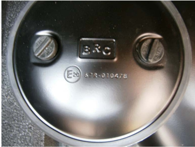
Şekil 4.70. Simit tank sızdırmaz odacık kapağı örneği (MMO, 2017).
