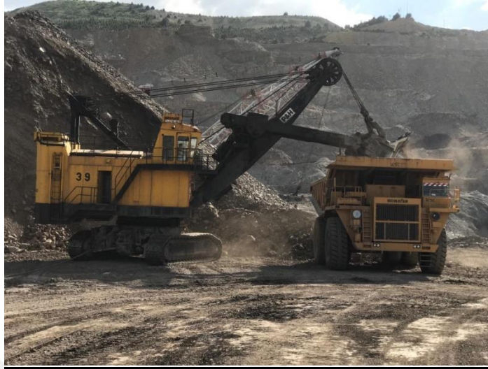
Şekil 5.2. PH 1900 AL elektrikli/halathlı ekskavator + kamyon çalışması.
