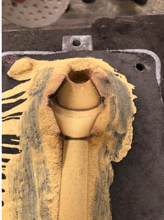
Şekil 5.76. Hazırlanan deneme kalıbının döküm yolluğu ve filtre konumu.
