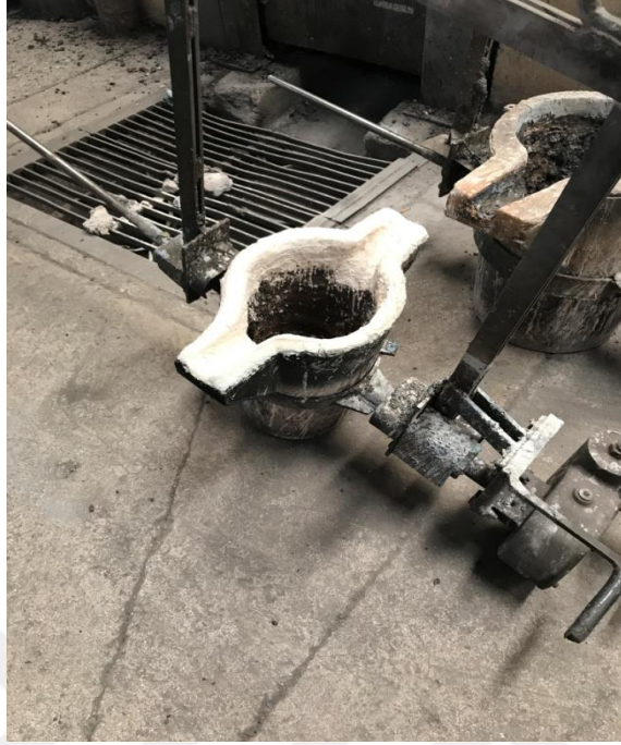
Şekil 5.77. Döküm denemesinde kullanılan metal eriyik aktarma potası.
