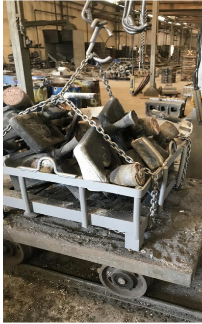
Şekil 5.82. Bilyeli temizleme makinesi ile kalıntı kumların giderilmesi.
