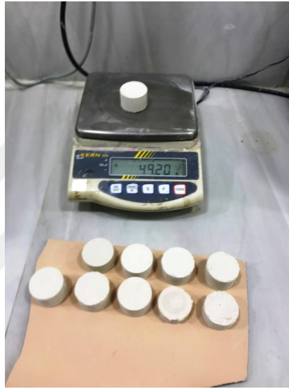
Şekil 5.15. Reçete deneme numunelerinin kızdırma kaybı hesaplamaları.
