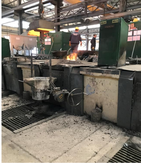
Şekil 5.78. Metal ergitme potası ve fırını.
