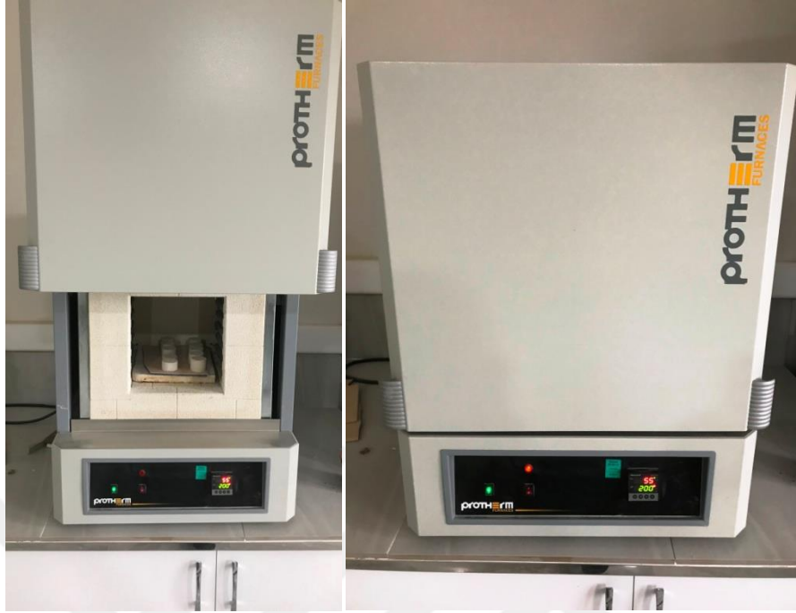
Şekil 5.16. Reçete denemelerinin sinterlenmesi.
