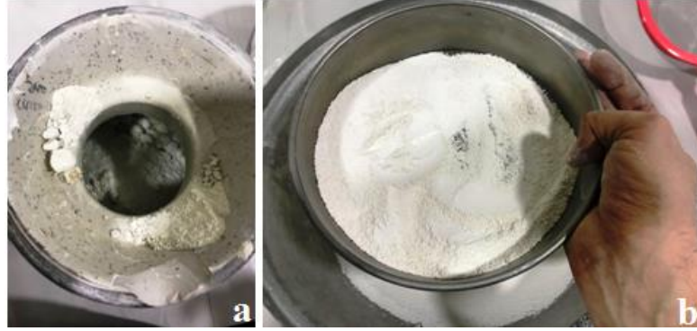
Şekil 5.13. Fırın atıklarının reçete denemeleri için hazırlanması (a: Sulu Öğütme, b: Eleme).
