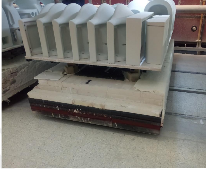
Şekil 1.4. Tünel fırın arabası (Ece Banyo Gereçleri San. ve Tic. A.Ş. üretim tesisinden görüntü).
