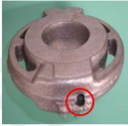
Şekil 4.7. Soğuk kapatma hatası örneği (Ingle ve Sorte, 2017).
