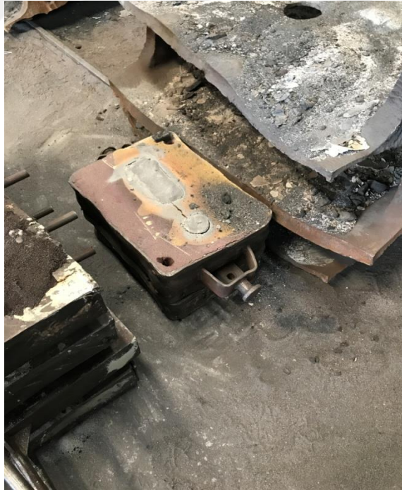
Şekil 5.80. Döküm sonrası soğumaya bırakılan deneme kalıbı.
