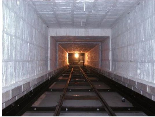
Şekil 1.2. Seramik Fırınlarda Refrakter Malzeme ile Kaplı Örnekler (https://www.keithcompany.com/).
