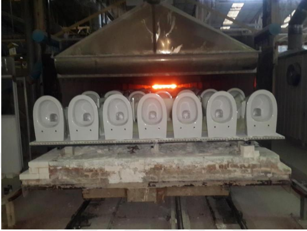
Şekil 5.7. Optimal marka sinterleme fırın (Ece Banyo Gereçleri San. ve Tic. A.Ş.).
