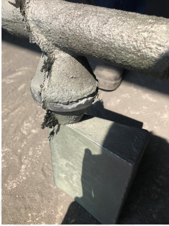
Şekil 5.83. Deneme filtresi ve metalik malzemenin döküm yoluğu ile birlikte görölmesi.
