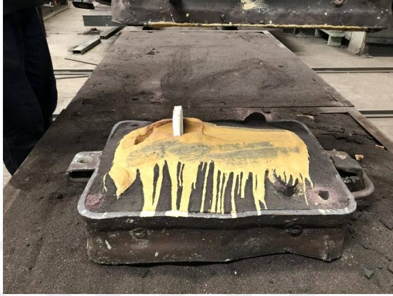
Şekil 5.75. Hazırlanan deneme kalıbı ve filtrenin kalıp içerisinde bulunduğu konum.
