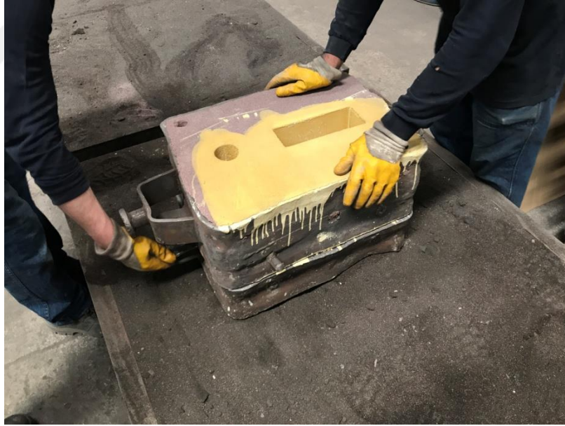
Şekil 5.74. Hazırlanan deneme kalıbının dökümden önceki kapatılmış şekli.
