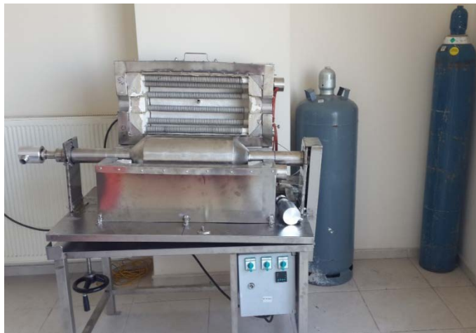
Şekil 3.7. İmalatı gerçekleştirilen ön kaplama fırını ve kullanılacak argon ve propilen gazı.
