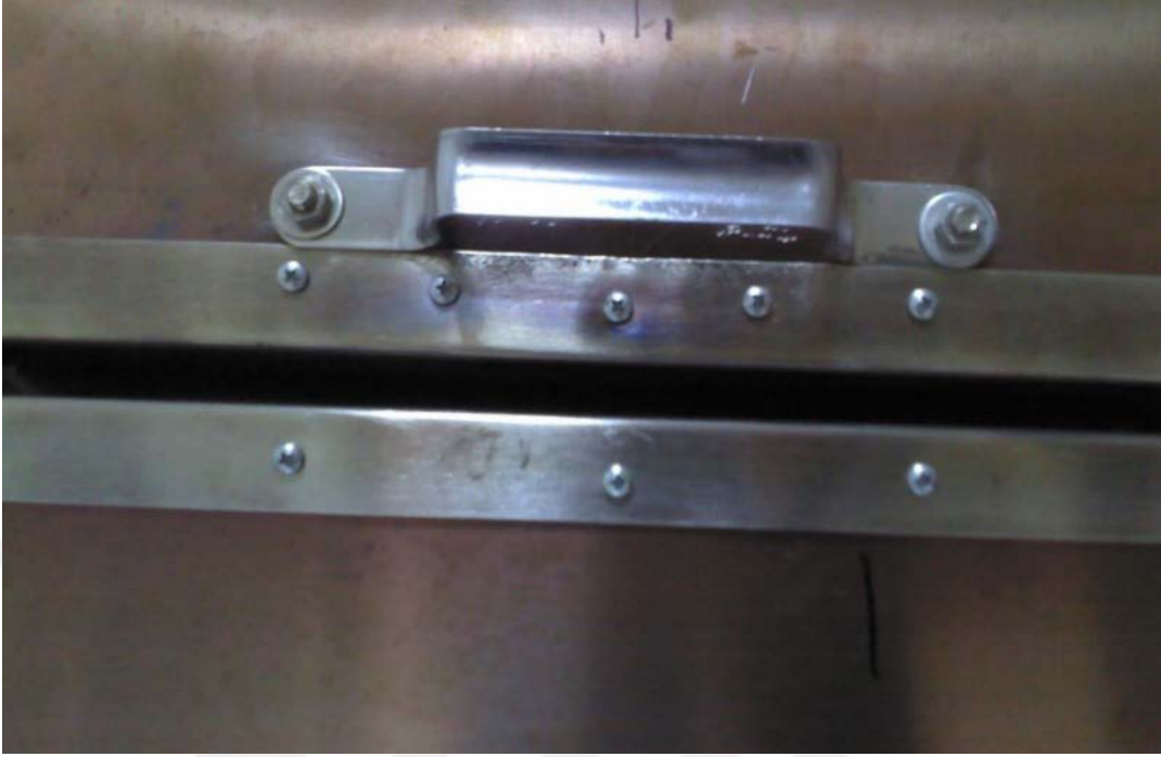
Şekil 4.9. Fırın iç sıcaklığını ölçebilmek için fırına verilen 20 mm açıklık.
