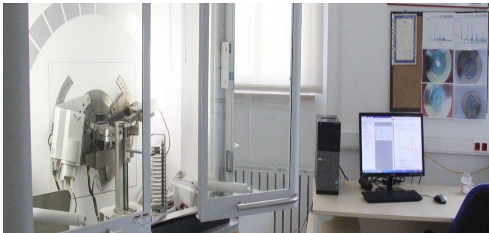
Şekil 3.8. KDPÜ İLTEM mineralojik analiz laboratuvarı, XRD cihazı (KDPÜ, 2018).
