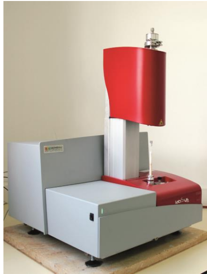
Şekil 3.16. Ölçümlerimizde kullandığımız KDPÜ İLTEM laboratuvarındaki eş zamanlı termal analiz yapabilen STA-TG/DTA cihazı (İLTEM, KDPÜ, 2018).
