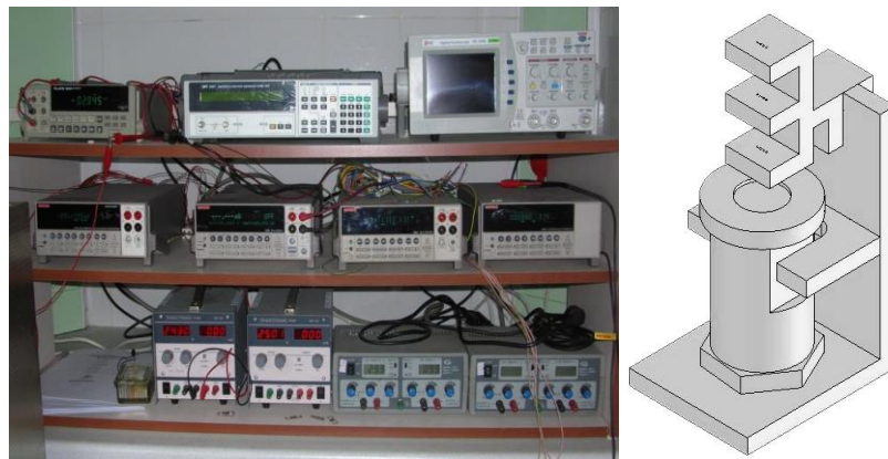
Şekil 3.20. Bilgisayar kontrollü elektriksel iletkenlik ölçüm düzeneği: a) ölçüm cihazları, b) özel tasarım alümina iletkenlik ölçüm kiti.
