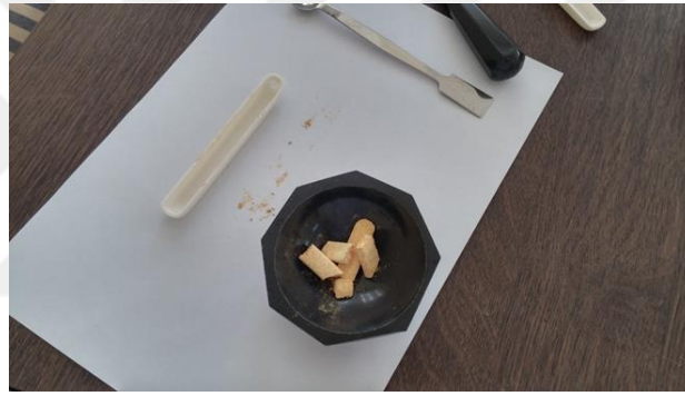
Şekil 3.22. Kül fırından çıkan krezelerin yeniden öğütüme hazırlanması.
