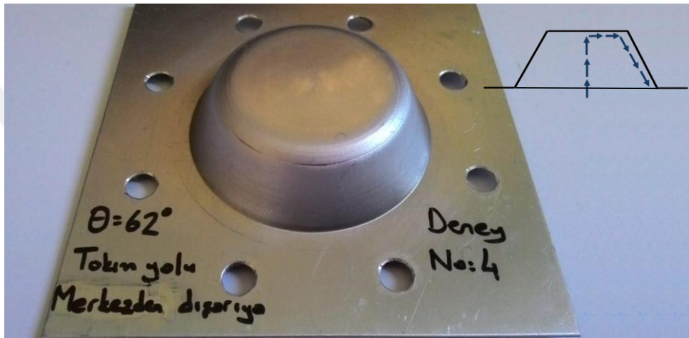
Şekil 4.10. Takım yolu merkezden dışarıya doğru verilen 4 nolu deney gösterimi.
