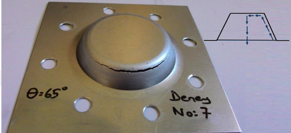
Şekil 4.11. Deney 7'nin arka yüzey görünümü 65^\circ eğim açısında yırtılması.
