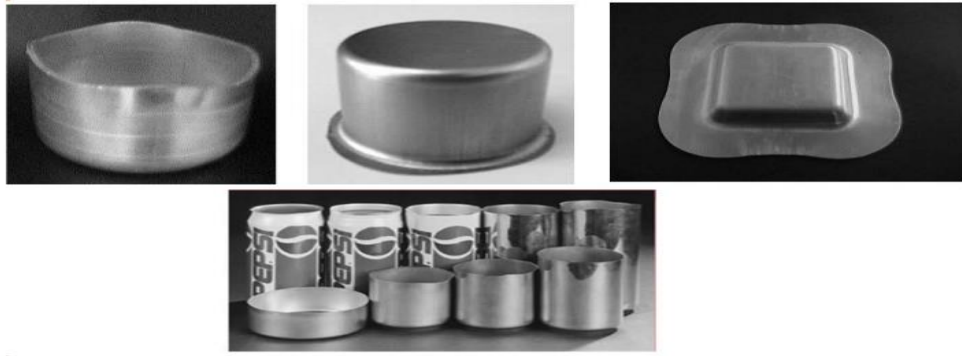
Şekil 2.2. Derin çekme yöntemiyle üretilmiş kaplar (Gavas, 2015: 163).
