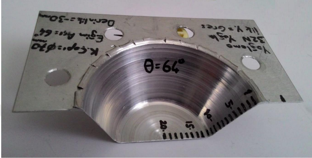
Şekil 4.22. Duvar eğim açısı 60^\circ olan deney numunesinin et kalınlığının ölçülmesi için ortadan kesilen görüntüsü.
