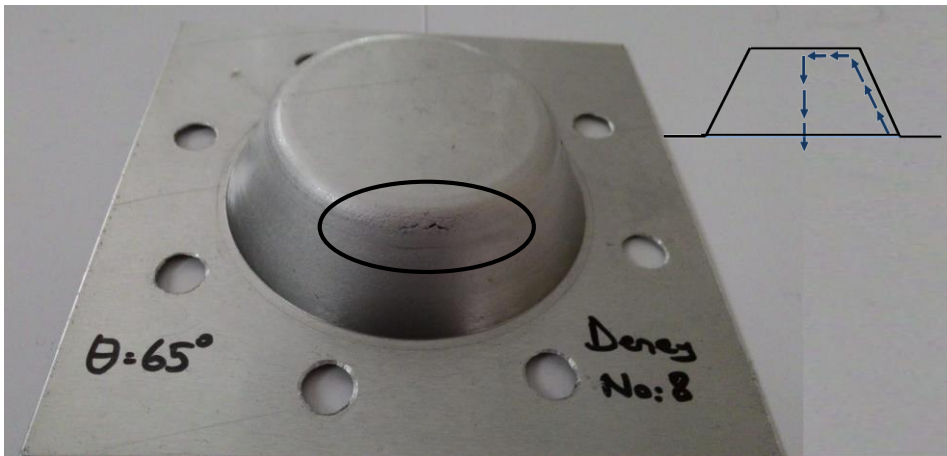
Şekil 4.12. Deney 8'in arka yüzey görünümü 65^\circ eğim açısında yırtılması.
