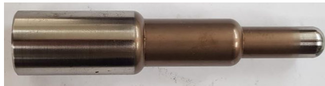
Şekil 4.3. Sertleştirilmiş kademeli küresel uçlu şekillendirme takımı.
