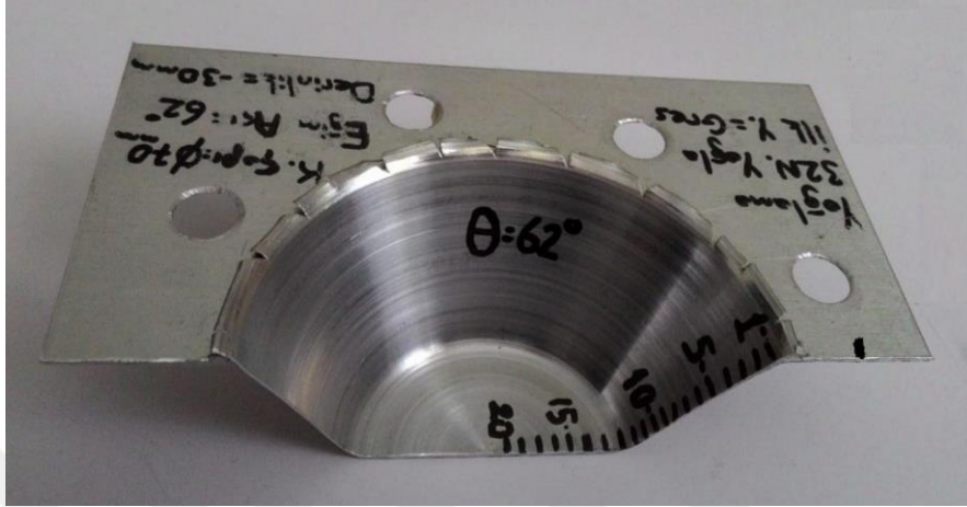
Şekil 4.20. Duvar eğim açısı 62^\circ olan deney numunesinin et kalınlığının ölçülmesi için ortadan kesilen görüntüsü.
