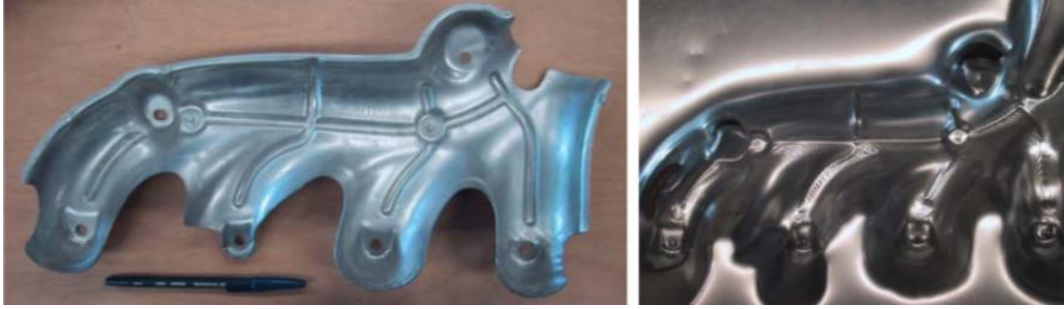
Şekil 3.7. a) Orijinal manifold ısı kalkanı, b) ISF İle üretilen ısı kalkanı (Jeswiet vb, 2005).
