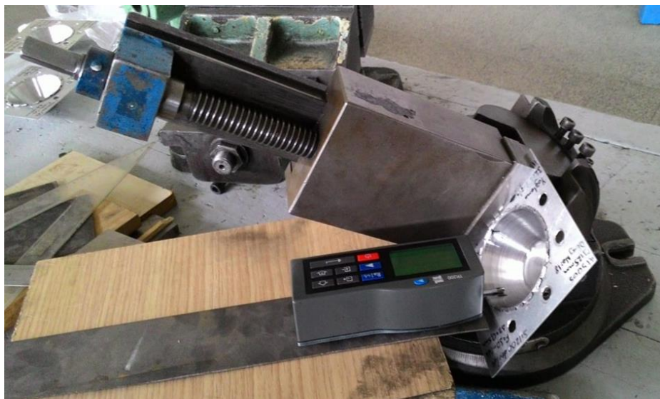
Şekil 4.26. TESCON TR-200 Yüzey pürüzlülük cihazıyla numunelerimizin R_a değerlerinin ölçümü.
