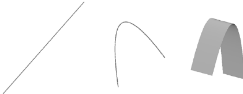
Şekil 3.2 C(s) üreteç eğrisi, \hat{C}(s) yükseltilmiş eğri ve D_{C(s)} sabit ortalama eğrilikli yüzey
