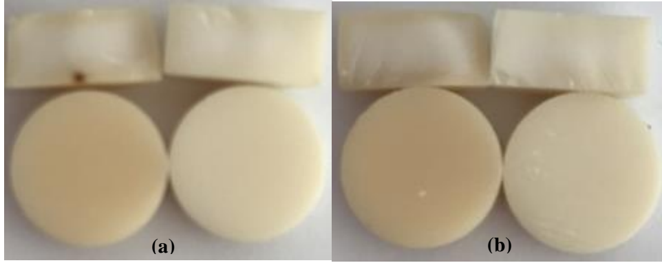
Şekil 9.2. a) R1-A solüsyonunda 15 saniye renklendirilen W kodlu pelet (soldaki) ve S kodlu pelet (sağdaki), b) R1-A solüsyonunda 60 saniye renklendirilen W kodlu pelet (soldaki) ve S kodlu pelet (sağdaki).
