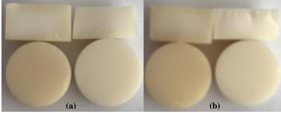
Şekil 9.11. a) R6-C solüsyonunda 15 saniye renklendirilen W kodlu pelet (soldaki) ve S kodlu pelet (sağdaki), b) R6-C solüsyonunda 60 saniye renklendirilen W kodlu pelet (soldaki) ve S kodlu pelet (sağdaki).
