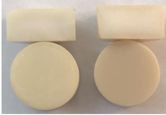
Şekil 6.2. T1 marka solüsyon ile renklendirilmiş S kodlu (soldaki) ve W kodlu (sağdaki) zirkonya desteklerin belirgin renk farklılıklarını gösteren birer prototipi.
