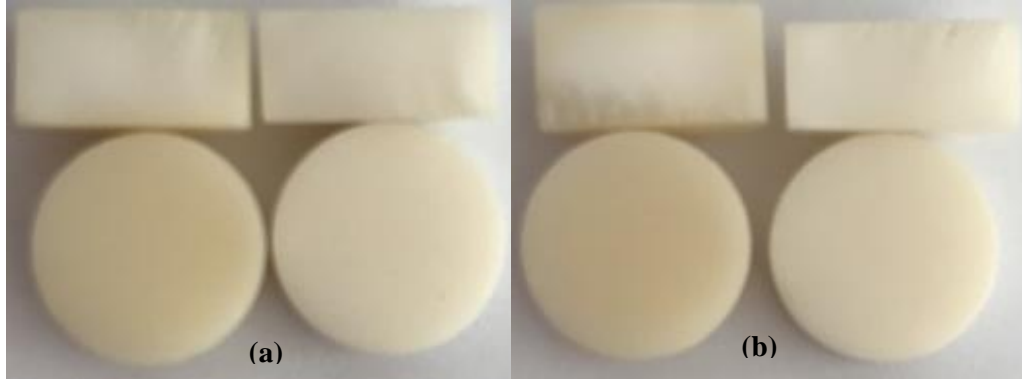
Şekil 9.9. a) R5-B solüsyonunda 15 saniye renklendirilen W kodlu pelet (soldaki) ve S kodlu pelet (sağdaki), b) R5-B solüsyonunda 60 saniye renklendirilen W kodlu pelet (soldaki) ve S kodlu pelet (sağdaki).
