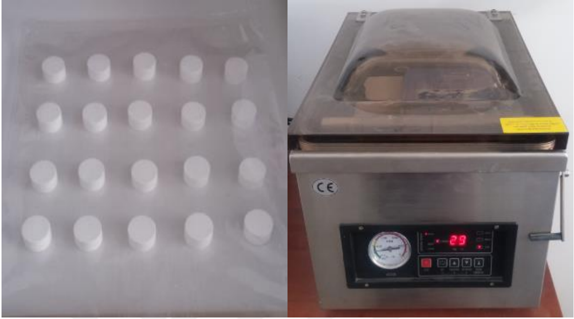
Şekil 7.3. Sol kısımda vakum poşetine alınan 2,25 gramlık peletler ve sağ kısımda ise vakum cihazı görülmektedir.
