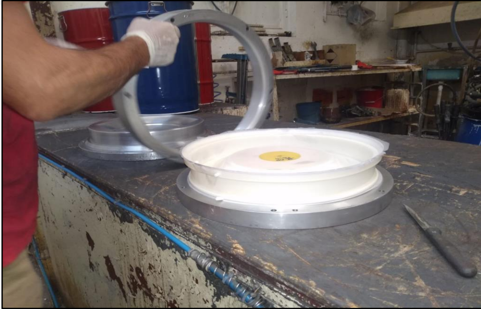
Şekil 4.3. Isostatik pres kalıbının membran üretimi.
