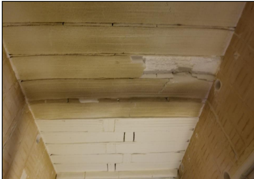
Şekil 7.5. Fırın içi yıpranmış izolasyon görüntüsü.
