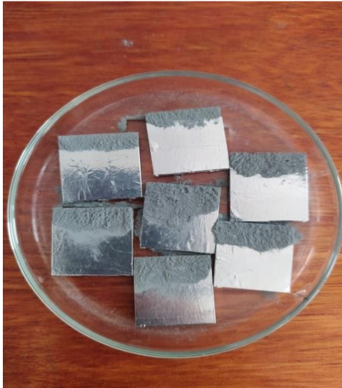
Şekil 8.2. FTO tabakanın aşındırılma işlemi.
