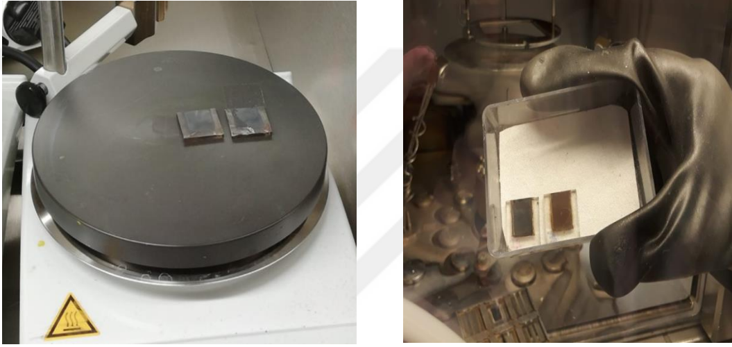
Şekil 8.9. Perovskit tabaka üretimi.
