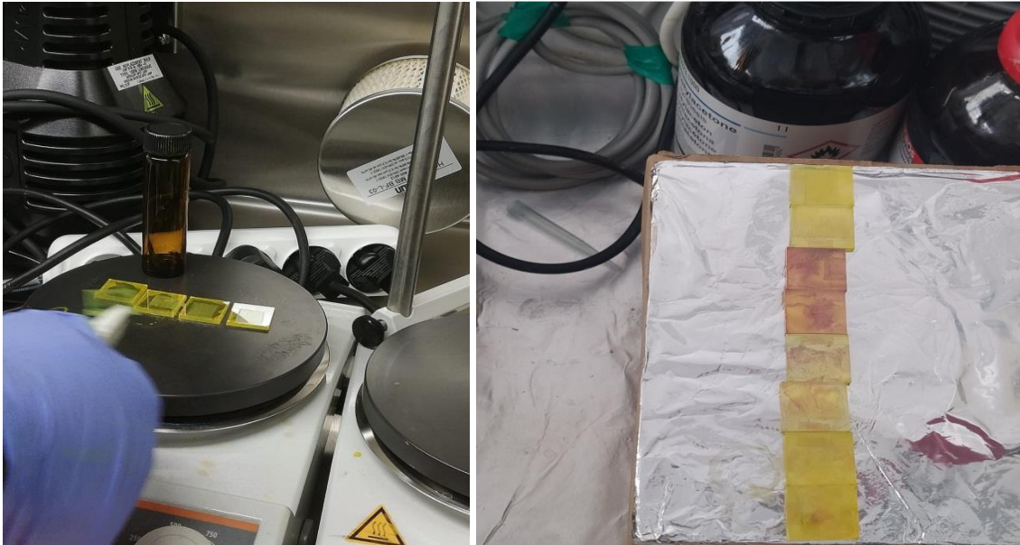
Şekil 8.8. TiO 2 tabaka üzerine PbI 2 kaplama ve tavlama işlemi.
