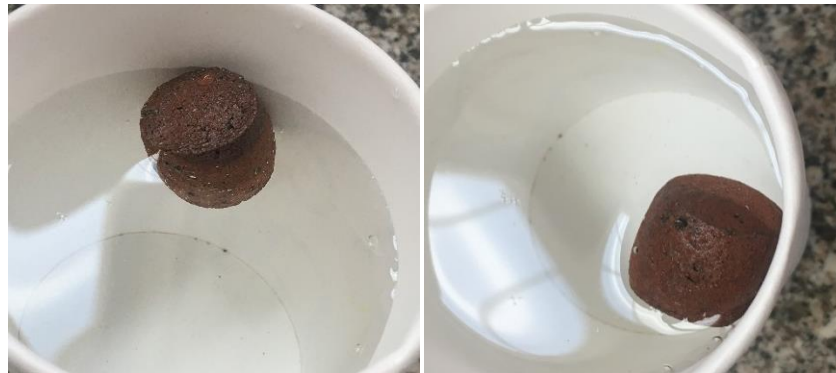
Şekil 5.10. Birim hacim ağırlığı oldukça düşük olan UK serisi numuneleri.
