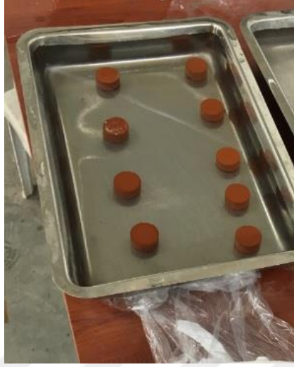
Şekil 5.8. 920°C’de pişirilen HA serisi numunelerinin 24 saat suda bekletilme görüntüsü.
