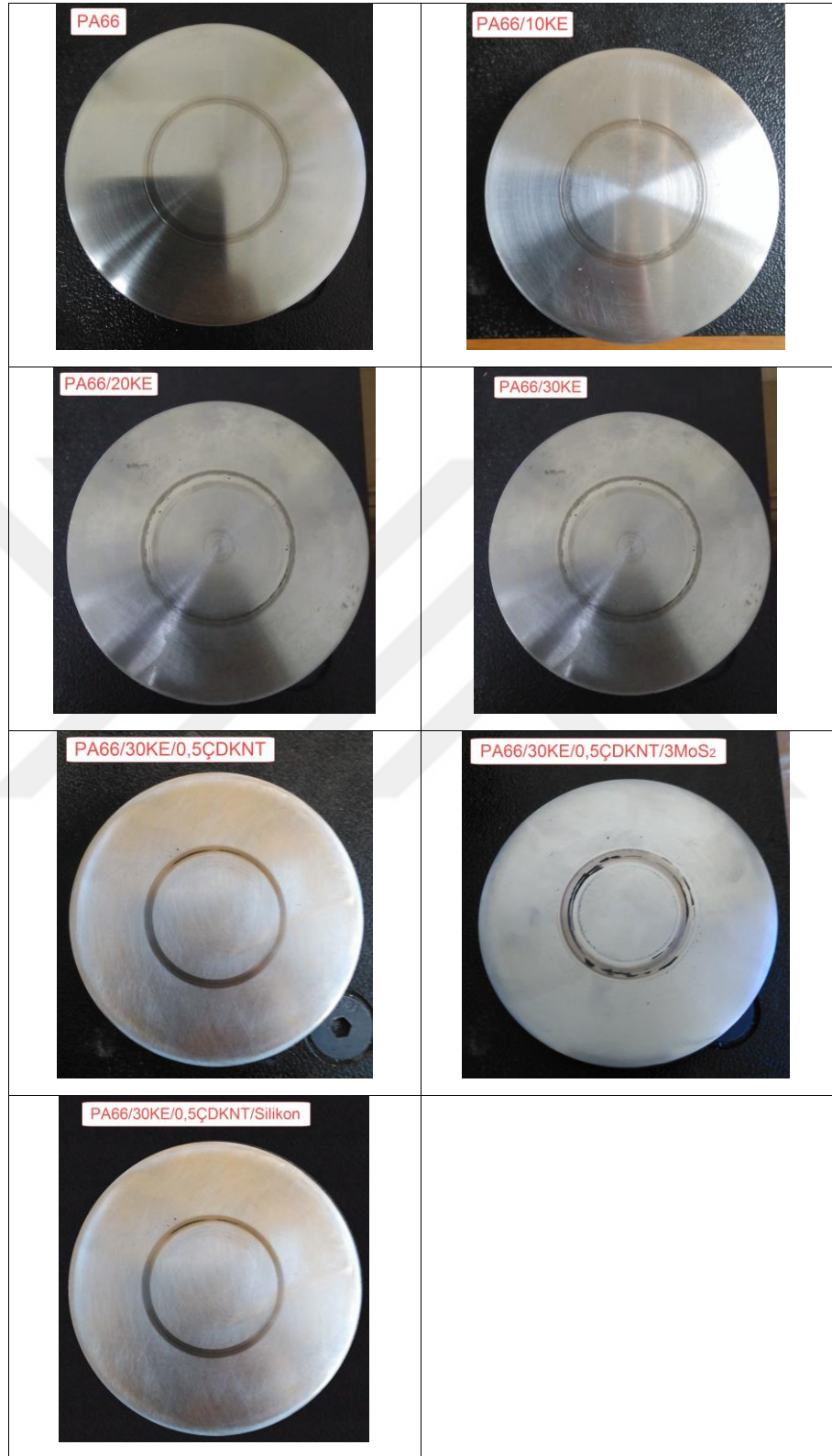
Şekil 5.24. PA66 polimeri ve PA66 kompozit numunelerinin aşınma deneyi disk incelemeleri (kayma hızı: 0,4 m/s ve yük: 40 N).
