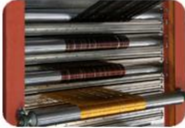
Şekil 3.5. Stabilizasyon esnasındaki renk değişimi (Zoltek, 2019).
