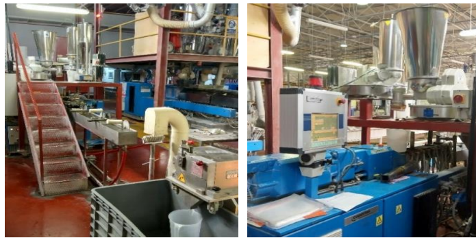
Şekil 4.1. PA66 kompozit numunelerin üretildiği ekstrüder cihazı.
