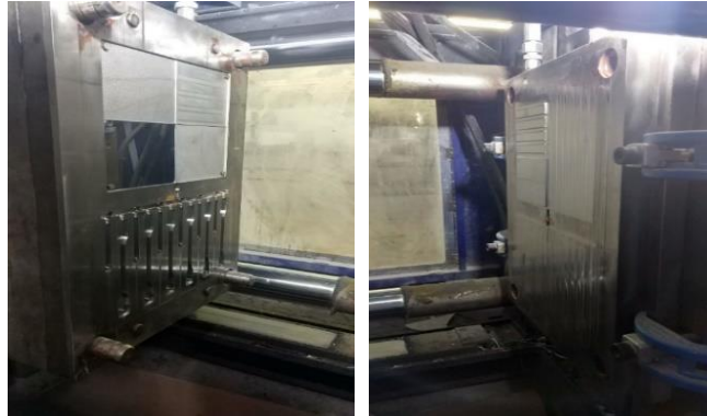
Şekil 4.3. Çekme ve darbe test çubuklarının üretildiği plastik enjeksiyon kalıbı.
