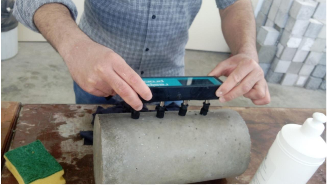
Şekil 3.1. Wenner yöntemi ile elektriksel direnç ölçümü.
