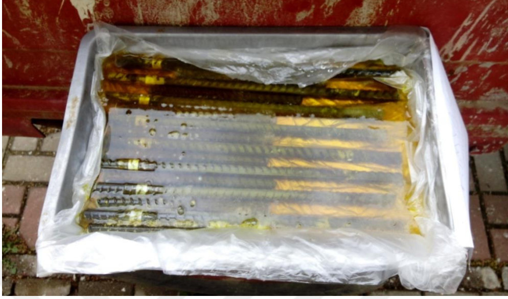
Şekil 5.20. Clarke çözeltisi ile korozyon ürünlerinin temizlenmesi.
