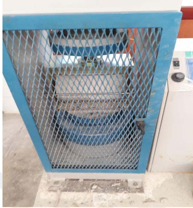
Şekil 4.8. Beton numunenin yarmada çekme deneyi.
