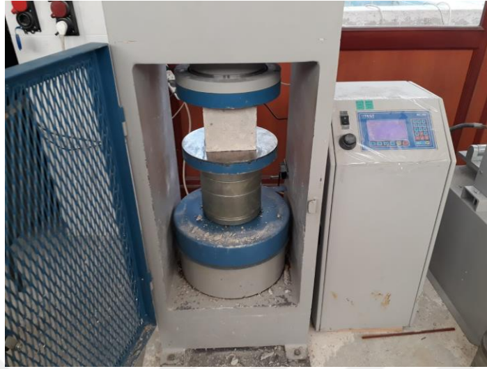
Şekil 4.7. Beton numunenin basınç deneyi.
