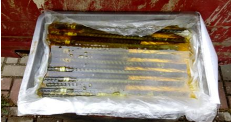
Şekil 5.18. HCl çözeltisi ile korozyon ürünlerinin temizlenmesi.
