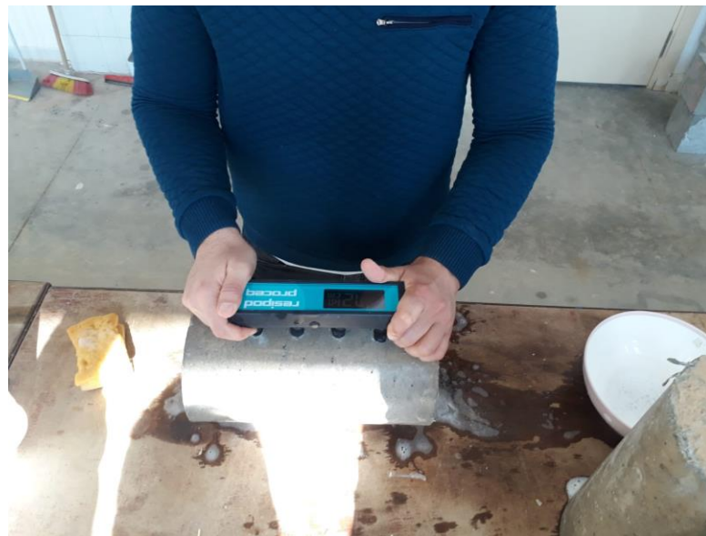
Şekil 4.12. Elektriksel özdirenç deneyi.
