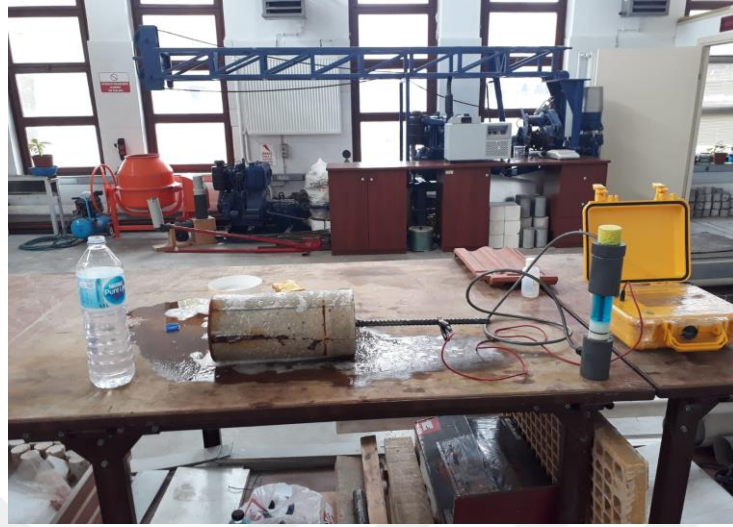
Şekil 4.11. Yarı hücre potansiyel deneyi.
