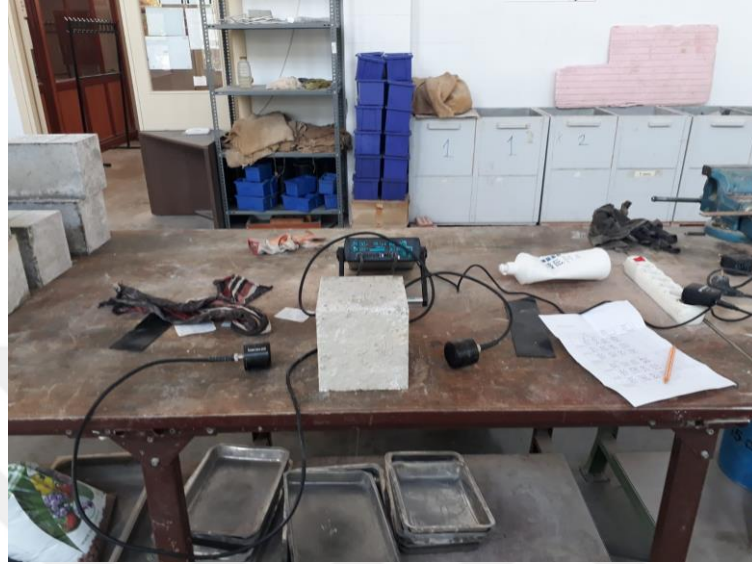
Şekil 4.5. Beton numunenin ultrases geçiş süresi deneyi.
