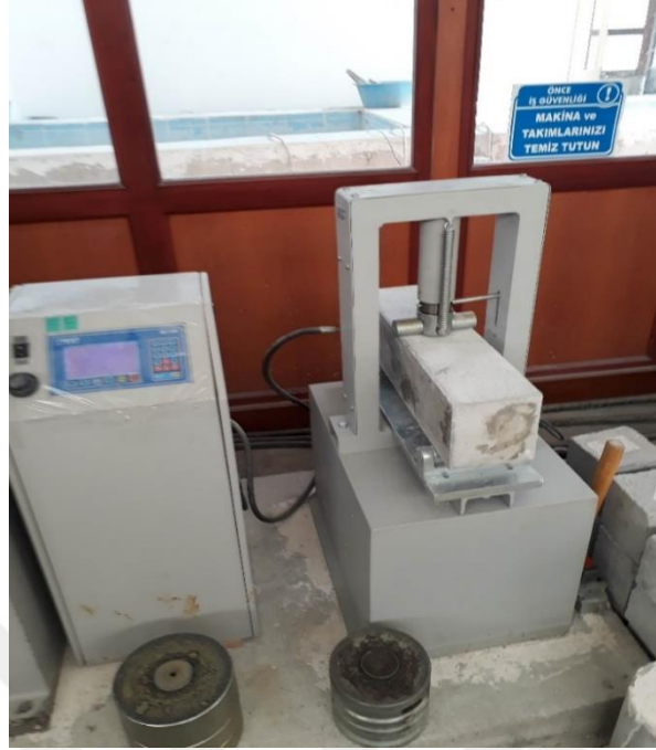
Şekil 4.9: Beton numunenin eğilmede çekme deneyi.
