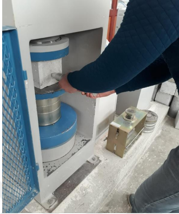
Şekil 4.6. Beton numunenin yüzey sertliği deneyi.
