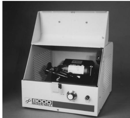
Şekil 4.2. Spex 8000D Mikser değirmen (Kahrizsangi vd., 2014).
