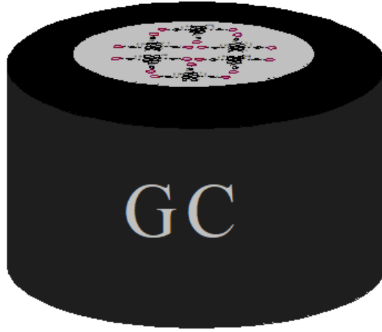
Şekil 3.5. AuNP-GNR/GC elektrotun şematik gösterimi.
