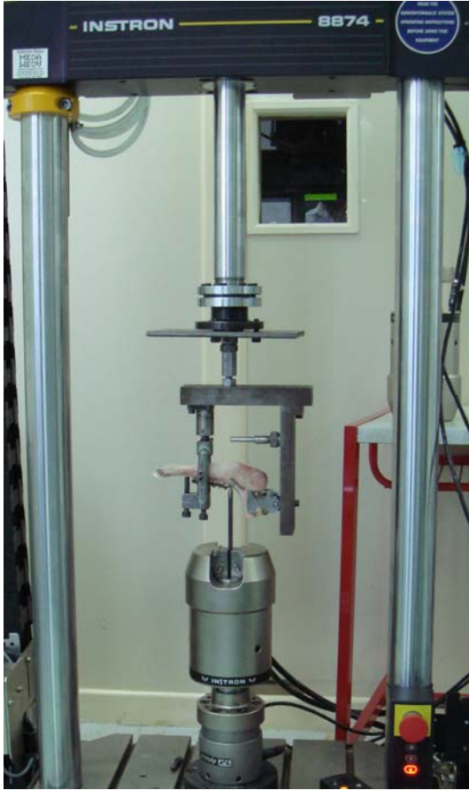
Şekil 3.5. Fiksasyon aygıtıyla beraber servohidrolik test cihazına yerleştirilmiş model.
