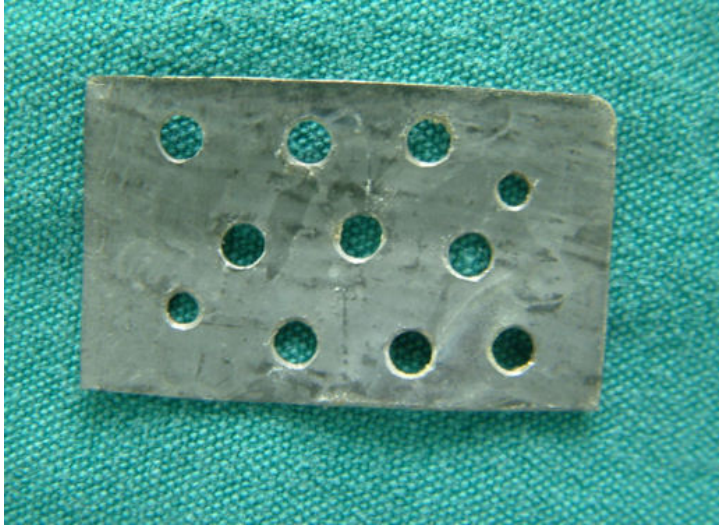
Resim 5: Standardizasyonu sağlamak için hazırlanan ve üzerinde hem perforasyon hem de fiksasyon delikleri bulunan rehber plak
