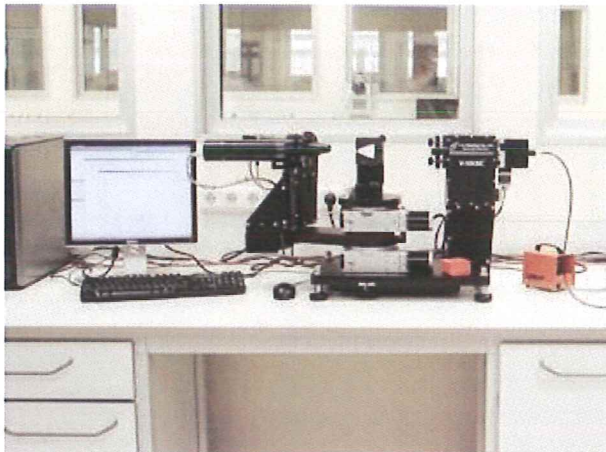
Şekil 3.7: Elipsometre cihazı ( V-VASE Ellipsometer, J. A. Woollam Co., U.S.A.)
