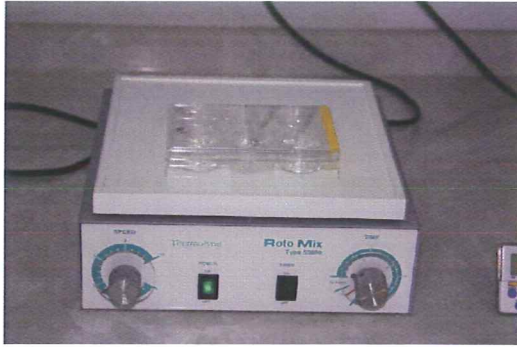
Şekil 3.12: Örneklerin rotator üzerinde etüvlenmesi ( Thermolyne, Rotomix, Type 50800, Iowa, U.S.A. )
