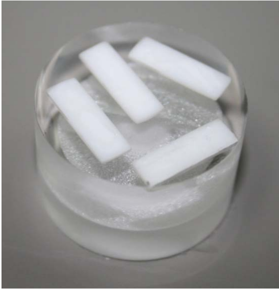
Şekil 3.5: Örneklerin akrilik resin içine gömülmesi
