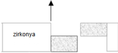
Şekil 3.19: İki yüzeyi içeren koheziv başarısızlık
