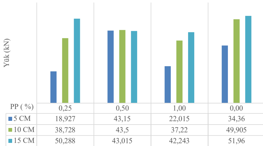
Şekil 3.14 K1 beton numunelerinin pull-out deneyindeki en büyük yük değerleri
