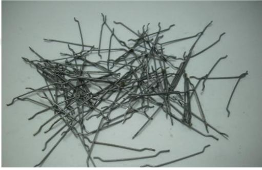
Şekil 2.7. İki Ucu çengelli lif (Tip 3).
