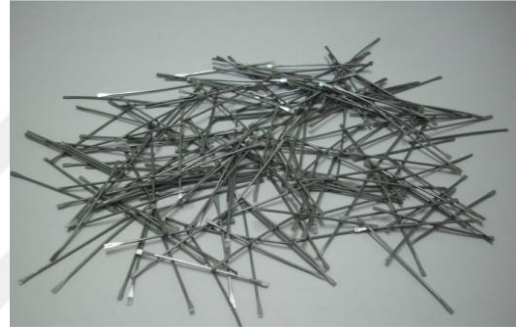
Şekil 2.6. Düz ve kancalı uçlu lif (Tip 4).
