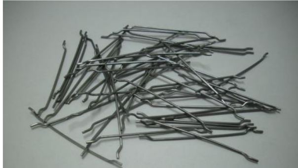
Şekil 3.1. Kullanılan çelik lifin resmi
