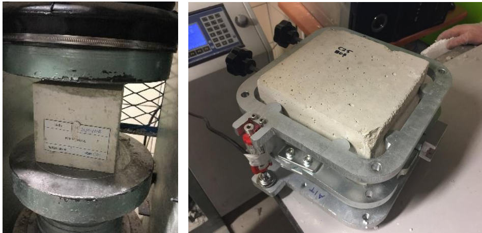
Şekil 3.20. Basınç dayanımında numunenin hazırlanışı.
