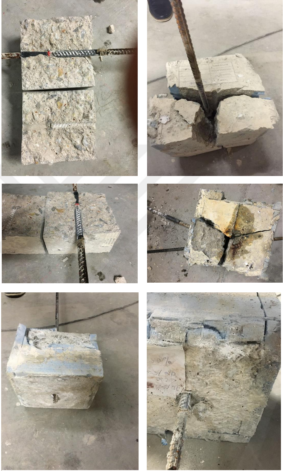
Şekil 3.22. Çekip çıkarma deneyleri sonrası numunenin nihai görünümü.
