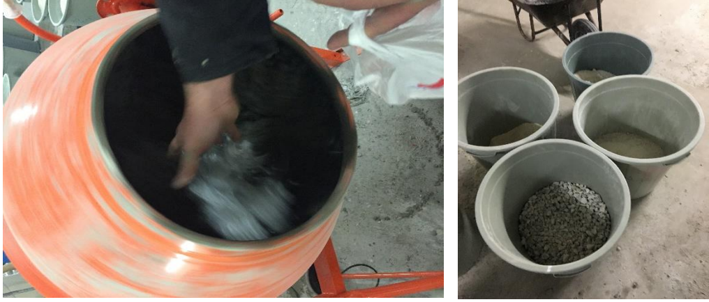
Şekil 3.6. Betoniyer ve farklı eleklerden geçirilmiş agregaların görünümü
