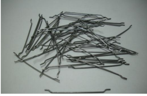
Şekil 2.4. Kancalı uçlu lif (Tip 1).
