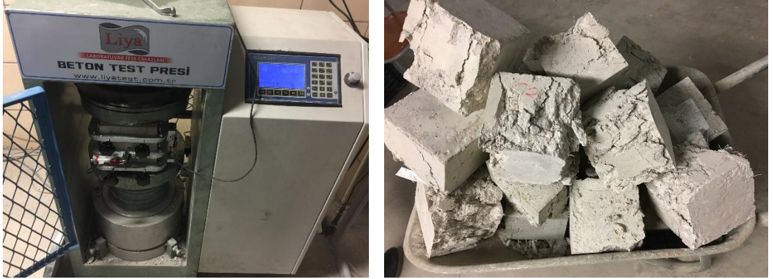
Şekil 3.21. Beton basınç makinesi
