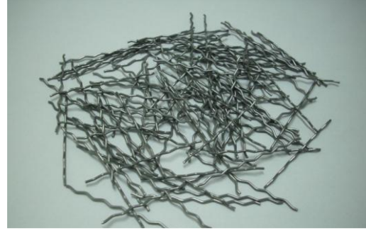
Şekil 2.5. Dalgalı lif (Tip 2).
