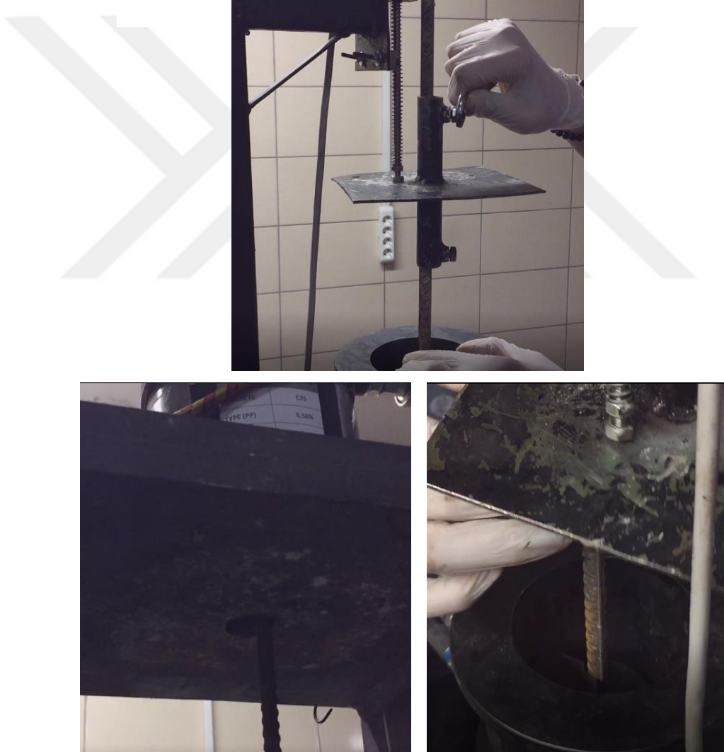
Şekil 3.18. Yukarıdaki üçlü görünüm; Numunenin sabitleme işlemi yapılırken görünümü
