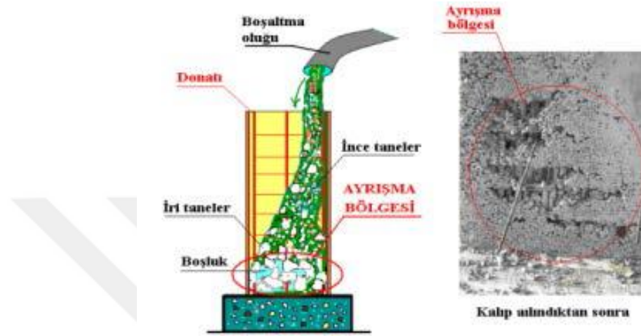
Şekil 2.6.3. Taze betonun ayrışması (segregasyon) (Megep, 2006)
