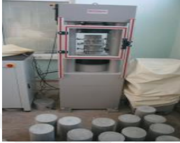
Őekil 2.6.6. Hidrolik pres aletinde beton numunenin kırılması
