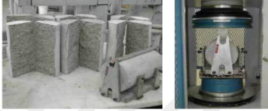
Şekil 2.6.5. Yarmada çekme dayanım deneyi (Ün, 2007)
