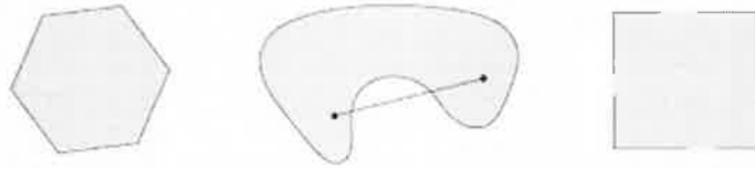
Şekil 3.1: Bazı basit konveks ve konveks olmayan kümeler gösterilmiştir. Altıgen, konvektir. Orta şekildeki küme konveks değildir, çünkü iki nokta arasındaki çizgi parçası kümenin dışında kalmaktadır. Kare şeklinde olan bazı sınır noktaları içerir diğerlerini içermez bu yüzden konveks değildir [18].
